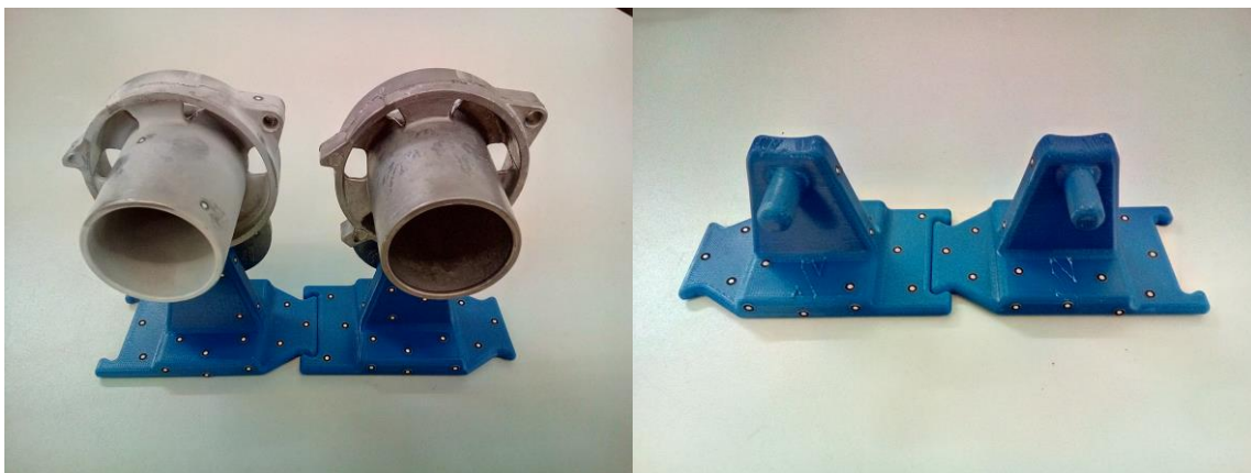
Slika 60 Primjer držača objekta pripremljenog za 3D skeniranje
