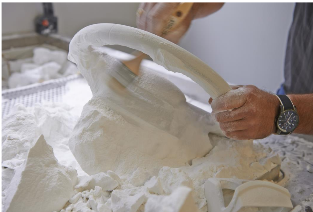
Slika 25 Model dobiven SLS postupkom
