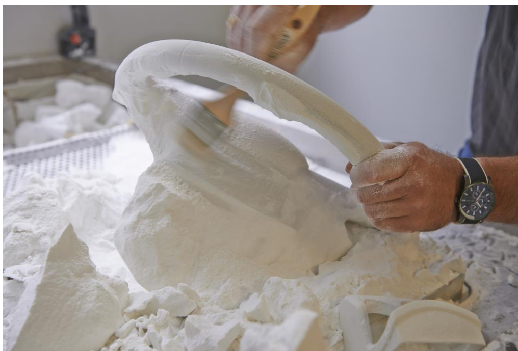
Slika 25 Model dobiven SLS postupkom
