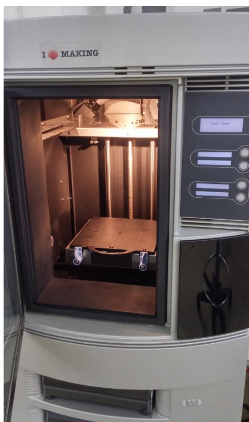
Slika 27 FDM 3D printer Dimension Elite (IZIT)
