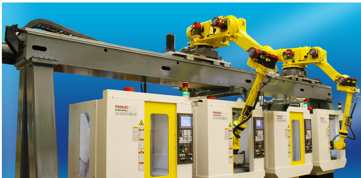
Slika 10. Roboti na linearnoj jedinici postavljeni iznad stroja
