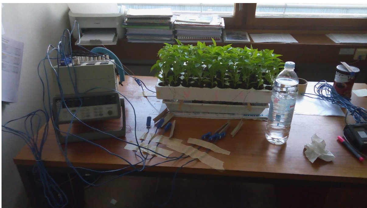
Slika 21. Postavljanje termoparova u uzorke
