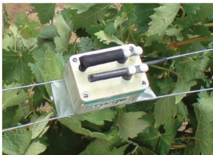
Slika 17. Evaposensor, komercijalna referentna površina[8]
