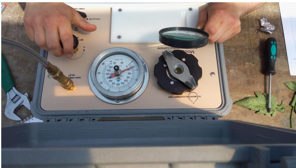
**Slika 38. Mjerna linija za vodni potencijal lista**
