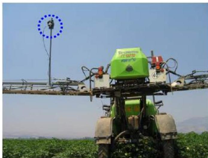
Slika 8. Kamera postavljena na raspršivaču[5]
