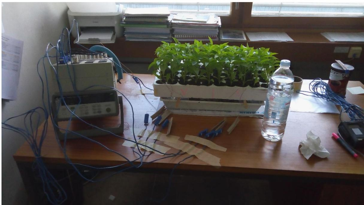
Slika 21. Postavljanje termoparova u uzorke
