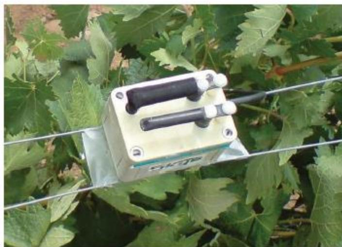
Slika 17. Evaposensor, komercijalna referentna površina[8]
