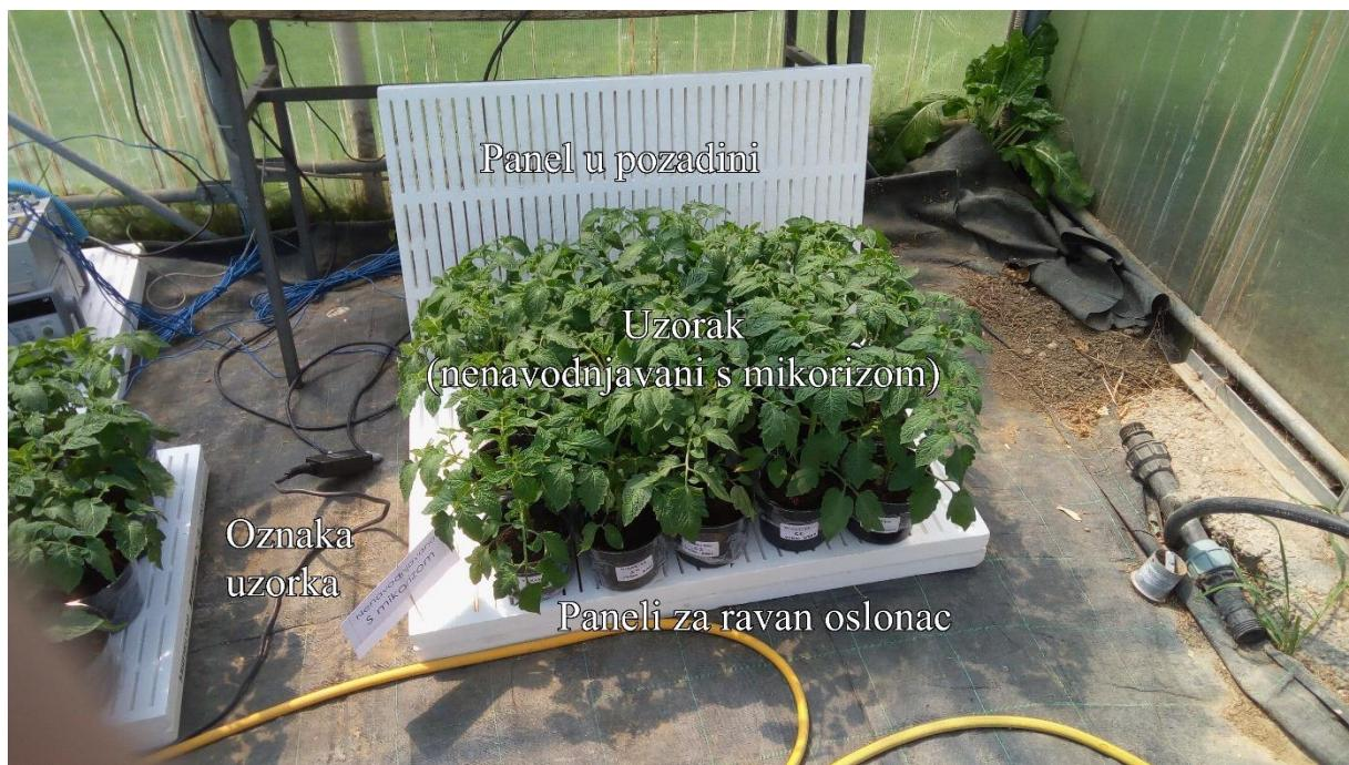
Slika 34. Prikaz jednog uzorka za mjerjenje
