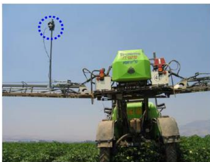
Slika 8. Kamera postavljena na raspršivaču[5]
