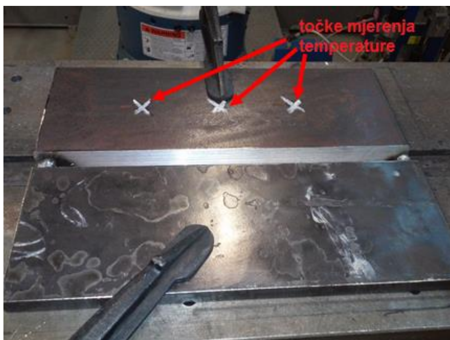
Slika 35. Spoj 1 pripremljen za zavarivanje
