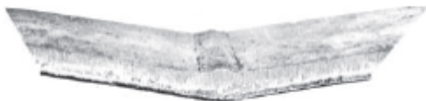
Slika 7. Sučeljeni „V“ zavar 2 [7]
