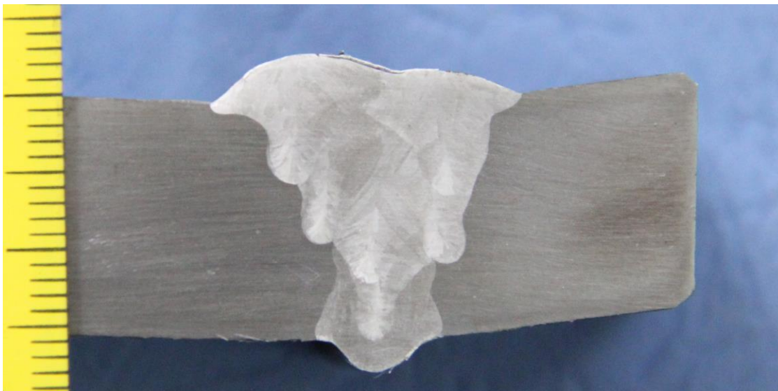
Slika 51. Makroizbrusak 2 ( Lincoln MIG 309LSi dodatni materijal)
