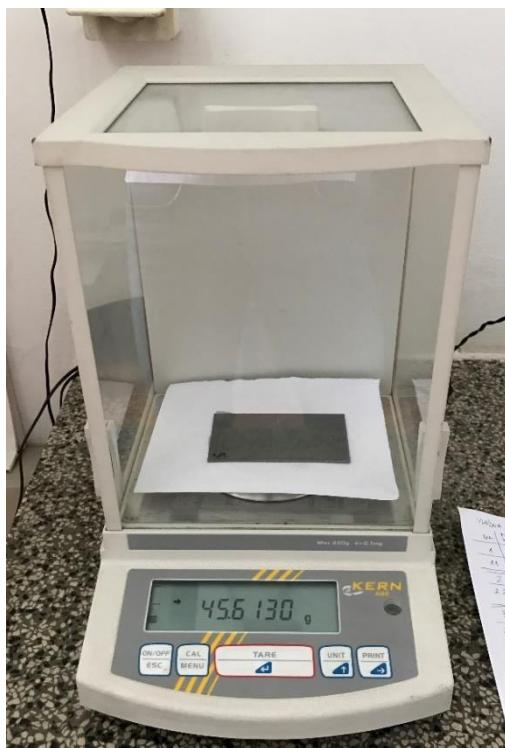
Slika 34. Uređaj za vaganje uzorka
