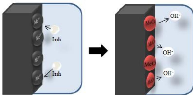
Slika 9. Mehanizam djelovanja anodnih anorganskih inhibitora [14]
