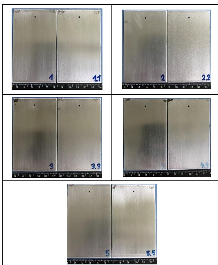
Nakon pripreme uzorka, nanošenja sredstva te sušenja uzorka 24 sata, provedeno je ispitivanje ispirljivosti. Najprije se s uzorka odstranilo sredstvo. Uzorci su stavljeni u posudu s 5 postotnom otopinom natrijeva hidroksida (NaOH). Posuda je stavljena u peć (slika 71.) na temperaturu od 45 °C.
