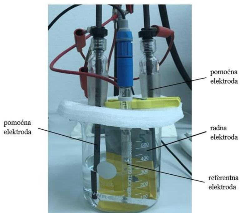
Slika 53. Ćelija za ispitivanje EIS
