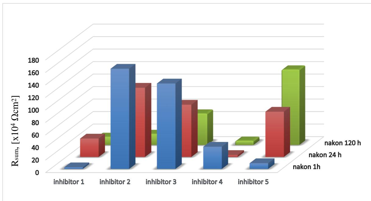
Slika 70. Histogram ukupnih otpora dobivenih EIS ispitivanjem
