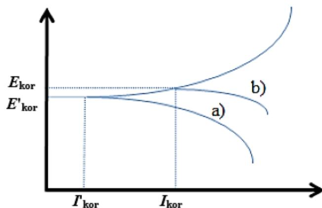
Slika 26. Potencijostatički polarizacijski dijagram: a) otopina s katodnim inhibitorom, b) otopina bez inhibitora [14]
