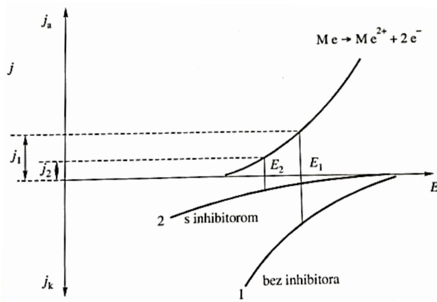
Slika 13. Djelovanje katodnih inhibitora na korozjski sustav [10]
