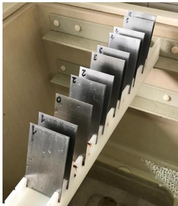
Slika 41. Način slaganja uzoraka u vlažnoj komori
