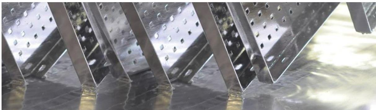
Slika 6. Zaštita metalnim prevlakama – pocinčavanje [11]
