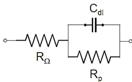
Slika 27. Električni ekvivalentni krug jednostavne elektrokemijske ćelije [24]
