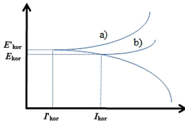
Slika 25. Potencijostatički polarizacijski dijagram: a) otopina s anodnim inhibitorom, b) otopina bez inhibitora [14]
