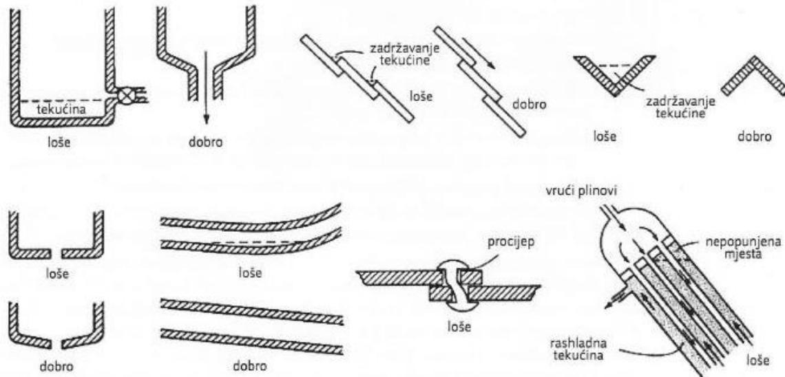
Slika 3. Primjeri utjecaja oblikovanja i montaže konstrukcije na pojavu korozije [7]
