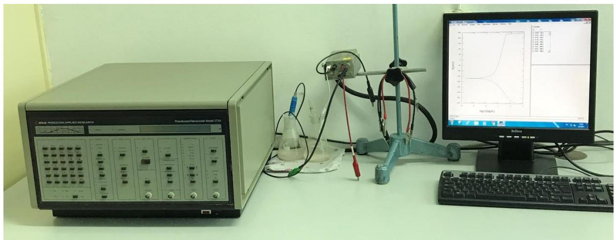
Slika 42. Oprema za ispitivanje metodom Tafelove ekstrapolacije
