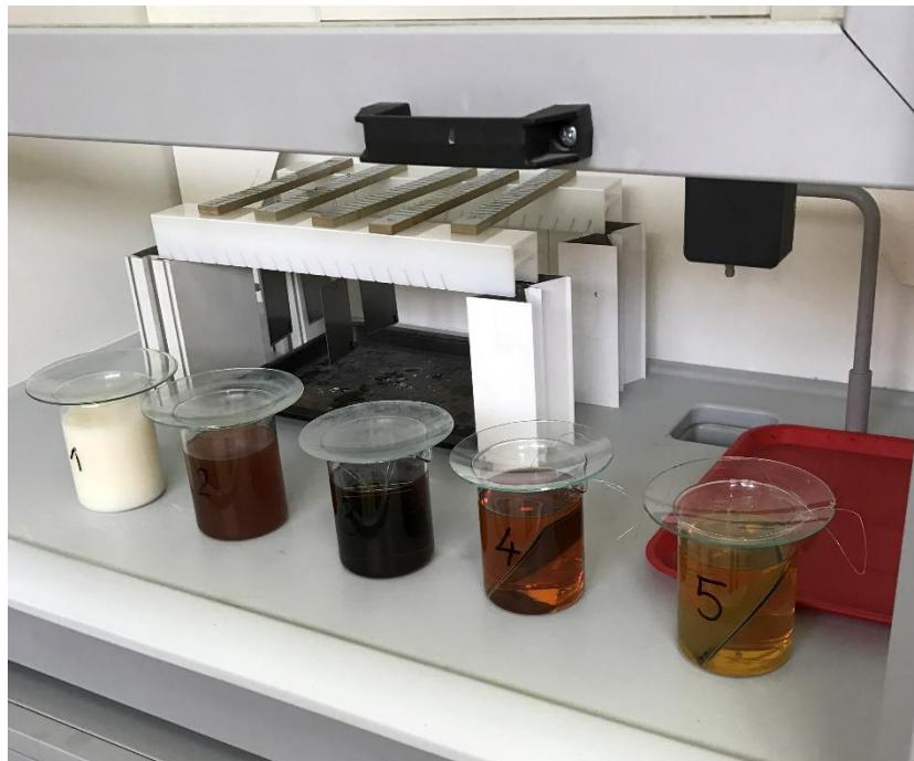
Slika 35. Postupak nanošenja inhibitora
