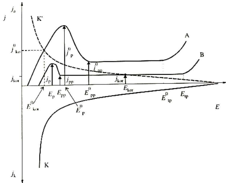
Slika 10. Utjecaj anodnog inhibitora na anodnu polarizaciju metala [10]
