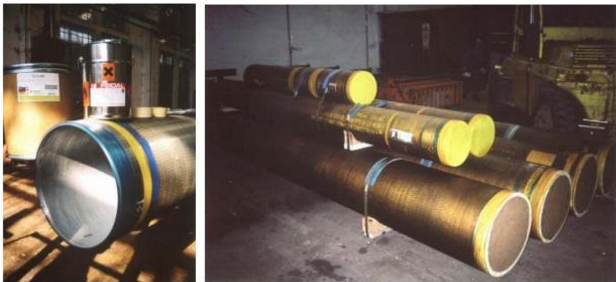
Slika 16. Zaštita unutrašnjosti cijevi inhibitorom korozije u prahu [18]
