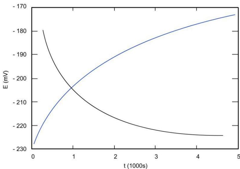
Slika 23. Određivanje potencijala otvorenog strujnog kruga  $E_{\text{ok}}$  [23]
