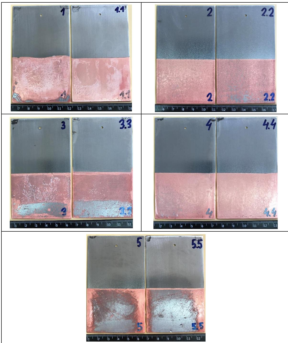
Iz tablice 31. može se zaključiti da je kod uzoraka 1, 2 i 4 došlo do ionizacije između bakra i čelika što znači da je s uzoraka potpuno odstranjen inhibitor. Kod uzorka 3 i 5 nije došlo do ionizacije po cijeloj površini uzorka, što nam govori da sredstvo za privremenu zaštitu nije u potpunosti odstranjeno s uzorka. Iz tablice se vidi da je kod uzorka 5 najlošija ispirljivost.
