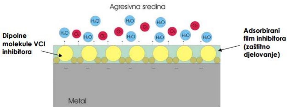
Slika 14. Mehanizam djelovanja hlapivog inhibitora korozije [7]
