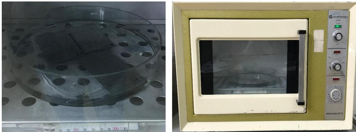
Slika 71. Peć za zagrijavanje uzorka
