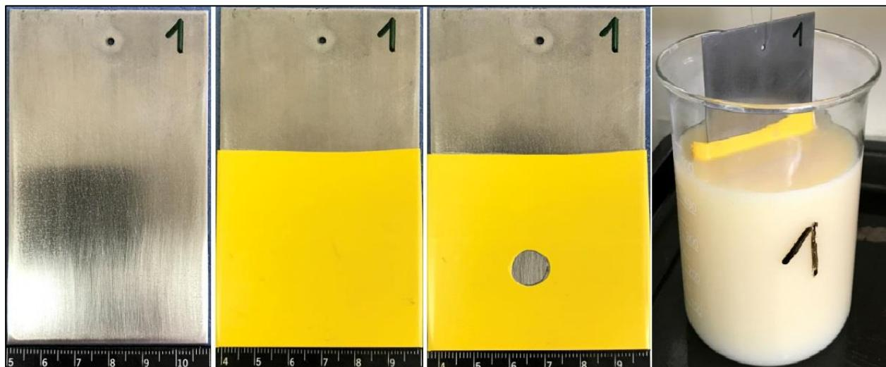
Slika 54. Postupak pripreme uzoraka za EIS ispitivanje
