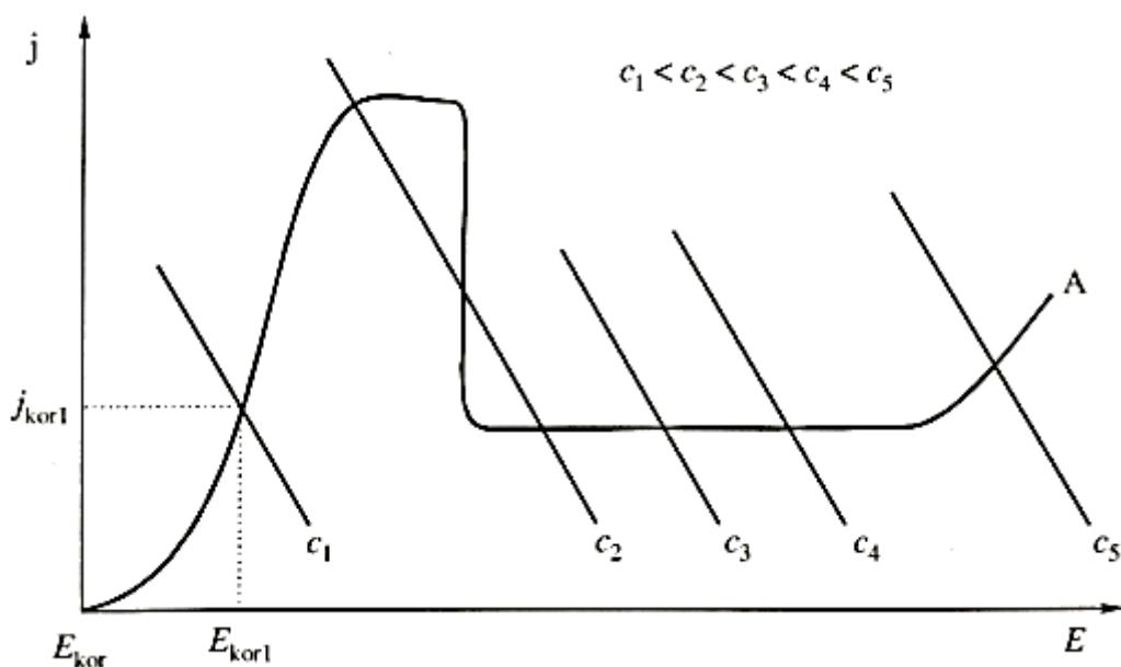
Slika 11. Utjecaj promjene koncentracije inhibitora na promjenu koroziskog sustava [10]
