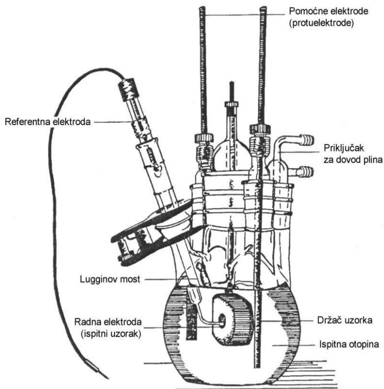
Slika 22. Elektrokemijska ćelija za korozijska ispitivanja [23]
