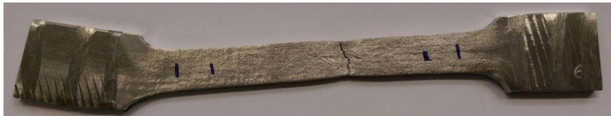
**Slika 31. Uzorak 2 nakon ispitivanja**
