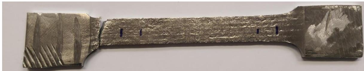
**Slika 33. Uzorak 3 nakon ispitivanja**
