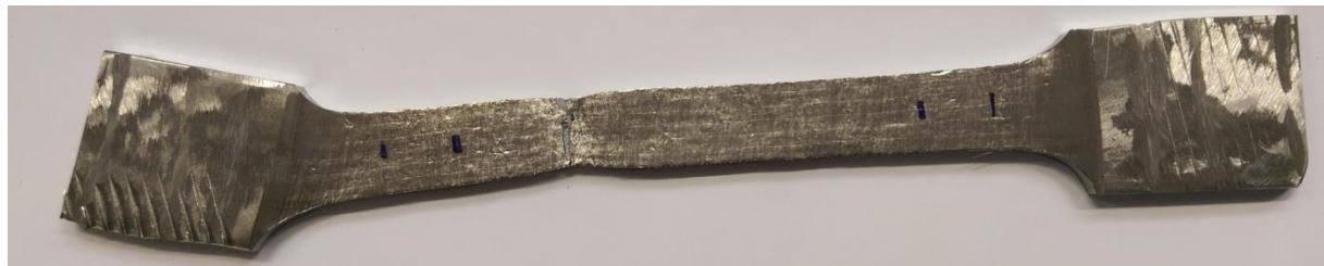
**Slika 35. Uzorak 4 nakon ispitivanja**
