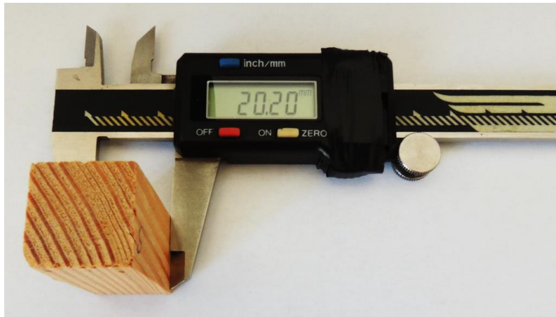
Slika 4.19. Mjerenja dimenzija uzorka za određivanje gustoće
