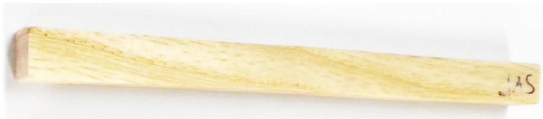
Slika 4.1. Uzorak za ispitivanje mikrostrukture i otpornosti na abrazijsko trošenje
