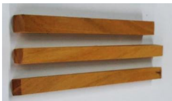
Slika 4.24. Uzorci trešnje za ispitivanje otpornosti na abrazijsko trošenje
