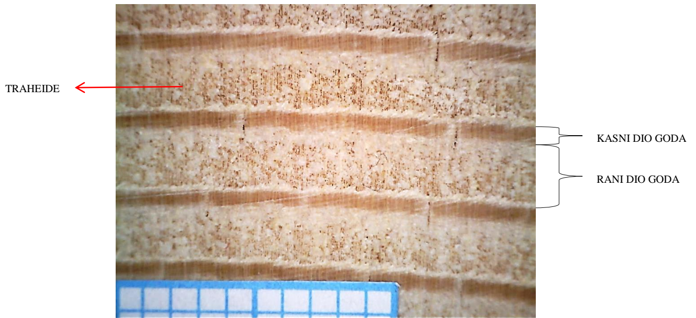
Slika 4.13. Makrostruktura poprečnog presjeka jele
