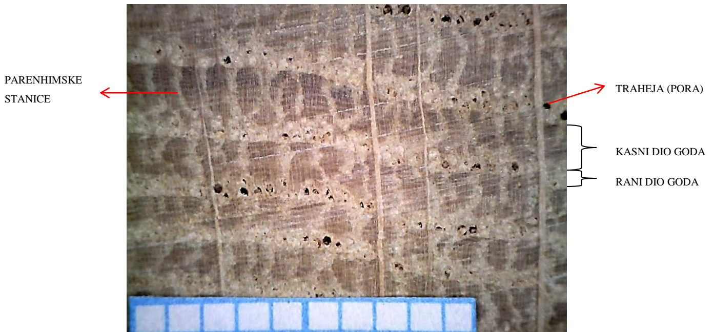
Slika 4.6. Makrostruktura poprečnog presjeka hrasta
