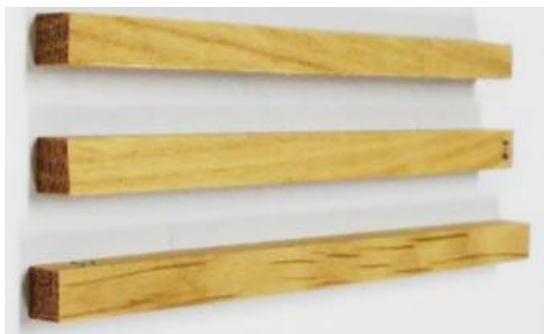
Slika 4.22. Uzorci hrasta za ispitivanje otpornosti na abrazijsko trošenje
