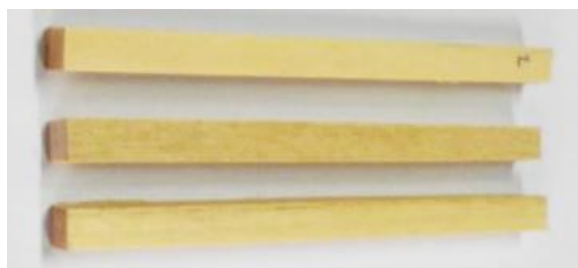
Slika 4.25. Uzorci lipe za ispitivanje otpornosti na abrazijsko trošenje
