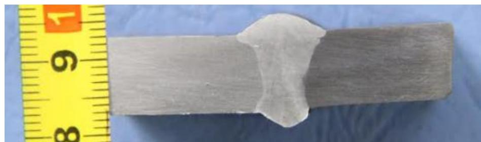
Slika 50. Makroizbrusak uzorka 2 ( $v_z = 45$  cm/min)
