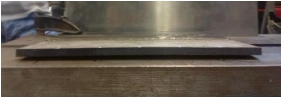
Slika 45. Deformacije drugog uzorka (bočni pogled)
