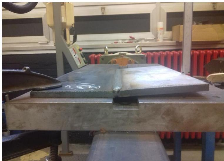
Slika 41. Mjerenje deformacija na zavarenim uzorcima
