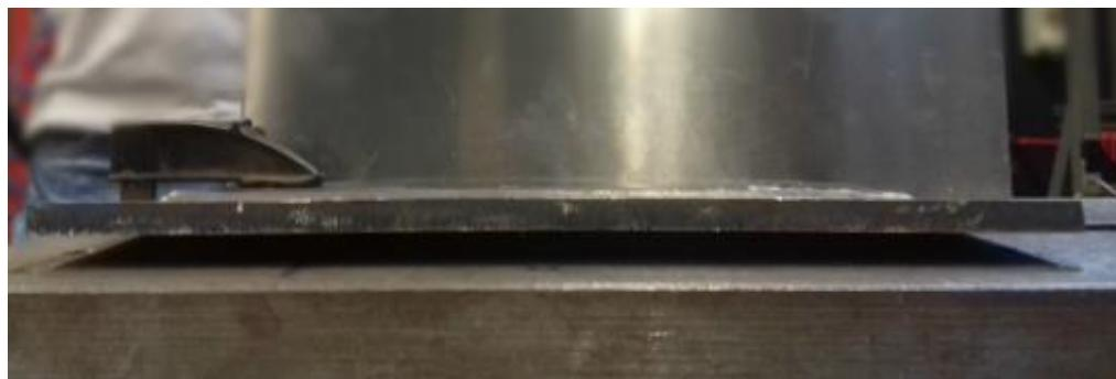
Slika 43. Deformacije prvog uzorka (bočni pogled)
