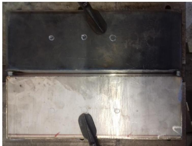
Slika 38. Uzorak 2 stegnut na radnom stolu prije zavarivanja
