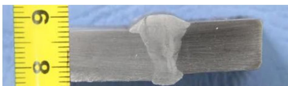
Slika 51. Makroizbrusak uzorka 3 ( $v_z = 30$  cm/min)
