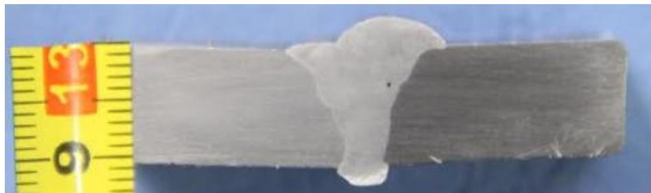
Slika 49. Makroizbrusak uzorka 1 ( $v_z = 14$  cm/min)
