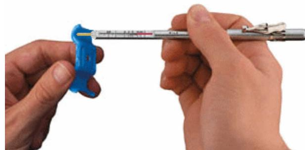
Slika 3.1. Magnetski pull-off uređaj u obliku olovke<sup>3</sup>
