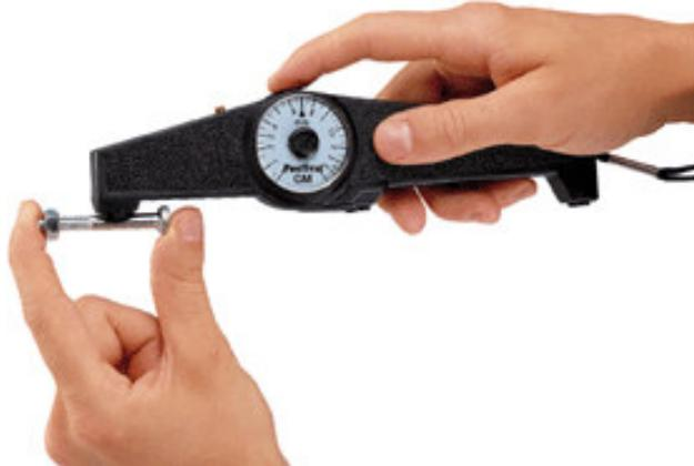
Slika 3.2. Roll-back magnetski uređaj za mjereje debljine prevlake<sup>3</sup>
