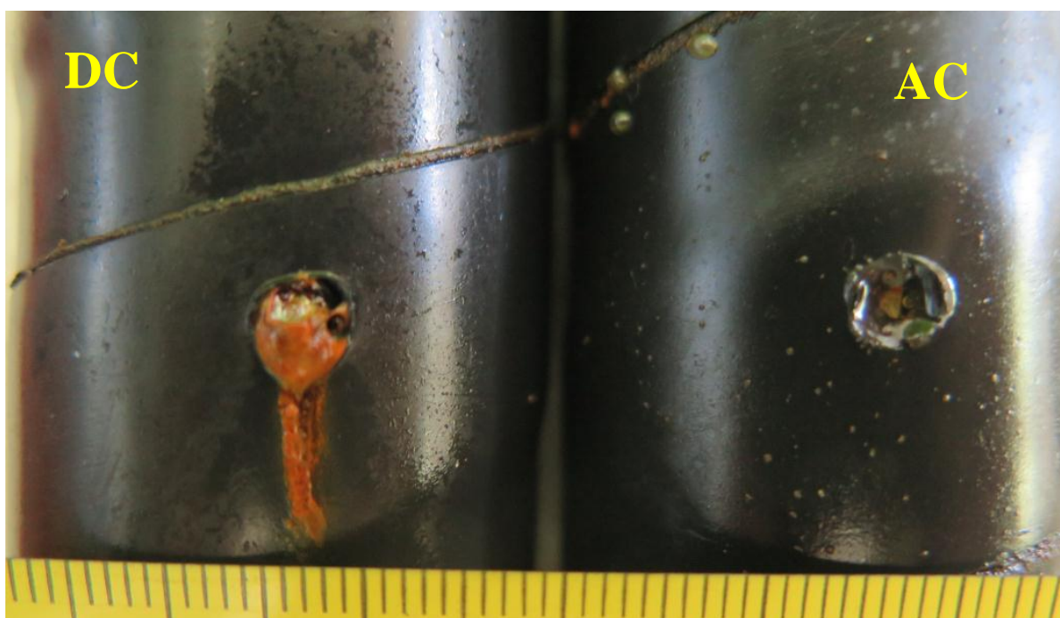
Slika 32. Usporedba uzoraka izloženih DC (lijevo) i AC (desno) lutajućoj struji. Vidljiv je značajno veći intenzitet oštećivanja uzorka izloženog DC struji u analiziranom području oštećenja prevlake
