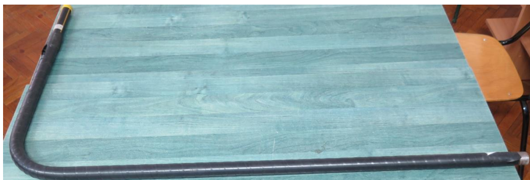
Slika 21. Prikaz cjevovodnog segmenta – čeličnog kućnog plinskog priključka zaštićenog prevlakom iz kojeg su izrezani ispitni uzorci
