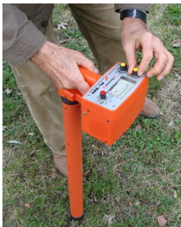
Slika 17. Lociranje cjevovoda tragačem (lokatorom) [19]
