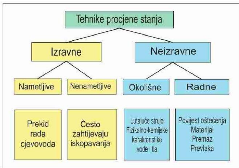
Slika 14. Tehnike za procjenu stanja cjevovoda[17]
