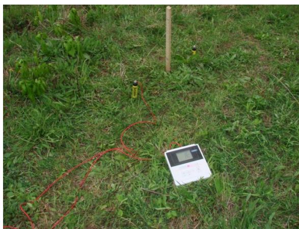
Slika 16. Neizravno ispitivanje – mjerenje gradijenta potencijala na površini [19]
