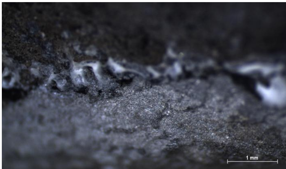
Slika 46. Stereomikroskopske snimke površine anoda od Al legure nakon ispitivanja: gornja slika – lokalna oštećenja anode A1 izložene AC struji, donja slika – granica oštećenja anode A3 izložene djelovanju DC struje
