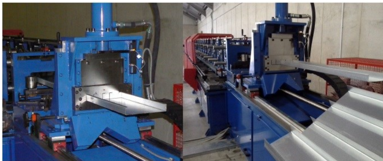
Slika. 27. Preša za odsijecanje i proširivanje [13.]
