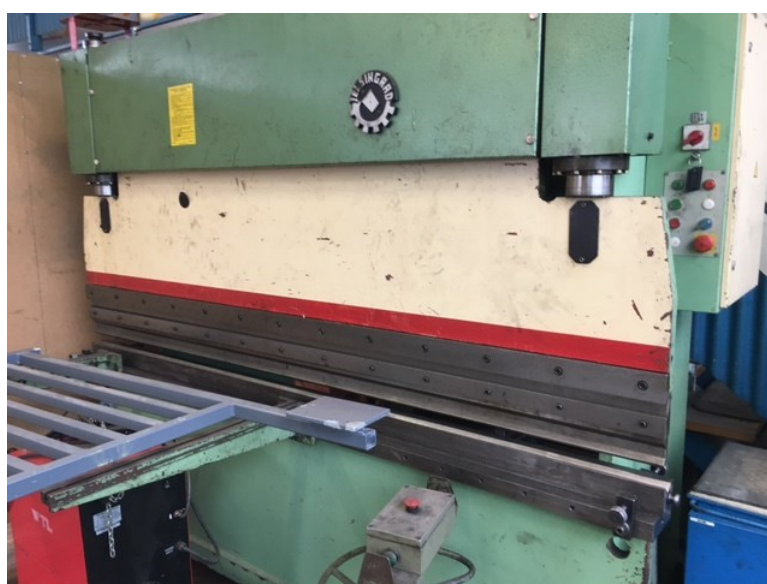
Slika. 9. Hidraulična savijačica HAPA 80 [5.]
