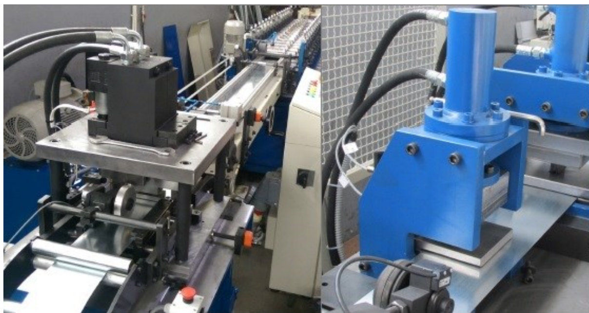
Slika. 25. Hidraulična preša za štancanje [13.]
