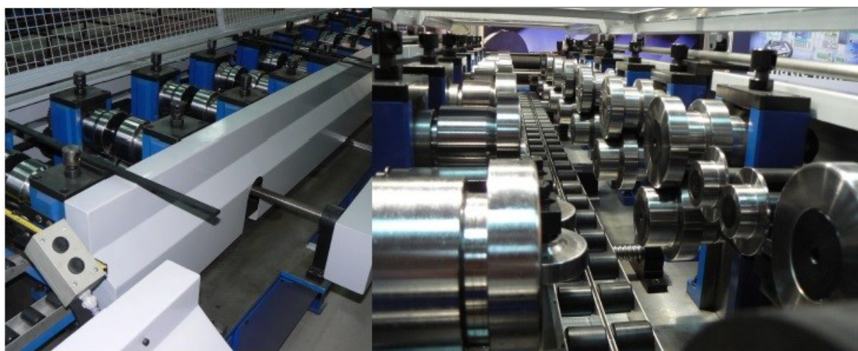
Slika. 26. Stroj za profiliranje [13.]
