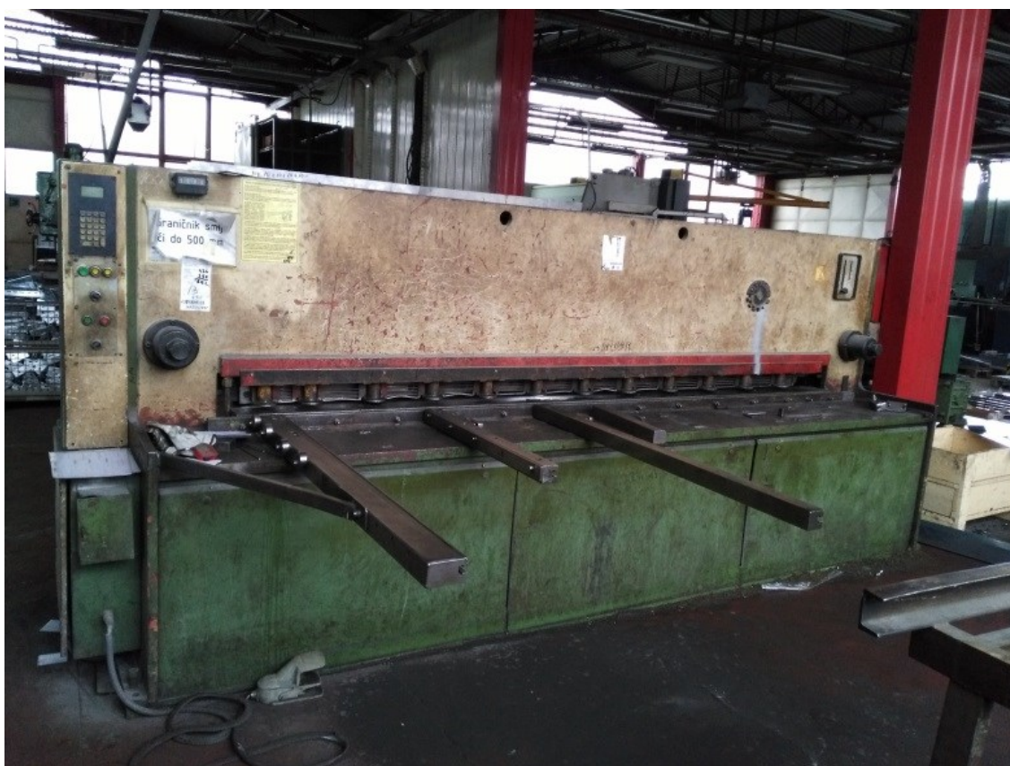
Slika. 7. Hidraulične škare MG 31/6 [5.]
