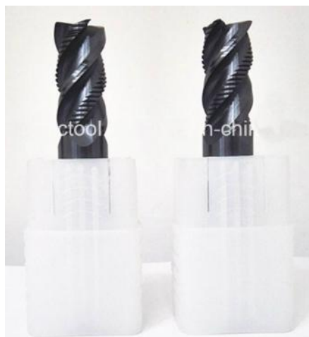
Slika 19. Glodalo prevučeno TiAlSiN prevlakom, [26]
