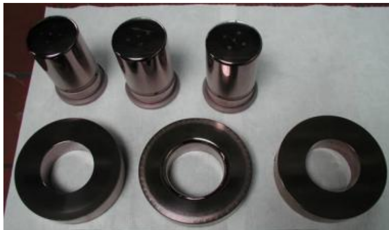
Slika 16. Dijelovi prevučeni TiN/TiCN prevlakom, [7]
