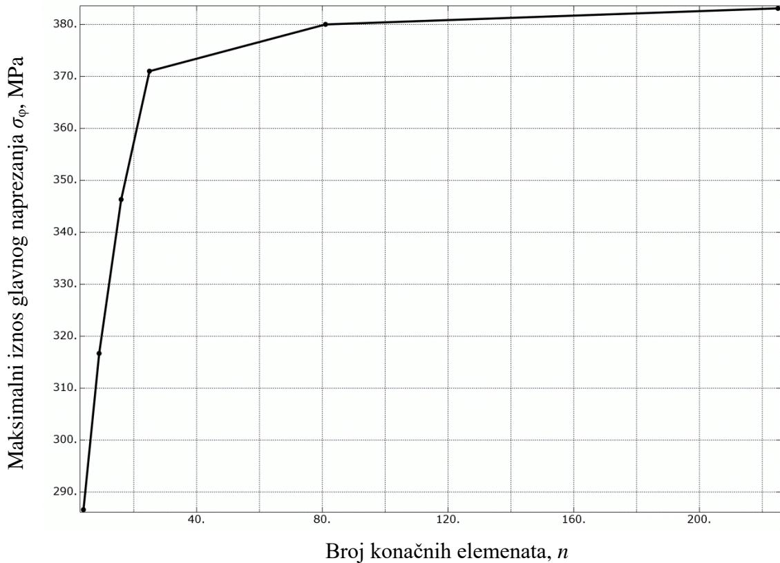
Slika 21. Konvergencija maksimalnog naprezanja u korijenu zuba punog zupčanika bez zareza
