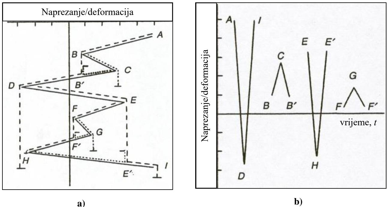
Slika 45. *Rainflow counting* metoda: a) spektar naprezanja/deformacije, b) podjela spektra na jednostavne cikluse [2]
