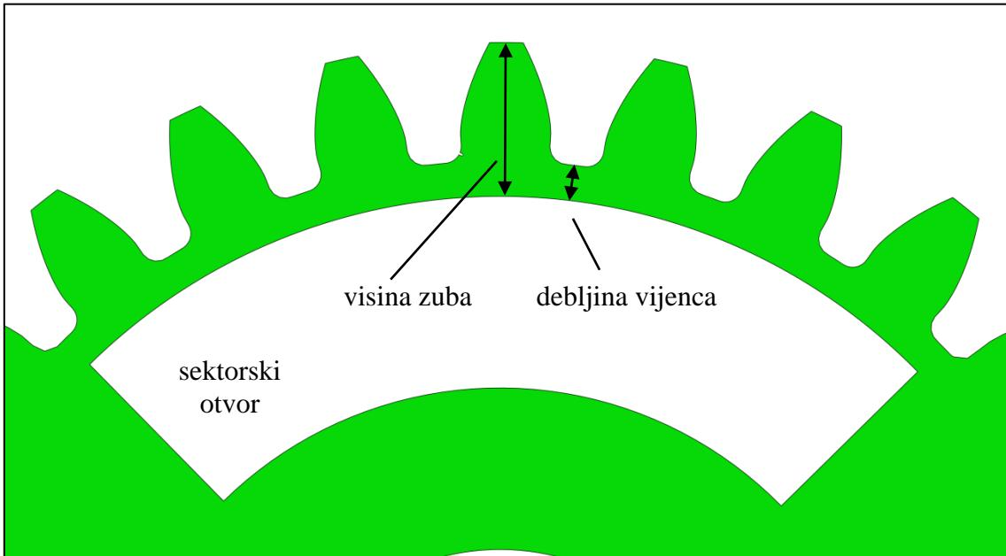
**Slika 16. Omjer debljine vijenca i visine zuba zupčanika**
