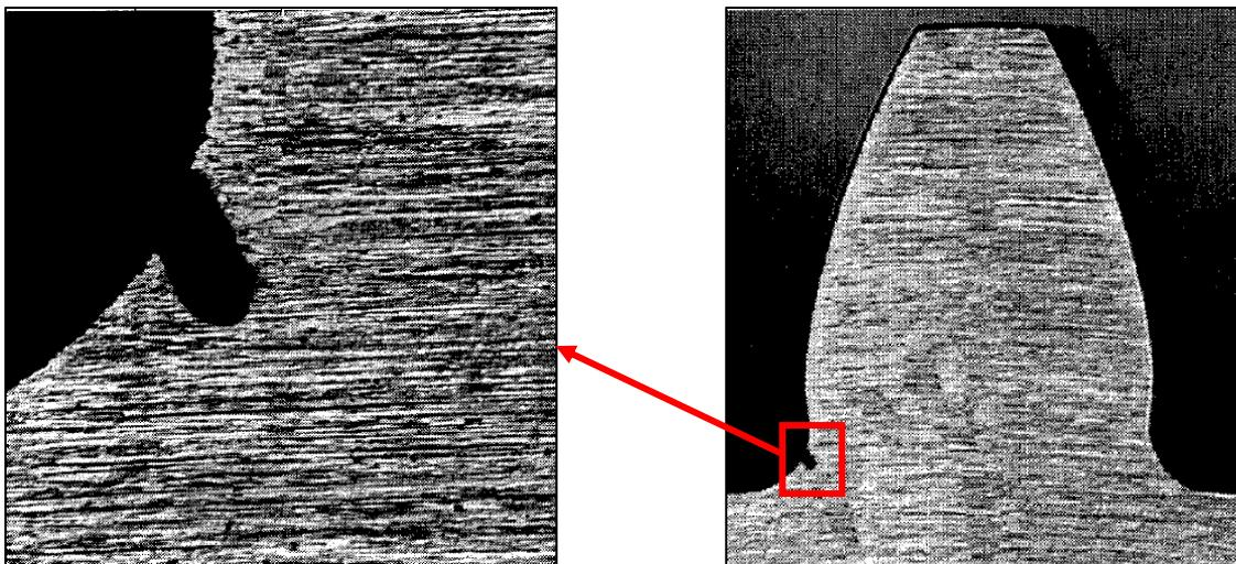
Slika 12. Zarez u korijenu ispitivanog zuba zupčanika [9]
