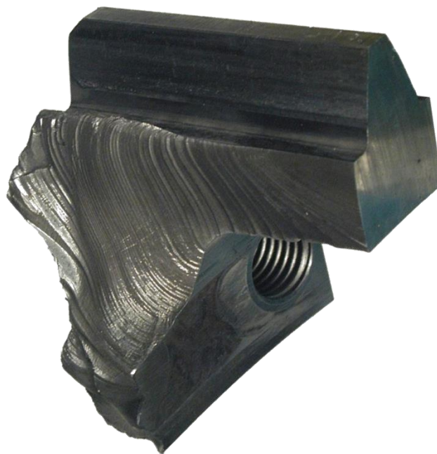
Slika 9. Lom zuba cilindričnog zupčanika s tankim vijencem uslijed zamora materijala [8]
