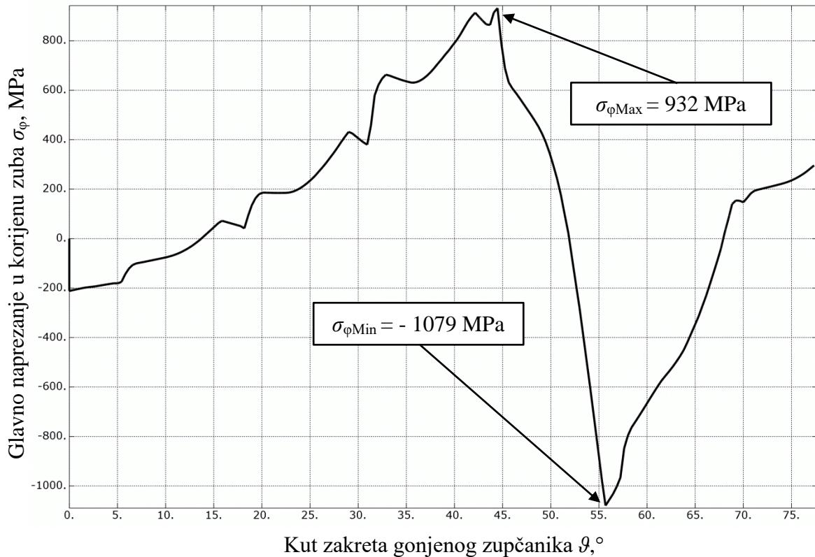
**Slika 60. Ciklus naprezanja korijena zuba zupčanika s tankim vijencem, zarezom, pukotinom i trenjem**
