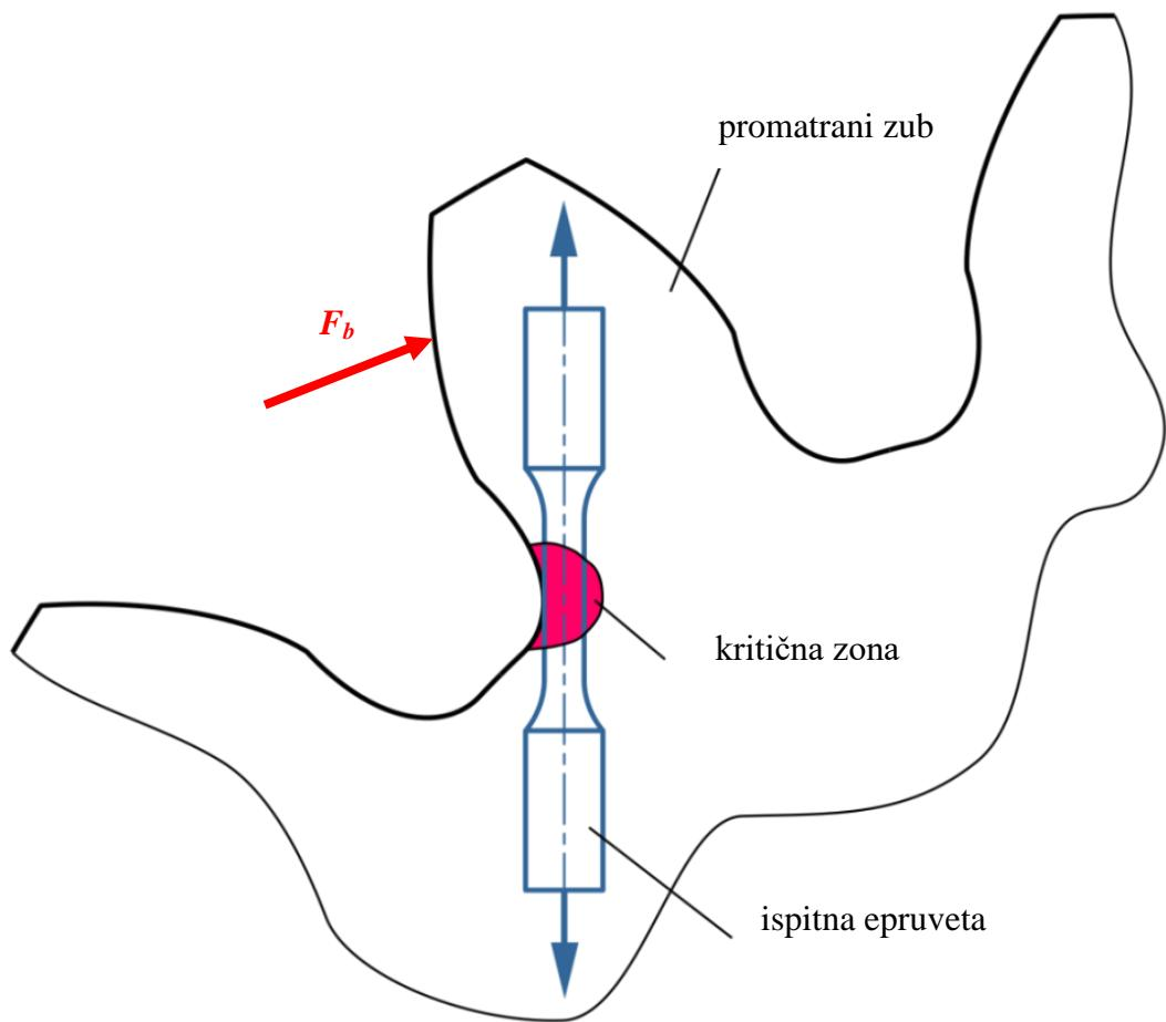
Slika 7. Princip sličnosti [6]
