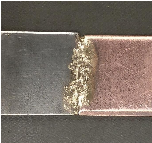
Slika 34: Vizualno loš spoj (uzorak 22)
