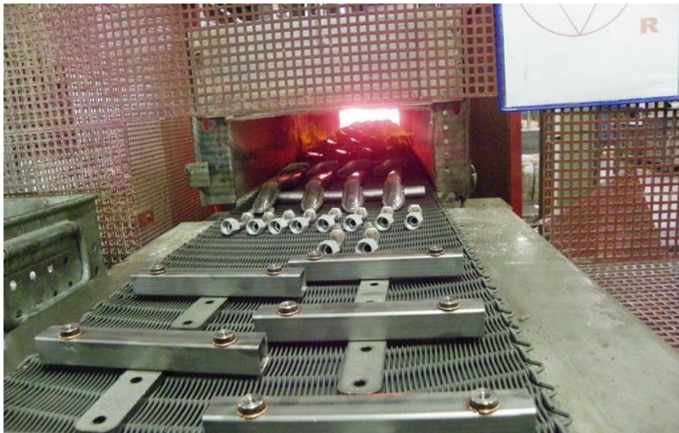
Slika 5: Ulazak dijelova u prolaznu peć [9]
