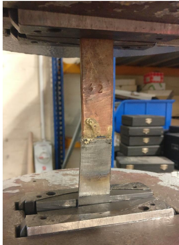
Slika 41: Uzorak u čeljustima kidalice (uzorak 42)
