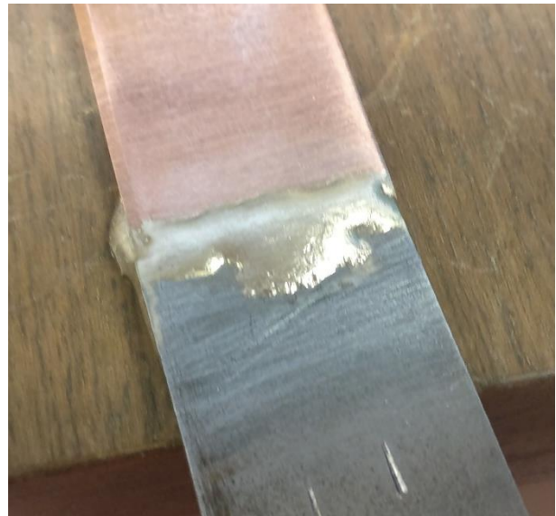
Slika 35: Vizualno dobar spoj (uzorak 11)
