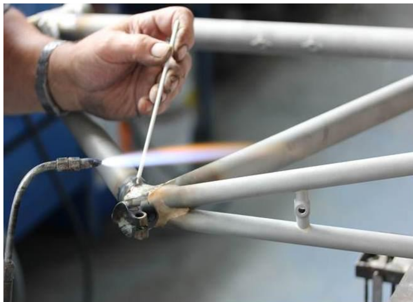
Slika 3: Lemljenje okvira bicikla plamenikom [7]
