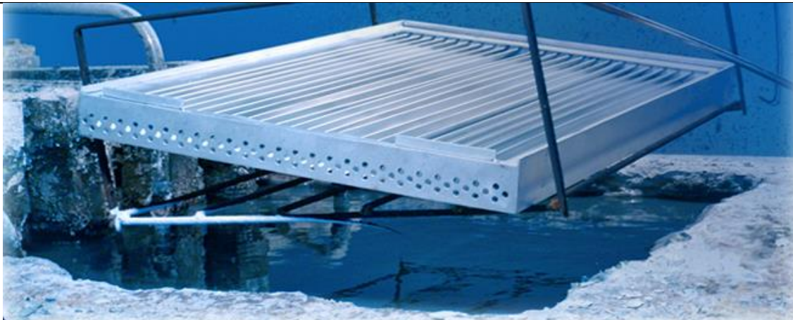
Slika 9: Uranjanje aluminijskih dijelova u rastaljeno talilo [13]
