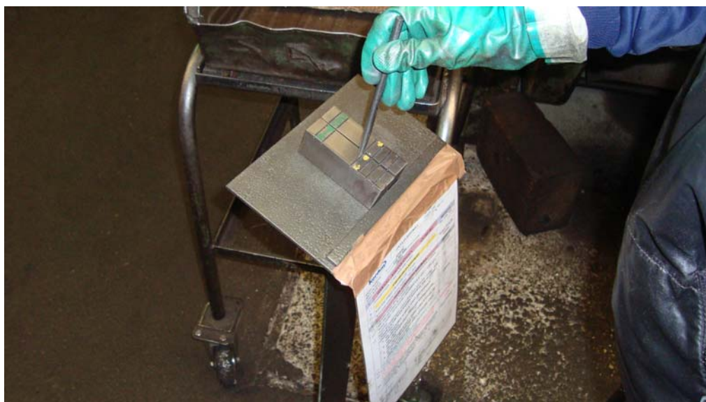
Sl. 70. Provjera kvečanog izratka šablonom
