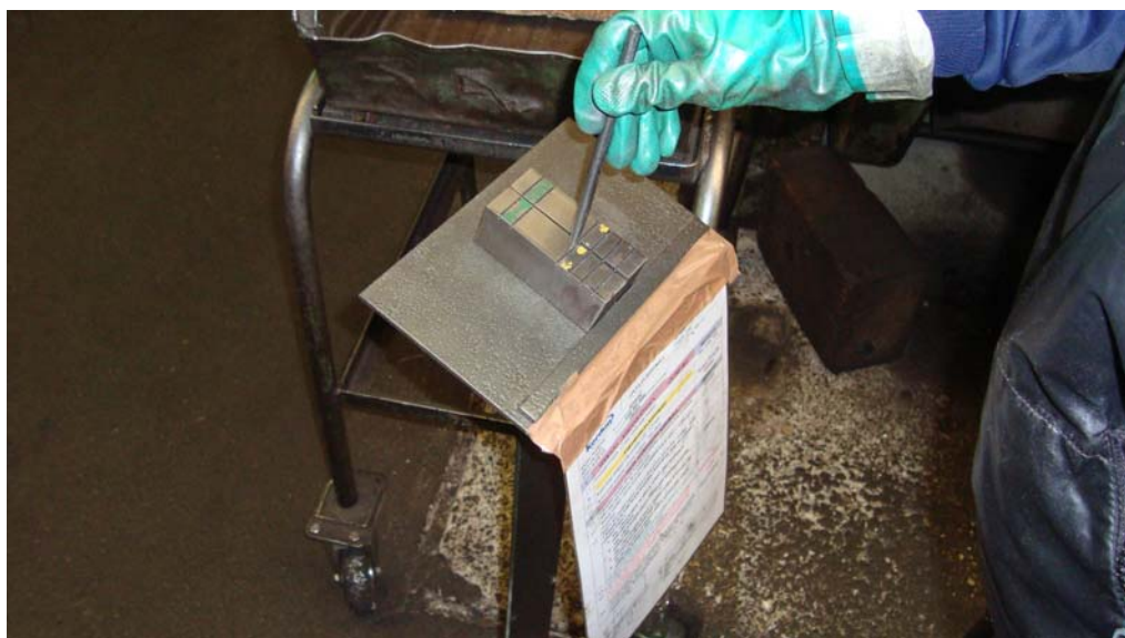
Sl. 70. Provjera kvećanog izratka šablonom
