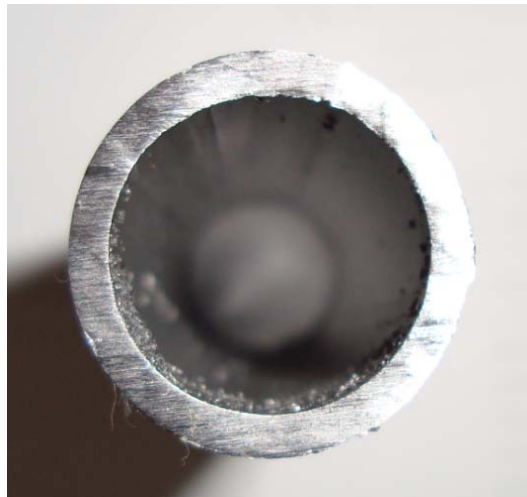
Sl. 9. Izgled cijevi odrezane na stroju HAP 280
