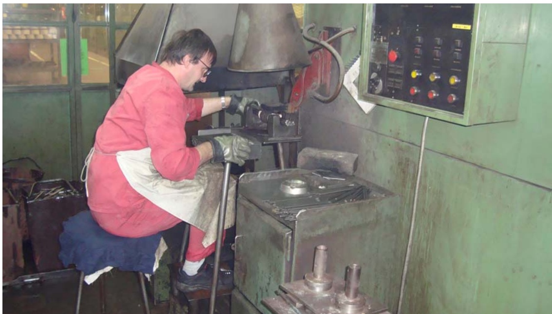
Sl. 21. Izvođenje kaljenja
