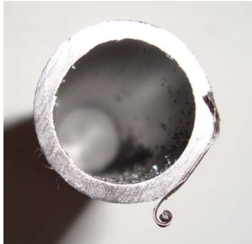
Sl. 10. Izgled cijevi odrezane na stroju Selectomat 320 S
