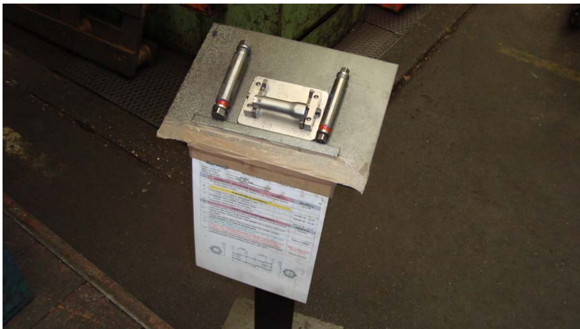
Sl. 66. Šablona (kalibar) – izvlačenje ključa
