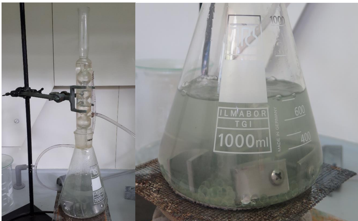
Slika 56: Ispitivanje uzoraka u 25 % otopini NaCl
