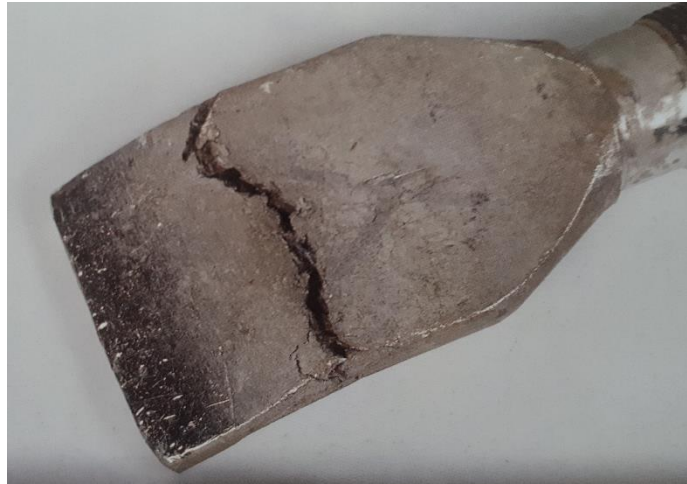
Slika 22: Kloridna napetosna korozija (transkristalni lom) na lopatici od austenitnog nehrđajućeg čelika kvalitete AISI 316 [3]
