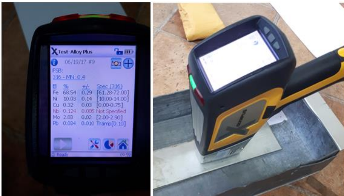
Slika 37: Ispitivanje kemijskog sastava XRF metodom
