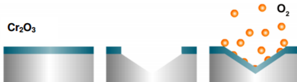
Slika 4: Samoobnavljanje pasivnog filma kromovih oksida na nehrđajućem čeliku [1]
