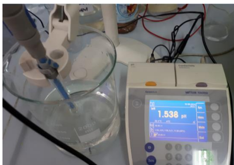
Slika 57: Dodavanje fosforne kiseline u otopinu radi postizanja tražene pH vrijednosti
