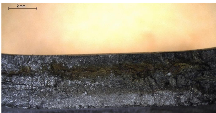
Uzorak AISI 316L zavaren i napregnut vijkom
