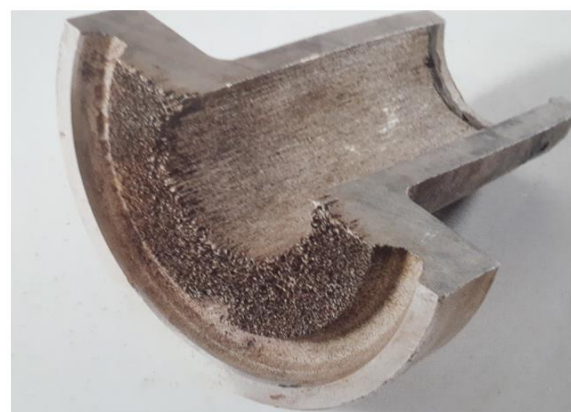
Korozija u procjepu
