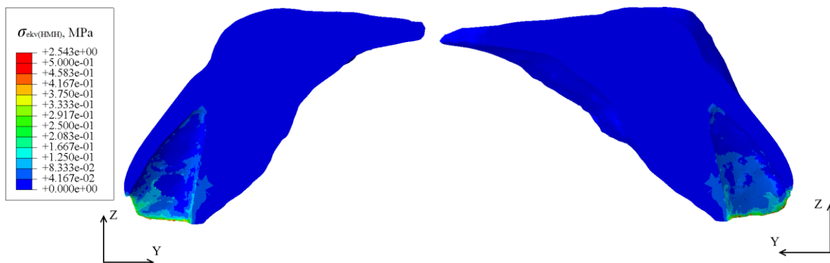
Slika 3.25 Raspodjela naprezanja po alveolnoj kosti za prvo hvatište sile, M/F=6
