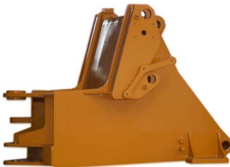
Slika 27. Reprezentantni proizvod: prednji dio okvira utovarivača [14]
