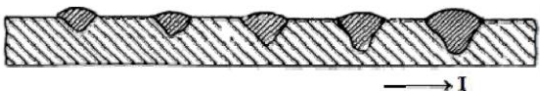
Slika 3. Utjecaj jakosti struje zavarivanja na geometriju zavara [7]
