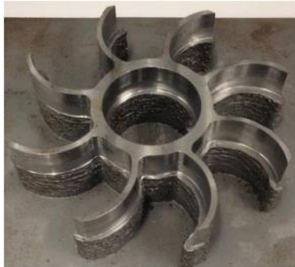
Slika 24. Rotor izrađen WAAM postupkom [28]
