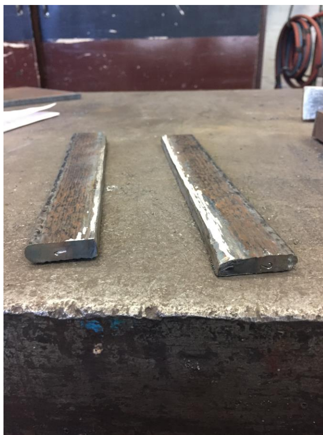
Slika 65. Pripremljeni i označeni uzorci za izradu ispitnih epruveta [31]
