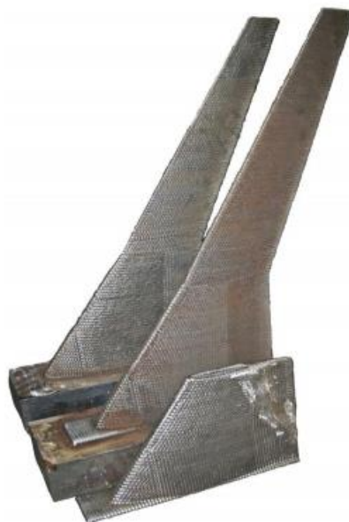
Slika 25. Model krila izrađen WAAM postupkom [26]
