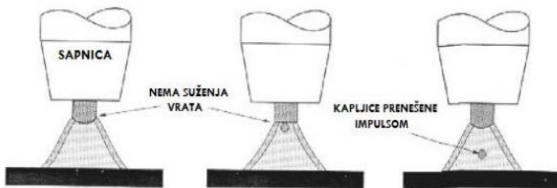
Slika 11. Shematski prikaz prijenosa metala impulsnim lukom [14]
