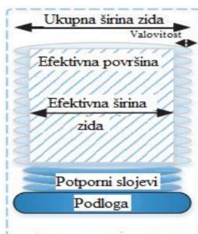
Slika 21. Zid izrađen WAAM postupkom [24]
