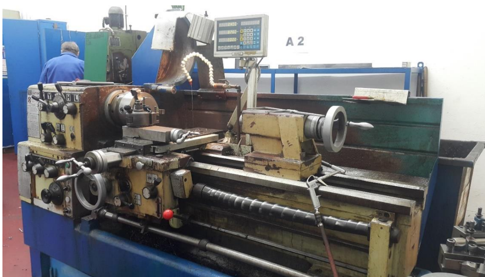
Slika 9.15. Klasični tokarski stroj Alfa 410×1000
