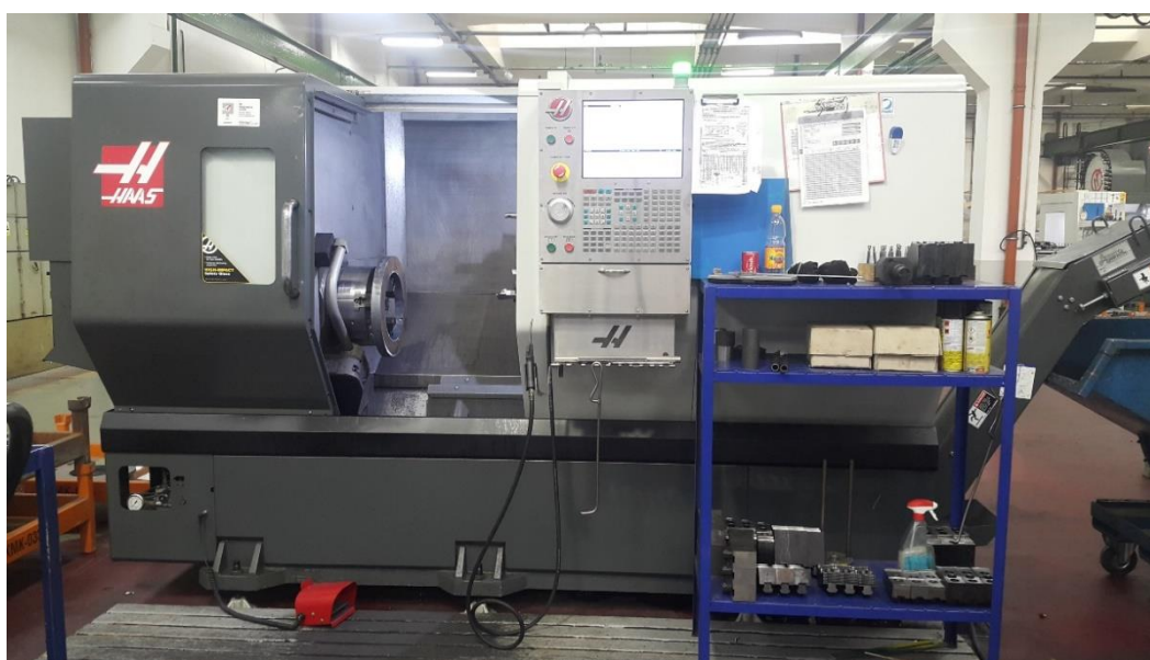
Slika 9.13. CNC obradni centar Haas ST-35
