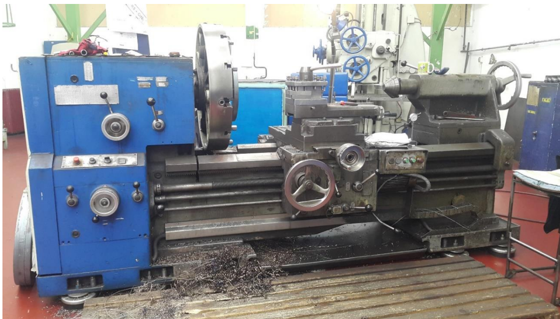
Slika 9.14. Klasični tokarski stroj Ada Potisje PA-900
