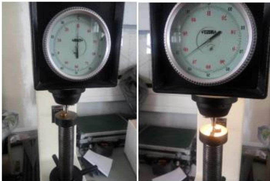
**Slika 6.1.** Ispitivanje adhezivnosti na Rockwell-ovom tvrdomjeru [18]
