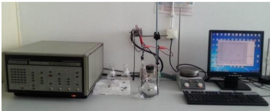
**Slika 9.1.** Ispitna oprema za elektrokemijska DC ispitivanja
