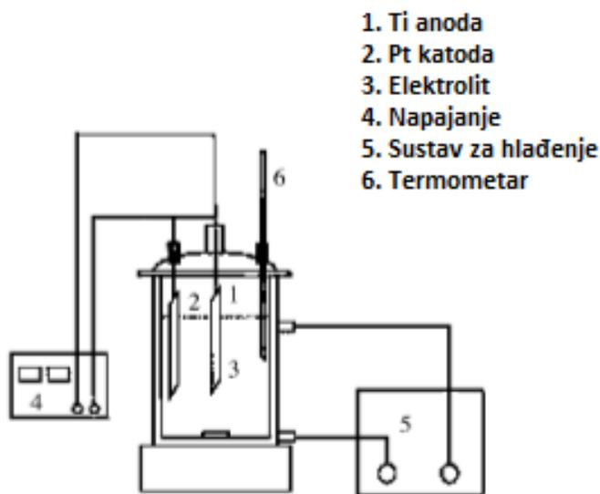
Slika 4.4. Shematski dijagram opreme za anodizaciju [14]
