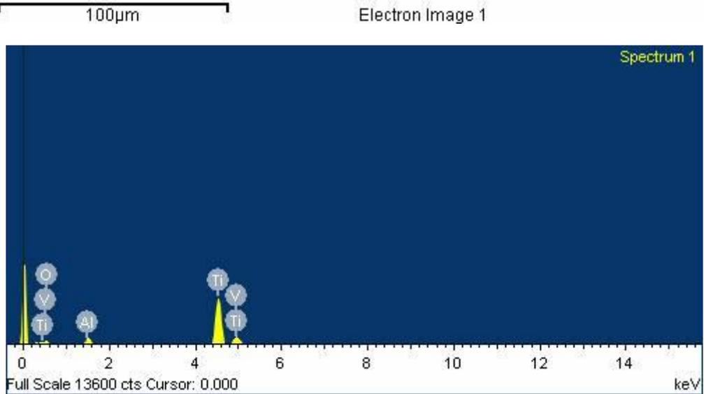
**Slika P7.** Rezultati EDS analize za uzorak oksidiran na 30V
