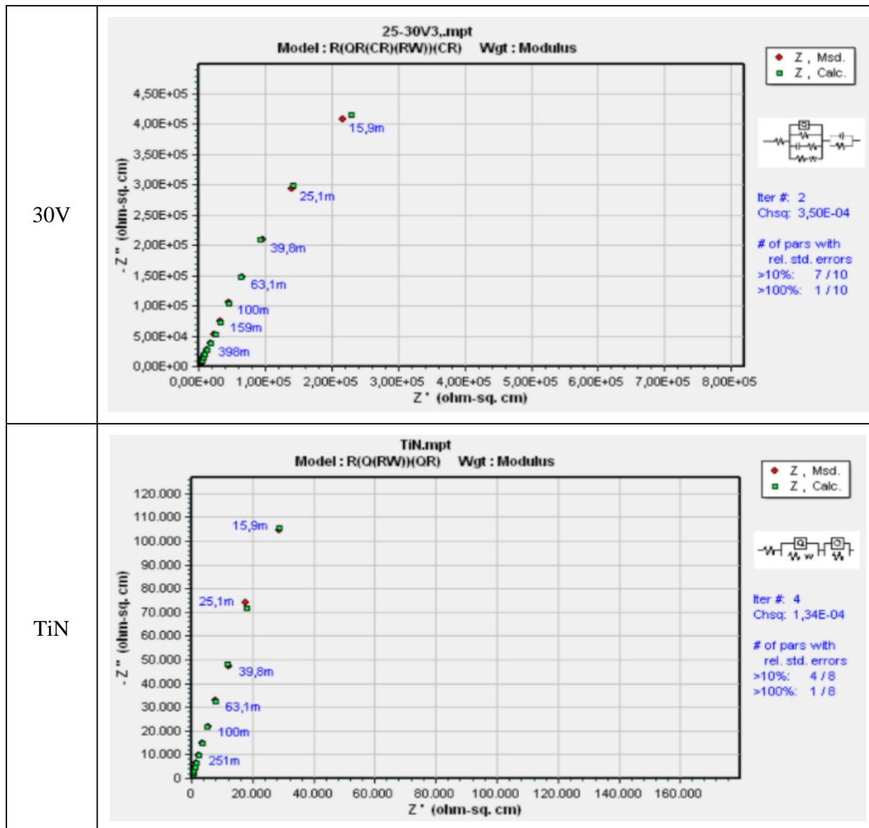
**Tablica 9.5.** Bodeovi dijagrami i pripadajući modeli ekvivalentnog strujnog kruga ispitnih uzoraka
