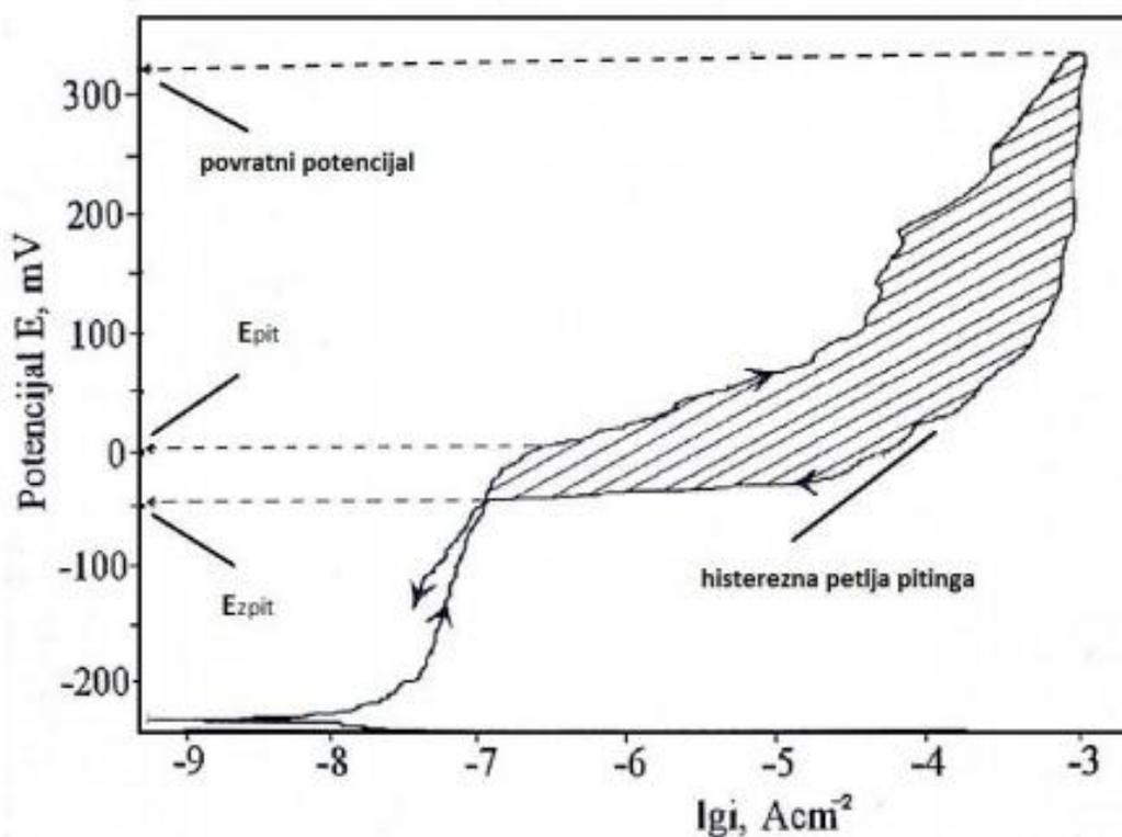
**Slika 5.9.** Izgled dijagrama cikličke polarizacije za uzorak metala sklonog pittingu [21]
