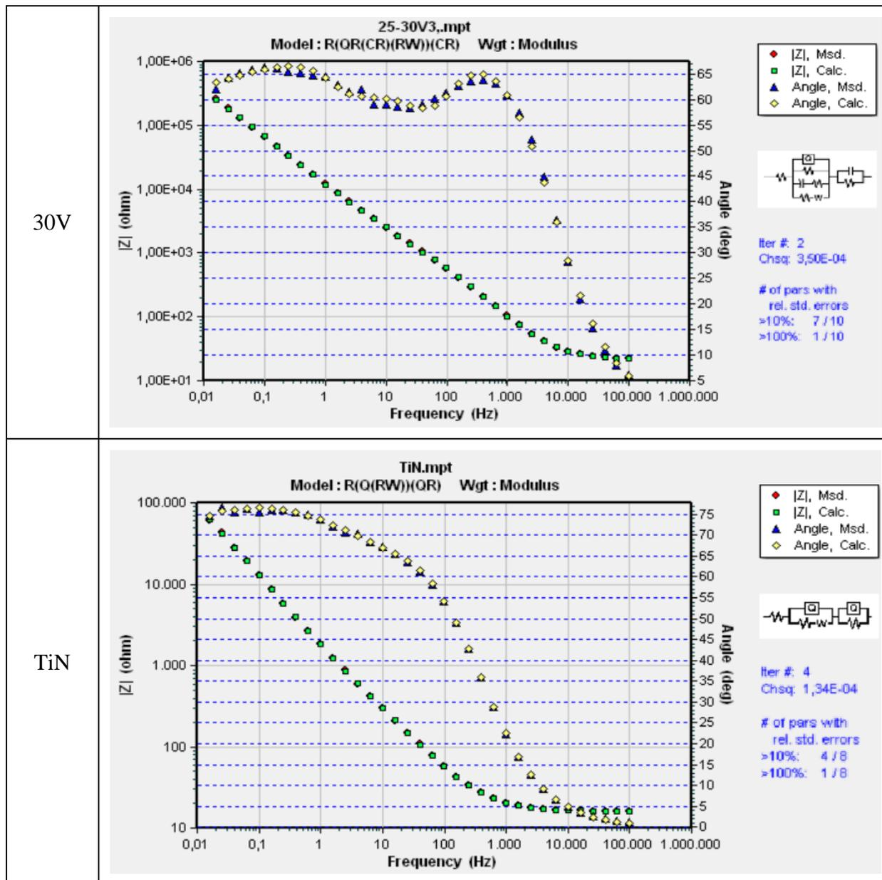
Nakon usporedbe izmjerenih i izračunatih vrijednosti impedancija u Nyquistovim dijagramima uzoraka određeni su modeli ekvivalentnih električnih krugova koji najbolje opisuju reakcije i promjene na površini ispitnih uzoraka u ispitnom elektrolitu. Za uzorke su odabrani sljedeći modeli ekvivalentnog strujnog kruga:
