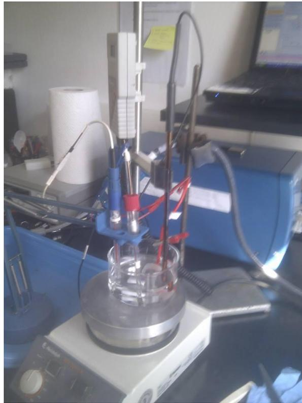
**Slika 9.10.** Ispitna oprema za elektrokemijska AC ispitivanja
