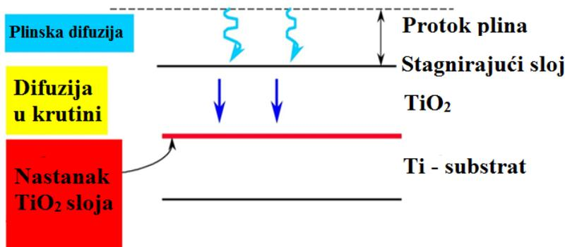
Slika 4.3. Shematski prikaz nastanka  $\text{TiO}_2$  sloja [14]
