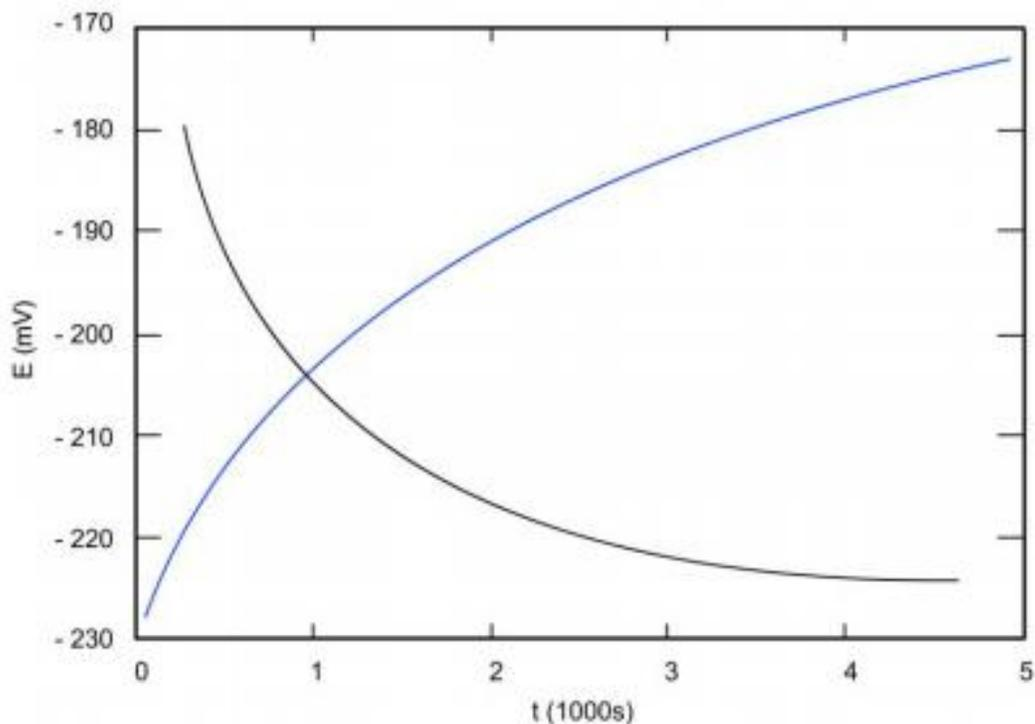
**Slika 5.7.** *Određivanje potencijala otvorenog strujnog kruga  $E_{ok}$  [21]*
