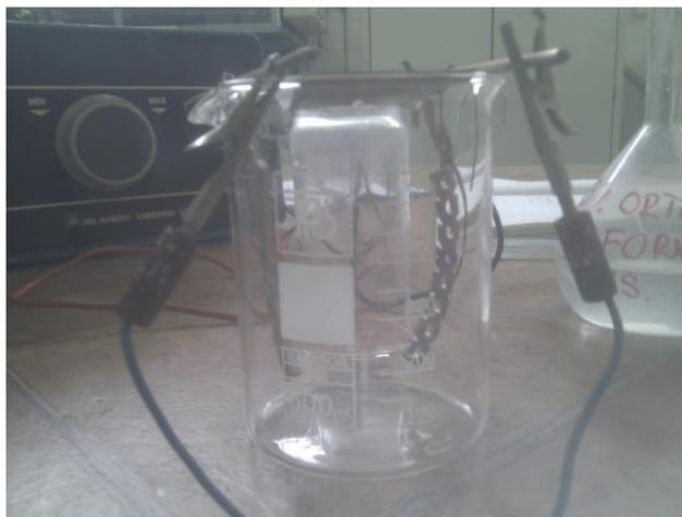
**Slika 7.6.** Posuda i elektrode za postupak anodne oksidacije
