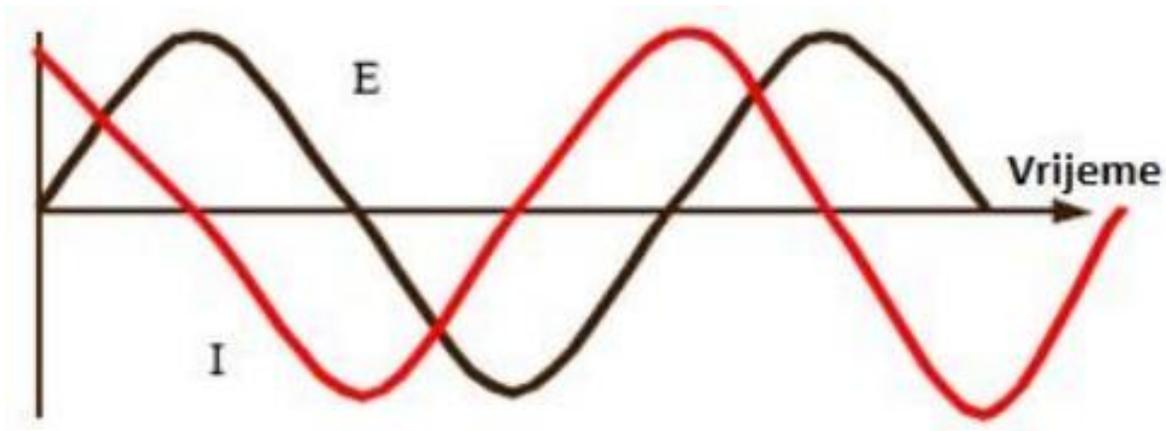
**Slika 5.11.** Sinusoidni val za narinuti potencijal ( $E$ ) i rezultirajuću struju ( $I$ ) [21]
