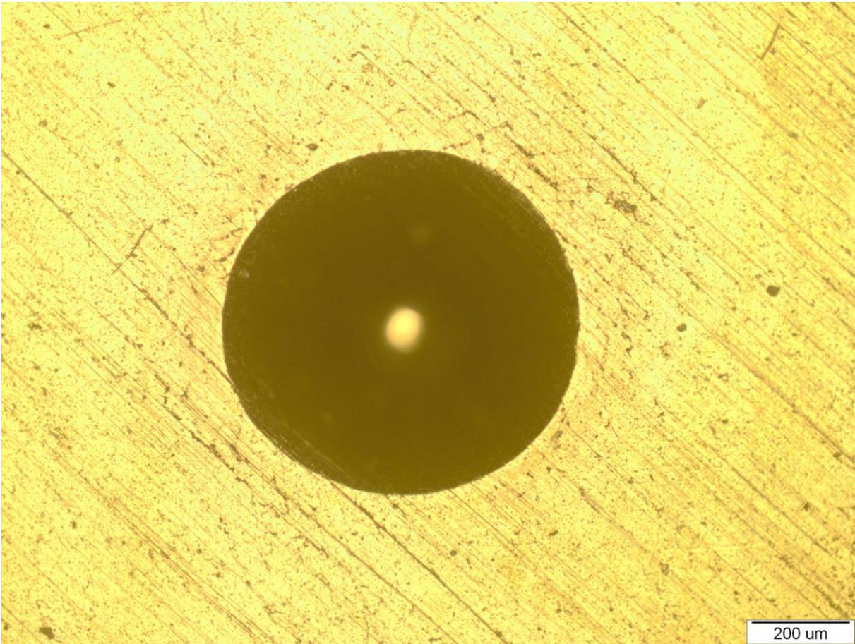
**Slika 6.3.** *Izgled otiska za određivanje adhezivnosti prevlake TiN na leguri Ti6Al4V*
