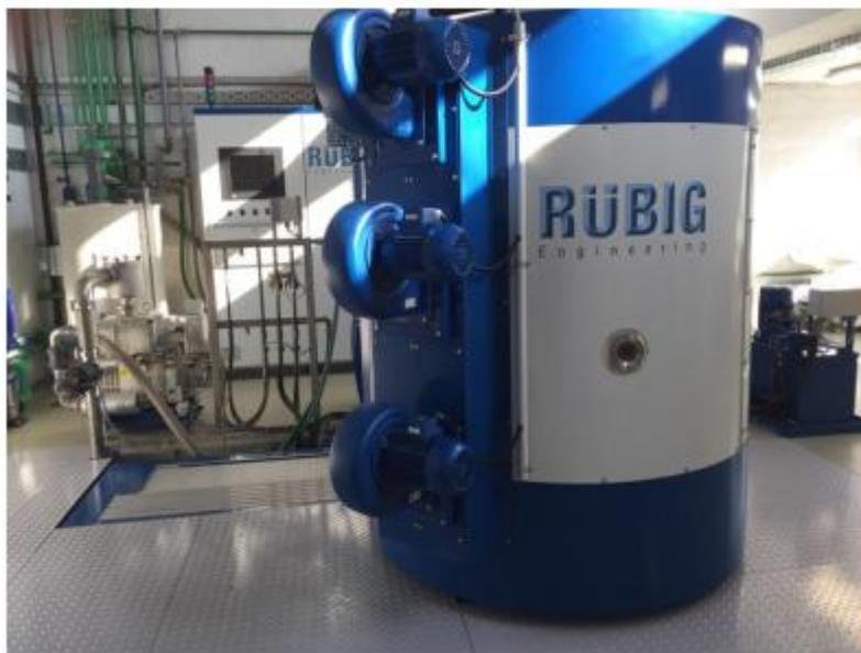
**Slika 7.4.** Uređaj RUBIG PC 70/90 instaliran na FSB-u
