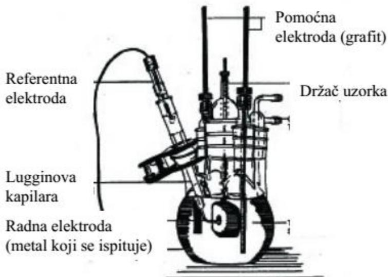
**Slika 5.6.** Tipični raspored elektroda pri elektrokemijskim ispitivanjima [21]
