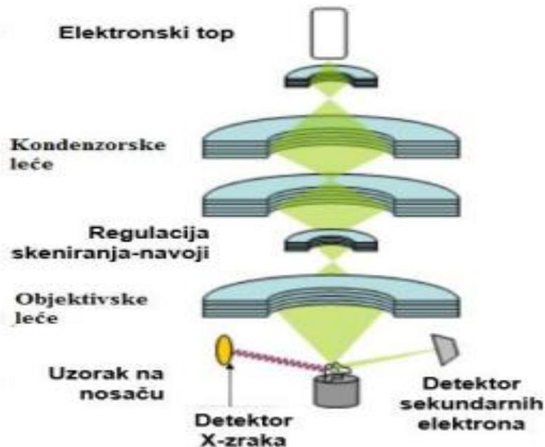
Slika 5.4. Princip rada SEM-a [20]
