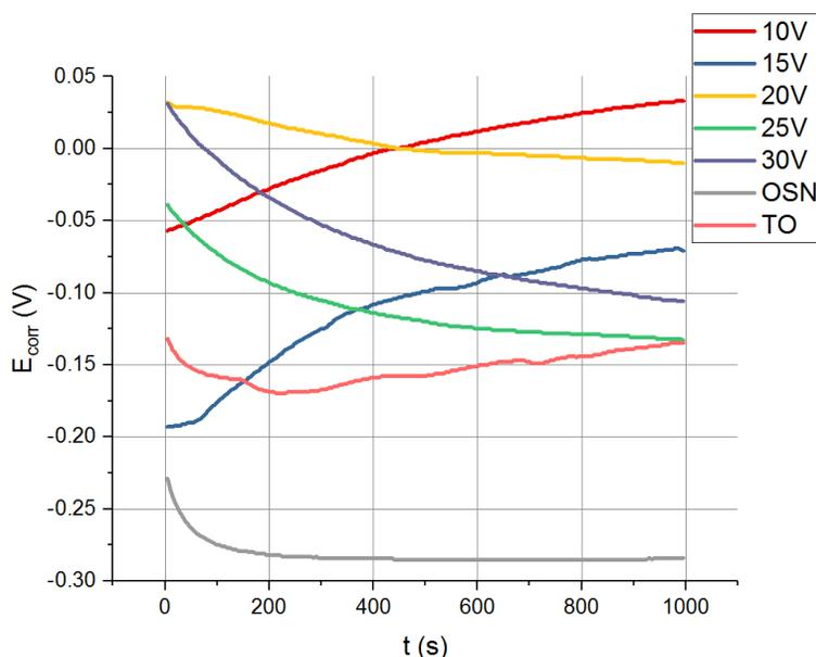
**Slika 9.5.** Promjene korozivnog potencijala ovisno o vremenu
