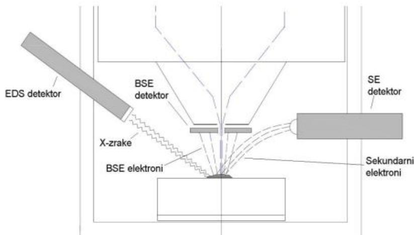
**Slika 5.5.** Prikaz tri osnovna tipa detektora [20]
