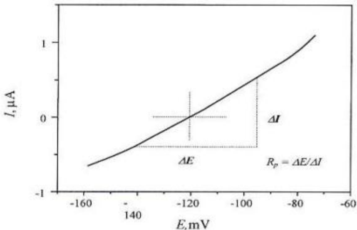
Slika 5.8. Određivanje polarizacijskog otpora  $R_p$  prema Mansfeldu [22]
