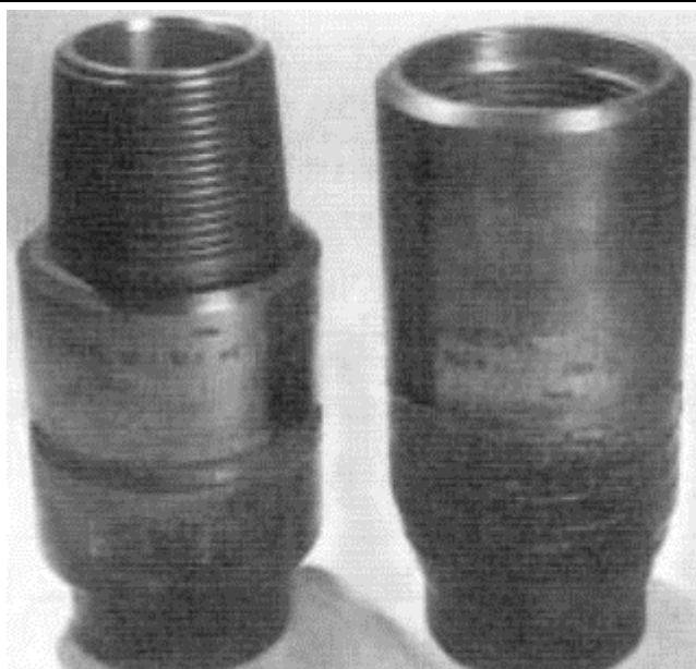
Slika 11 Vrh (eng. Pin ) i vrat (eng. Box ) cijevi
