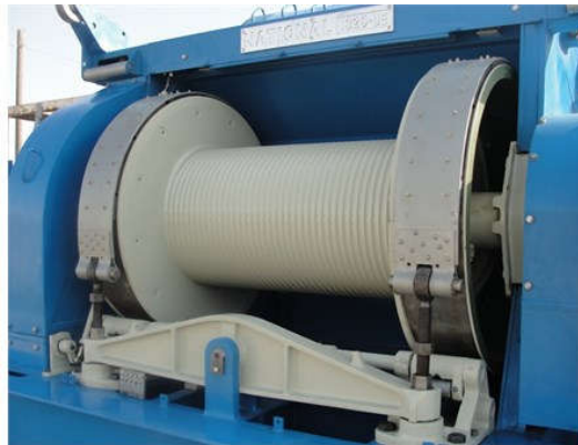
Slika 5 Sustav kočnica s uravnotežavajućom polugom
