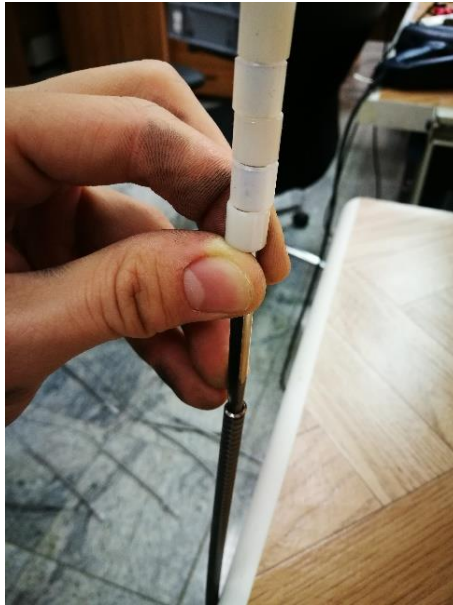
Slika 17. Prikaz spajanja alata za stavljanje sa metalnom osnovom
