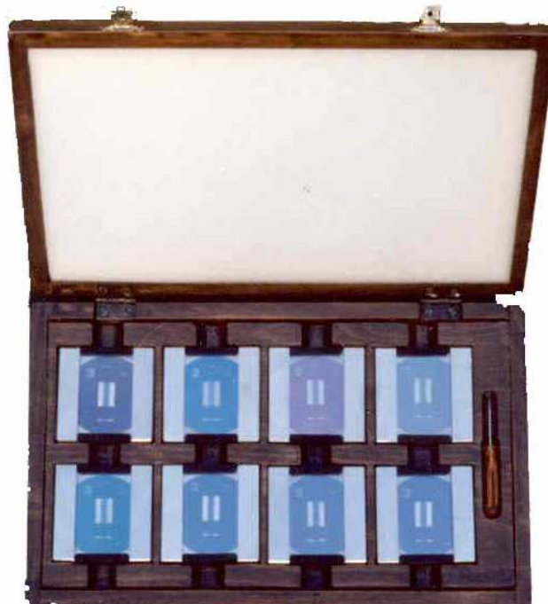
Slika 2.1. Set referentnih etalona hrapavosti LFSB-a.
