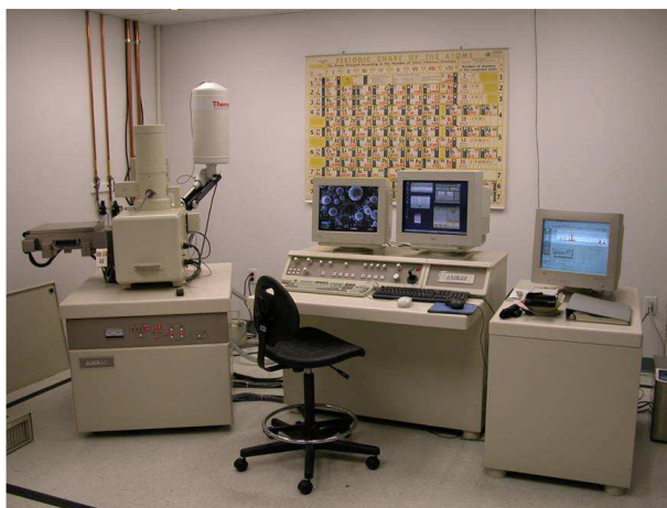
Slika 1.19. SEM sustav laboratorija za materijalografiju FSB-a.
