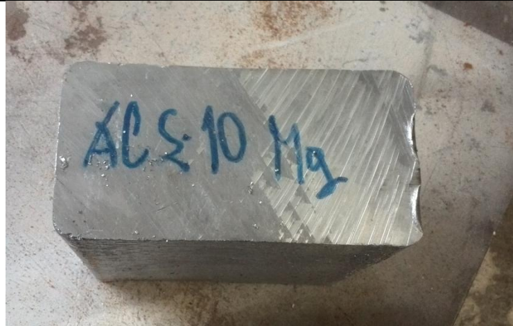
Slika 63. Ingot od legure AlSi10Mg
