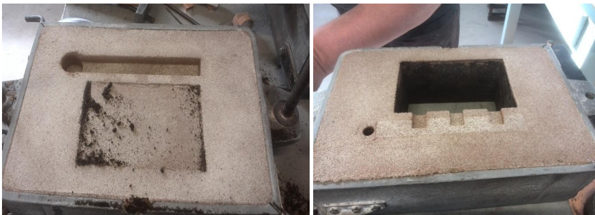
Slika 60. Donjak (lijevo) i gornjak (desno) nakon izvađenih elemenata uljavnog sustava
