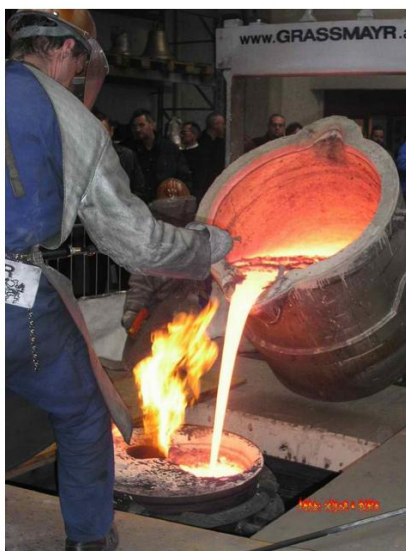
Slika 1. Lijevanje metala u kalup [2]
