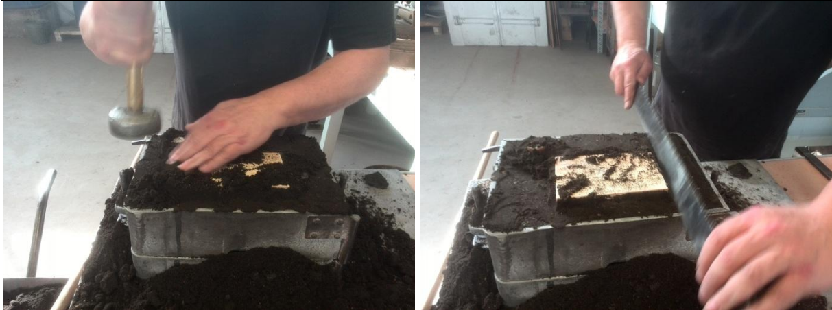
Slika 59. Sabijanje i poravnavanje punidbene kalupne mješavine gornjaka
