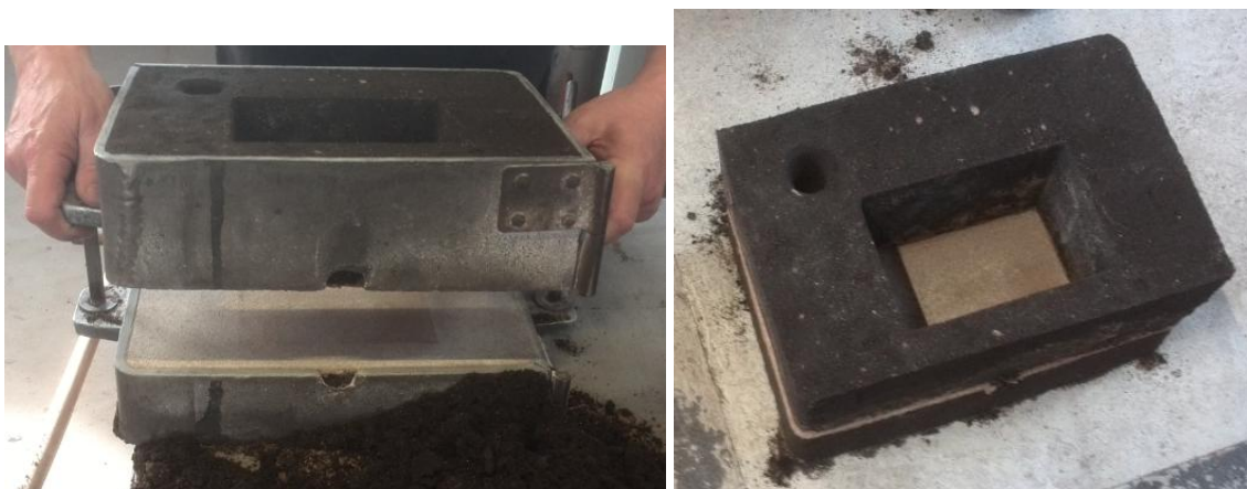
Slika 61. Sklapanje gornjeg i donjeg dijela kalupa
