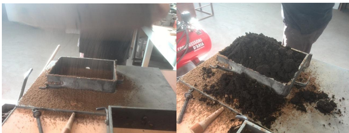
Slika 54. Nanošenje modelne i punidbene kalupne mješavine na donjak Punidbena kalupna mješavina se naknadno sabija i poravnava.
