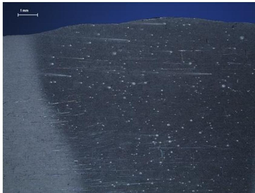
Slika 34. Mikroskopska analiza uzorka A – detalj lice zavara, lijevo
