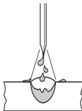
**Slika 8. Shematski prikaz prijenosa metala prijelaznim lukom [18]**
