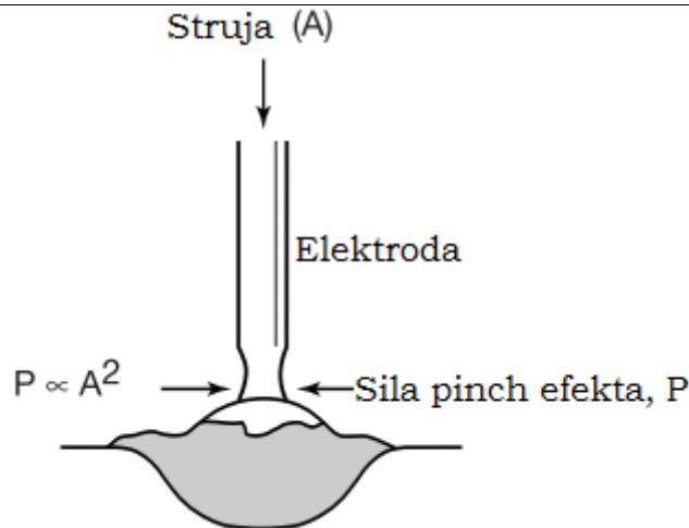
**Slika 7. Shematski prikaz prijenosa metala kratkim spojevima [18]**
