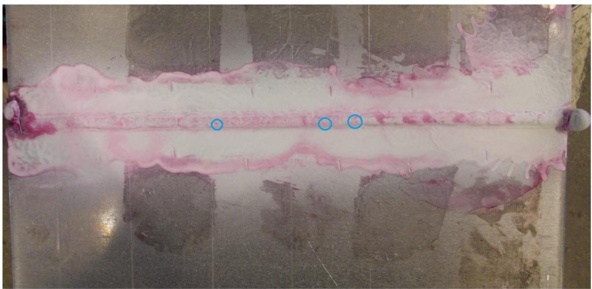
Slika 25. Ispitivanje penetrantima korijena zavara uzorka A
