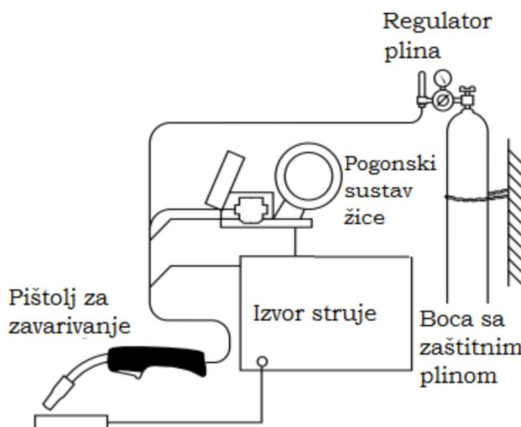
Slika 11. Prikaz osnovne opreme za MIG zavarivanje [18]
