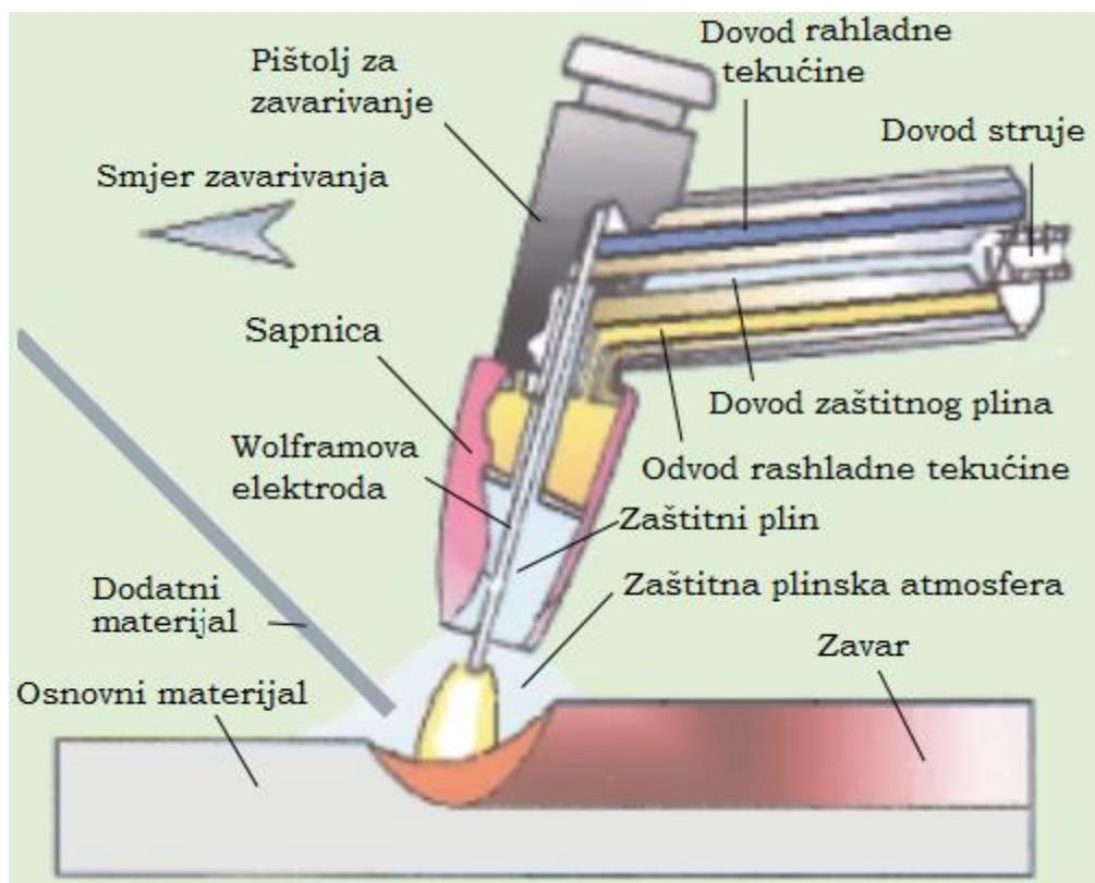
**Slika 3. Shematski prikaz TIG postupka zavarivanja [8]**
