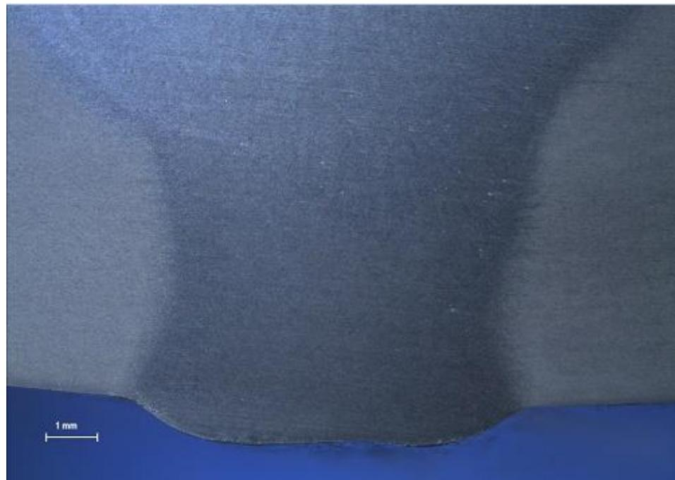
Slika 39. Mikroskopska analiza uzorka B – detalj korijen zavara
