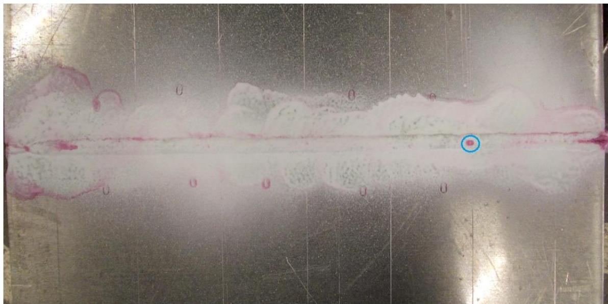
Slika 27. Ispitivanje penetrantima korijena zavara uzorka B
