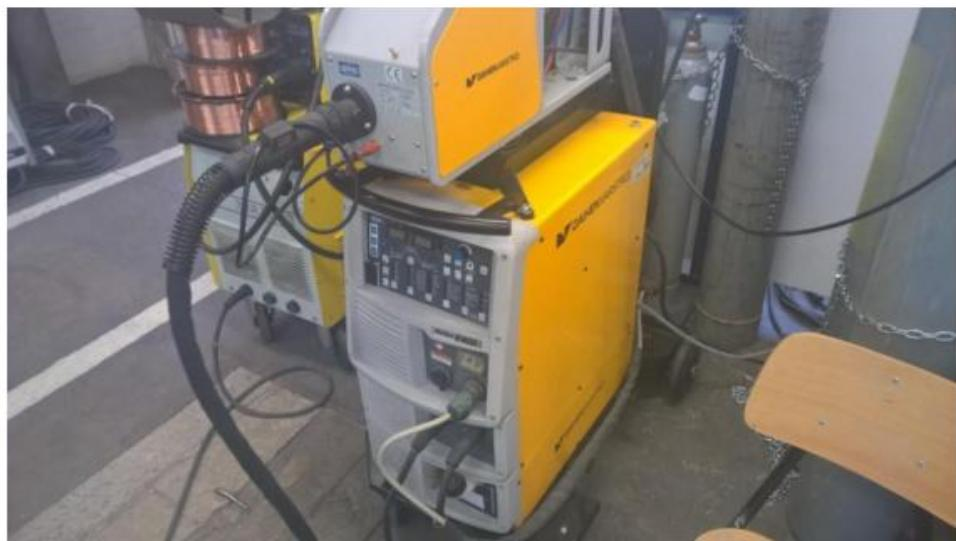
**Slika 16. Izvor struje za zavarivanje Welbee P400**
