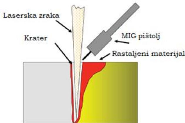
**Slika 4. Shematski prikaz hibridnog laserskog zavarivanja [13]**
