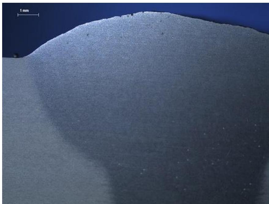
Slika 37. Mikroskopska analiza uzorka B – detalj lice zavara, lijevo
