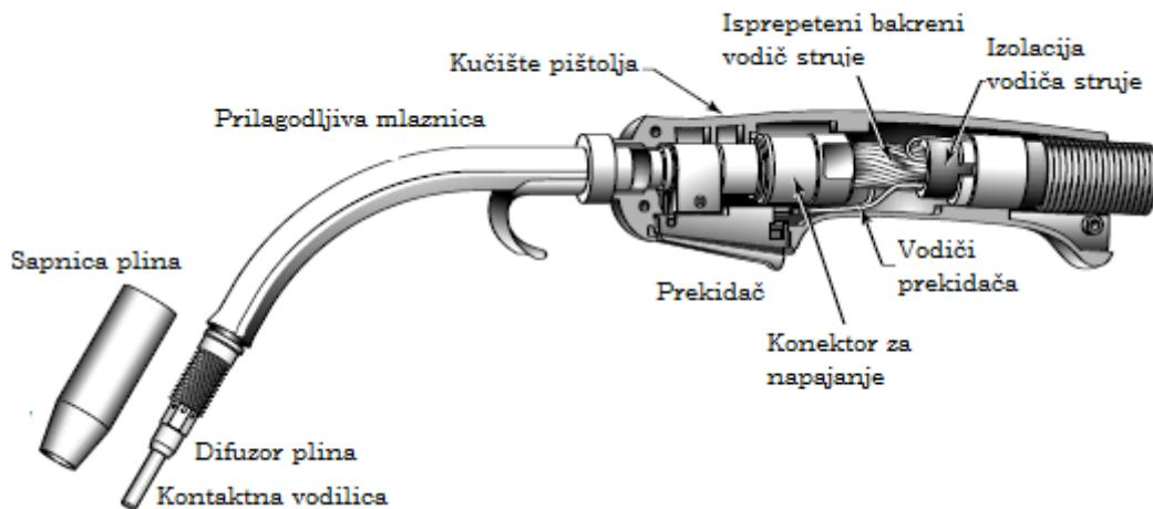
**Slika 14. Poprečni presjek pištolja za zavarivanje [18]**
