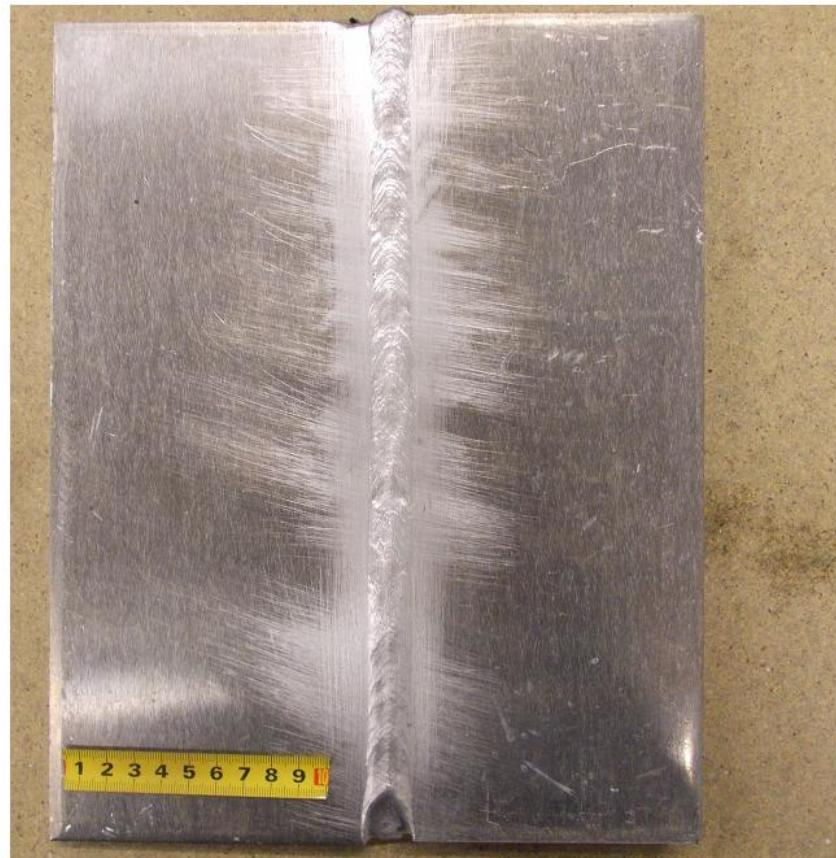
Slika 20. Lice zavara uzorka A
