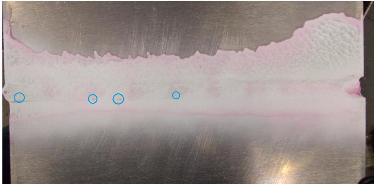
Slika 24. Ispitivanje penetrantima lica zavara uzorka A
