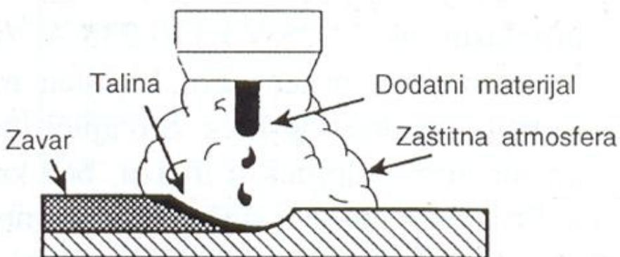
**Slika 5. Shema elektrolučnog zavarivanja taljivom metalnom elektrodom u zaštitnoj atmosferi plinova [16]**
