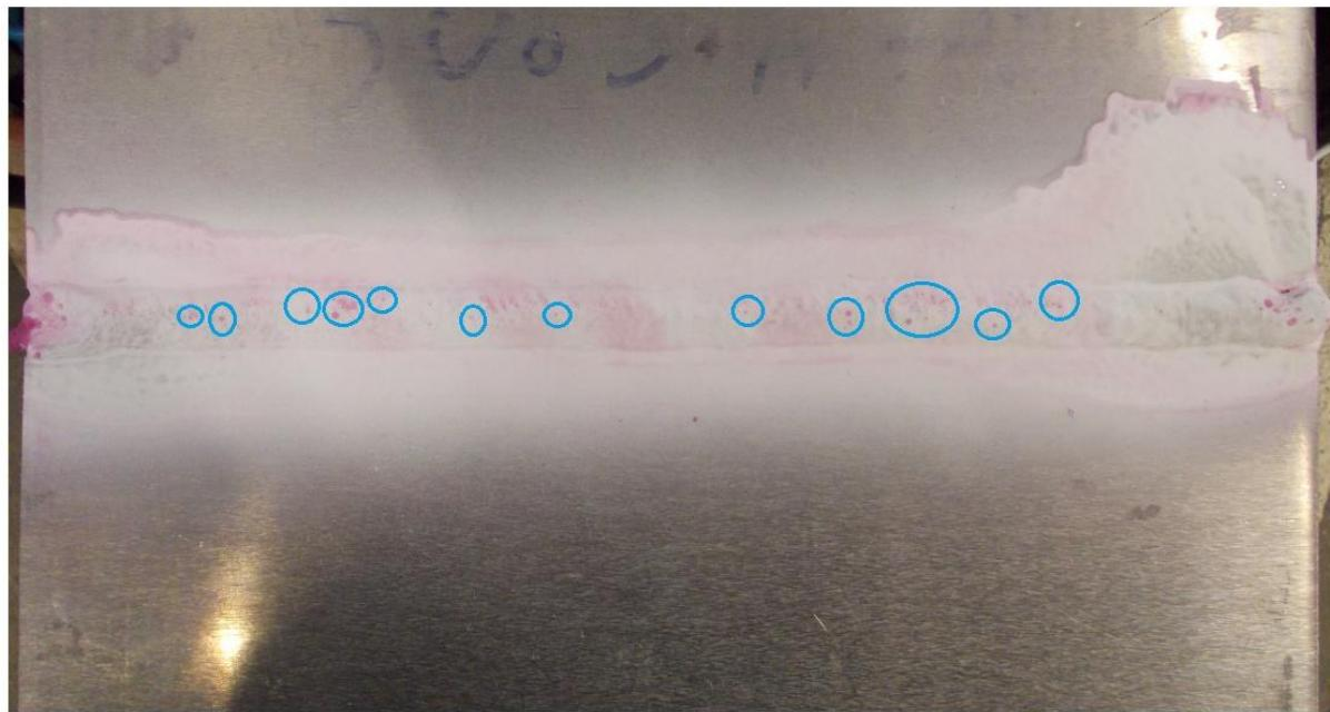
Slika 26. Ispitivanje penetrantima lica zavara uzorka B
