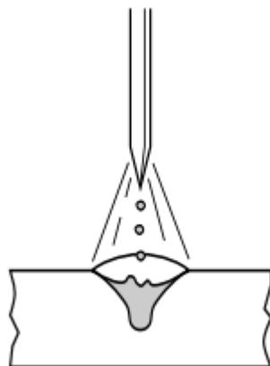
**Slika 9. Shematski prikaz prijenosa metala štrcajućim lukom [18]**
