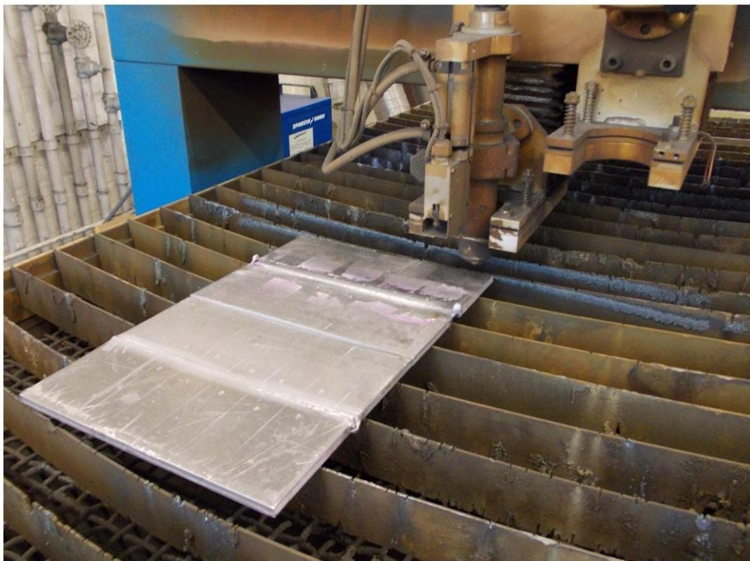
Slika 29. Priprema za rezanje ispitnih uzoraka
