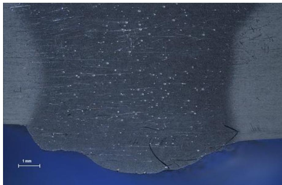
Slika 36. Mikroskopska analiza uzorka A – detalj korijen zavara
