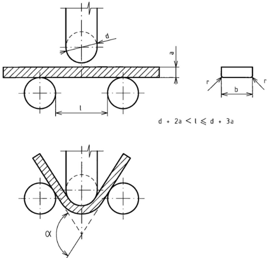
Slika 30. Prikaz ispitivanja sučeonog zavarenog spoja na savijanje [29]
