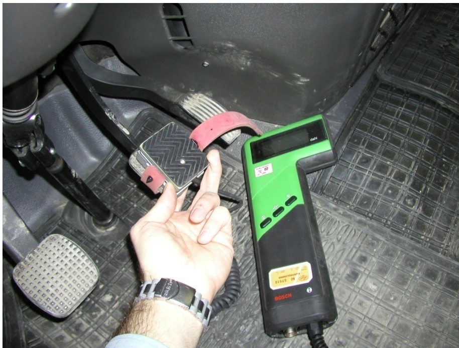
Slika 10.13 Postavljanje dinamometra na papučicu kočnice
