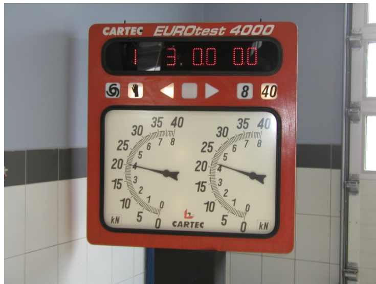
Slika 10.23 Prikaznik uređaja za mjerenje sile kočenja
