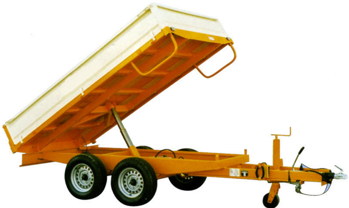
Slika 7.4 Priključno vozilo s inercijskom kočnicom
