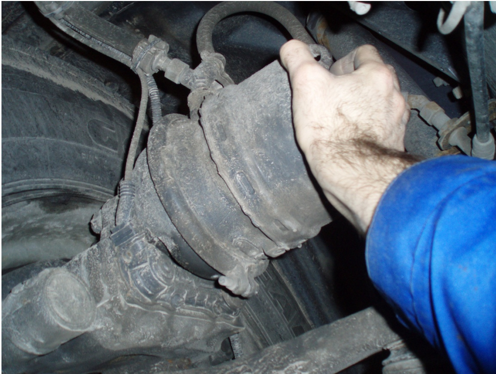
Slika 10.9 Provjera pričvršćenosti kočnog cilindra
