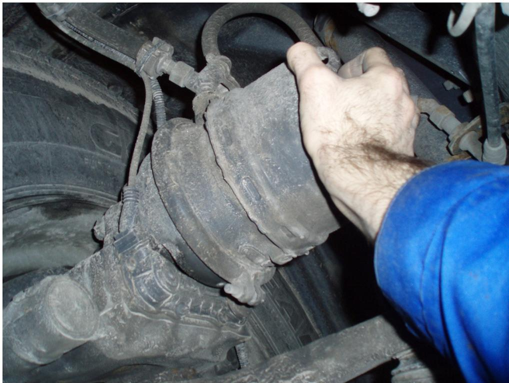
*Slika 10.9 Provjera pričvršćenosti kočnog cilindra*
