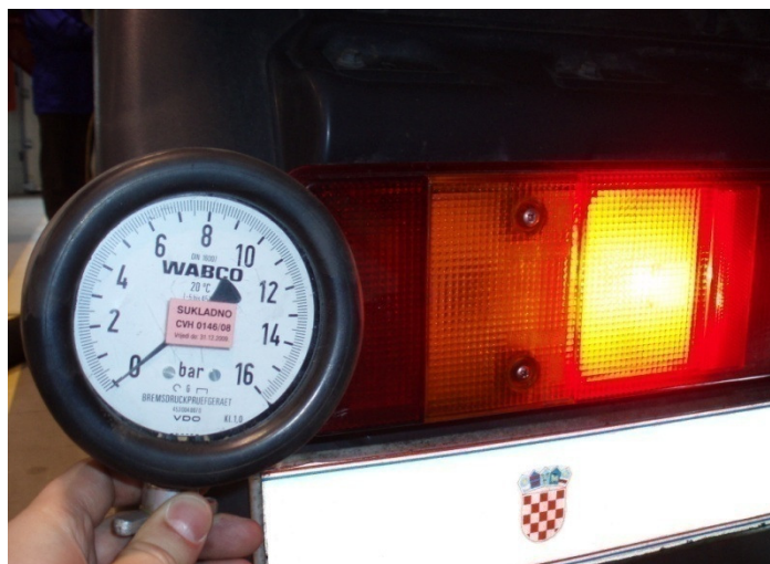
Slika 10.15 Kočna svjetla se pale prije porasta tlaka u kočnom sustavu
