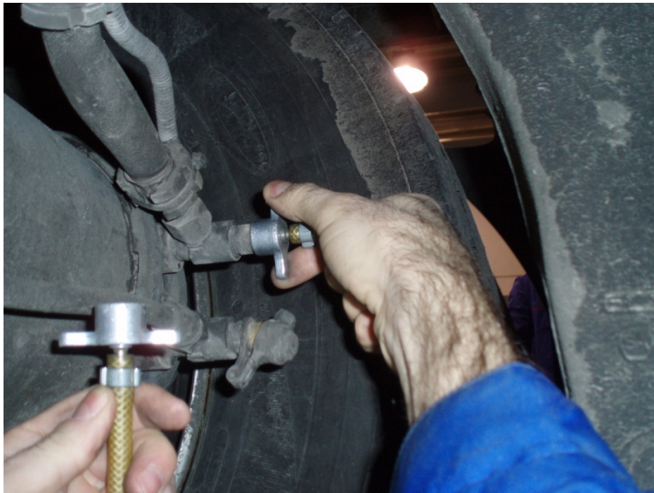
Slika 10.12 Spajanje crijeva manometra na kontrolni priključak kočnog cilindra
