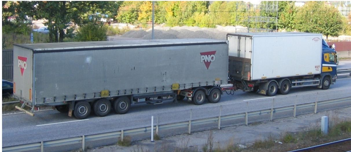
*Slika 11.2 Vučno vozilo najveće dopuštene mase 26 t u kombinaciji sa poluprikolicom spojenom preko kolica za teške terete*
