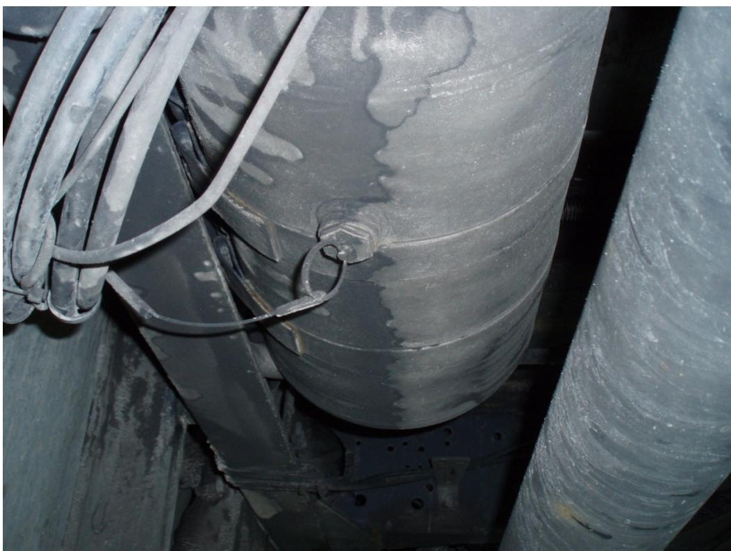
*Slika 10.3 Spremnik zraka s ručnim ventilom za ispuštanje kondenzata*
