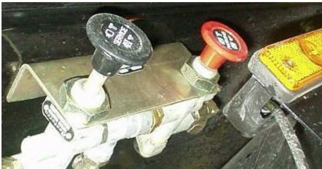
Slika 7.3 Ventil za pokretanje parkirne kočnice na priključnom vozilu
