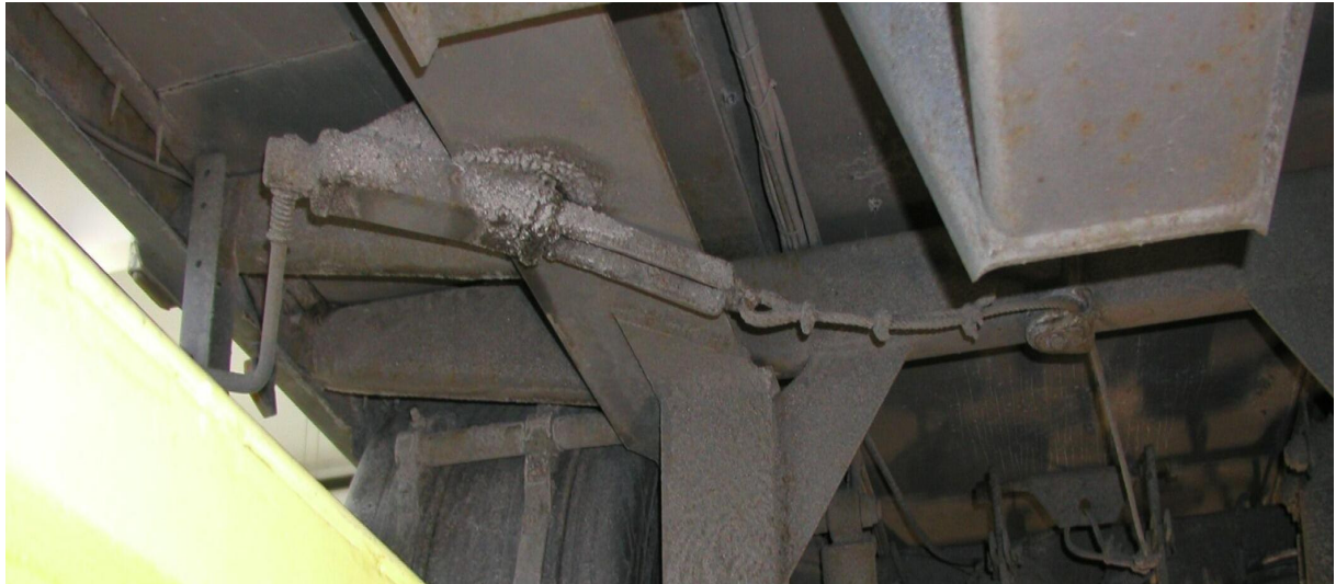
Slika 7.2 Mehanička polužno - vijčana parkirna kočnica
