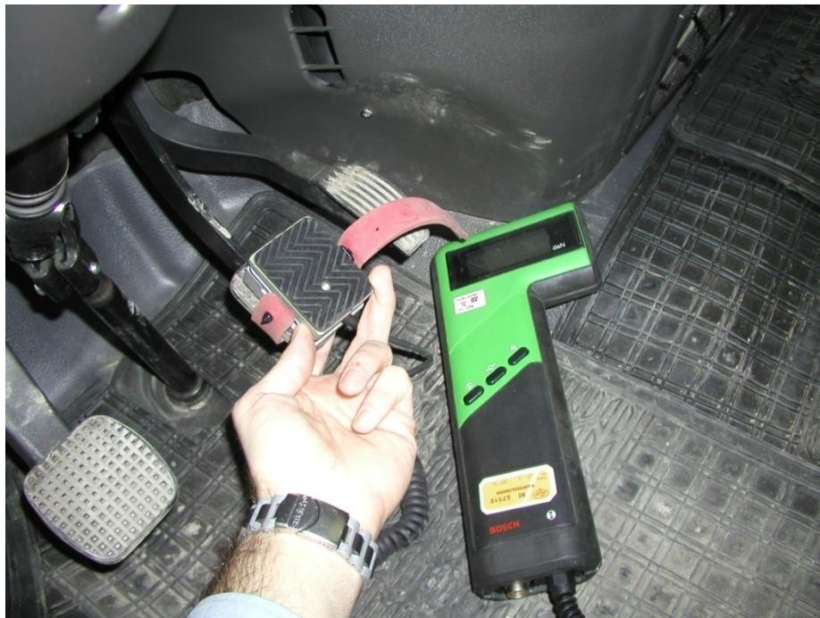
*Slika 10.13 Postavljanje dinamometra na papućicu kočnice*
