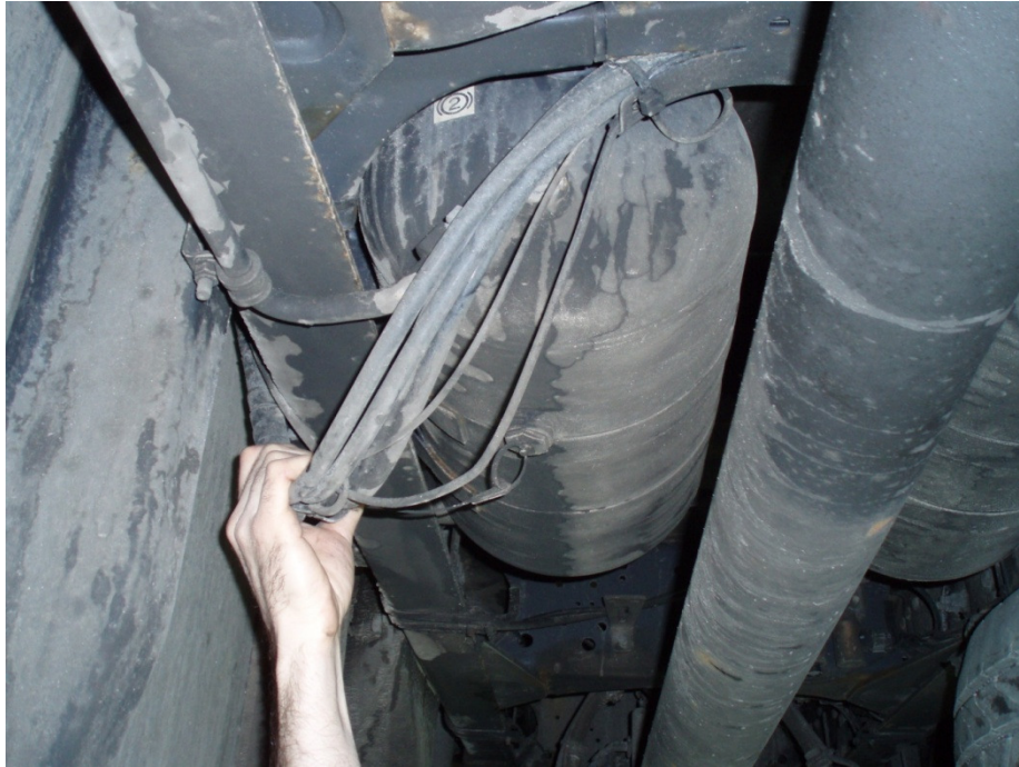
Slika 10.5 Provjera pričvršćenosti crijeva
