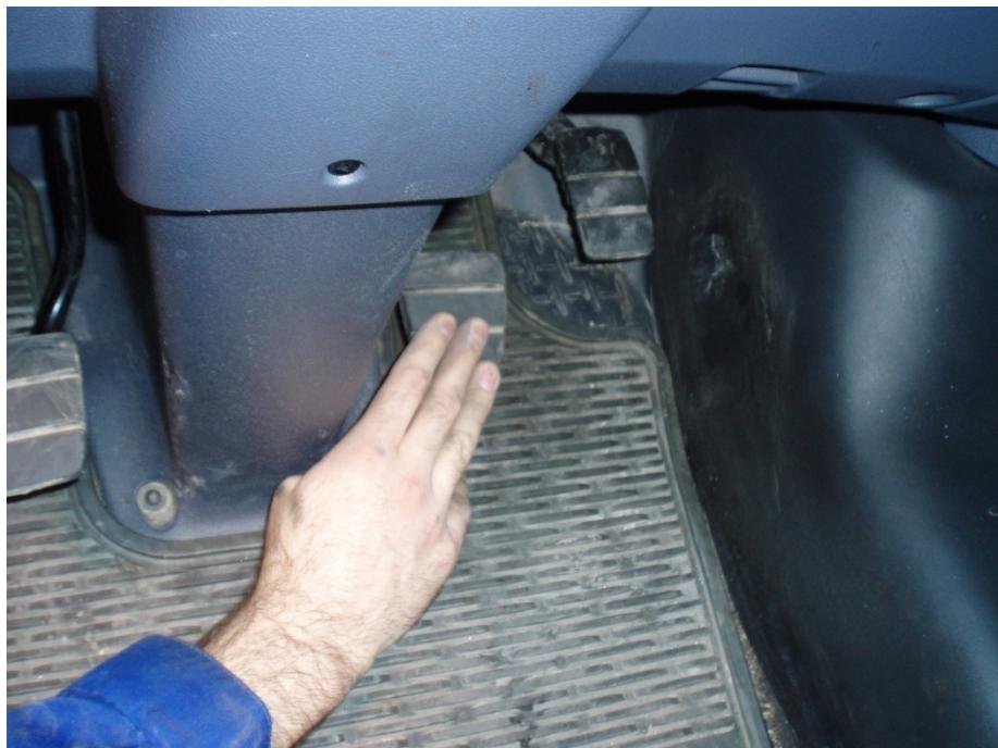
*Slika 10.16 Provjera hoda papučice glavnog kočnog ventila*
