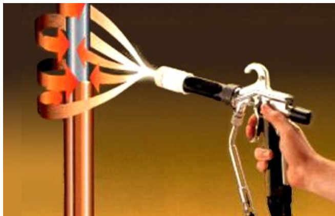
Slika 18. Način primanja boje na obradak
