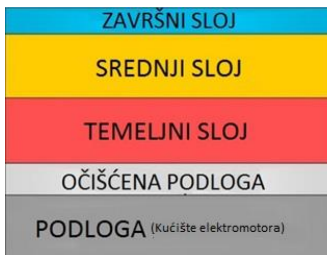
Slika 5. Slojevi boje na predmetu obrade
