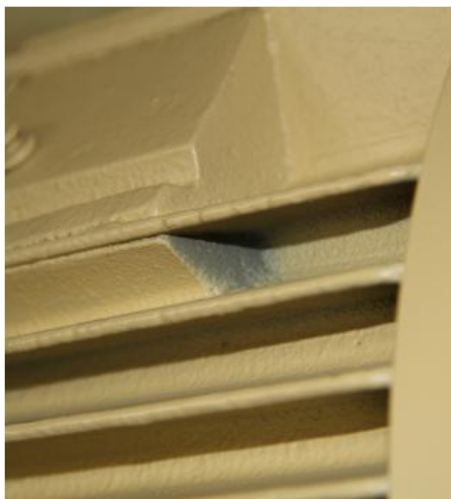
Slika 6. Neobojena mjesta na kućištu elektromotora
