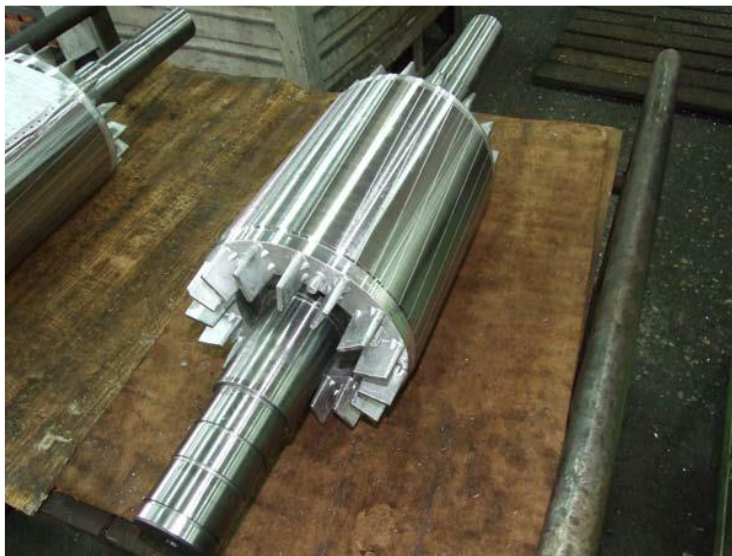
Slika 4. Sklop rotora i vratila
