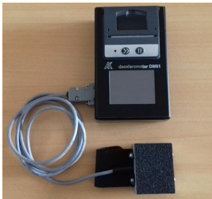
Slika 32. Uređaj DM01 s priključenim dinamometrom
