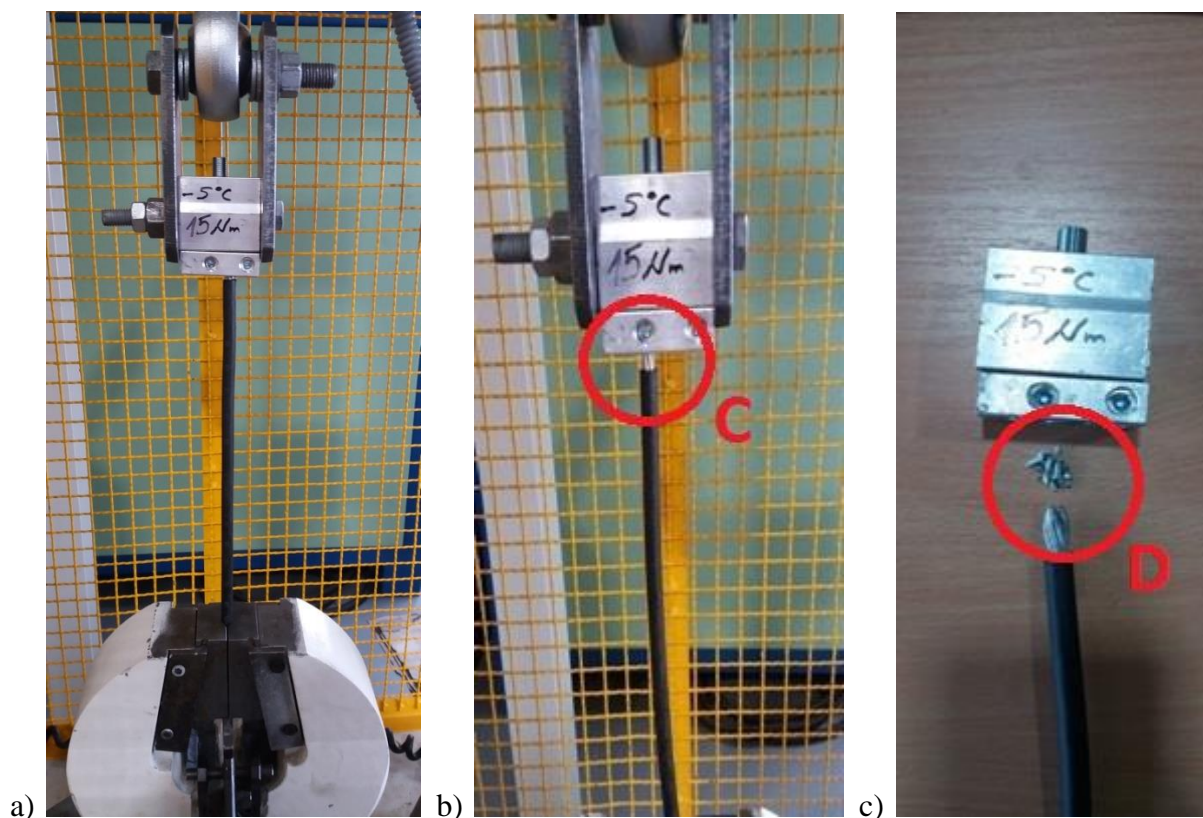
Slika 23. Ispitivanje uzorka na kidalici: a) uzorak prije ispitivanja, b) uzorak nakon ispitivanja, c) lom vodiča
