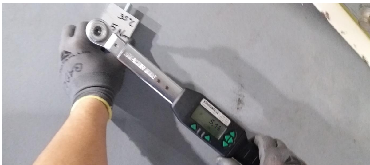
Slika 26. Pritezanje vijaka stezaljke moment ključem
