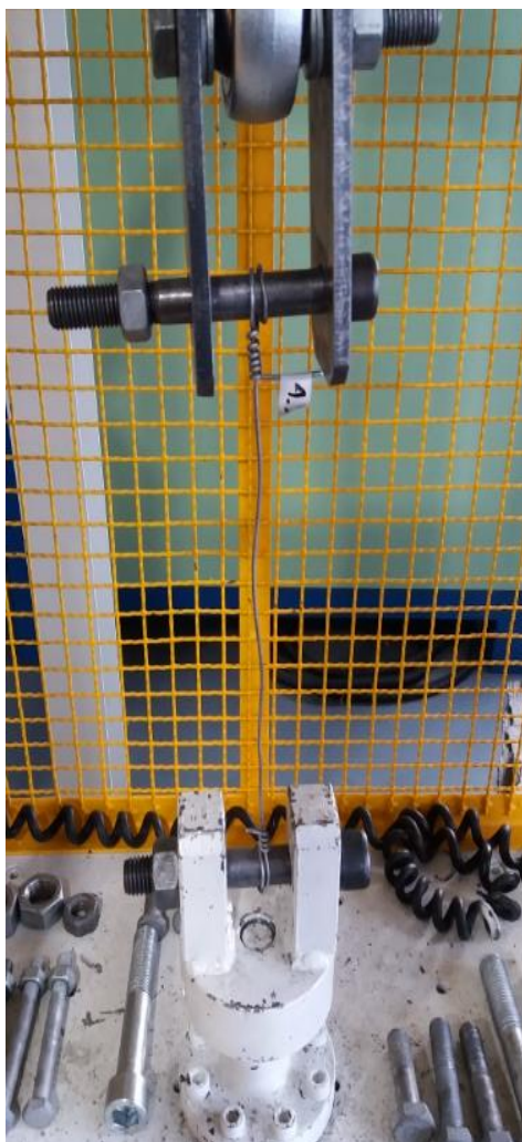
Slika 9. Ispitivanje na kidalici: a) uzorak prije ispitivanja, b) uzorak poslije ispitivanja
