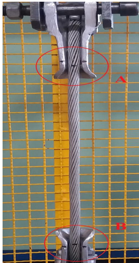
Slika 24. Ispitivanje na kidalici: a) prihvat uzorka na kidalici, b) izvlačenje vodiča iz stezaljke
