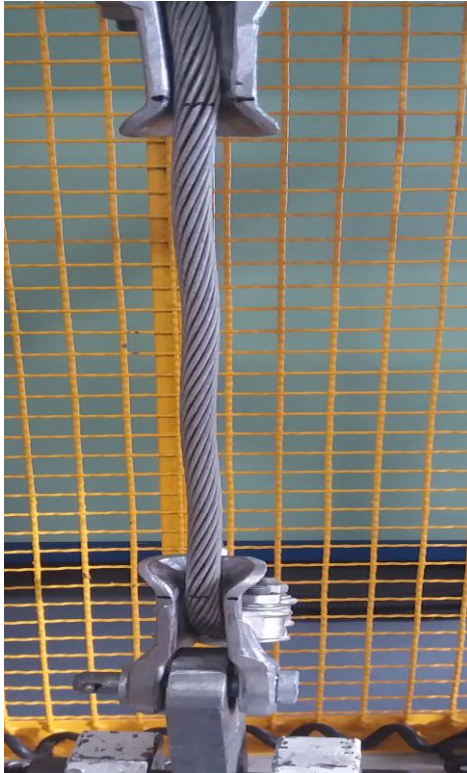
Slika 34. Ispitivanje na kidalici: a) uzorak prije ispitivanja, b) popuštanje vodiča na izlazu iz stezaljke
