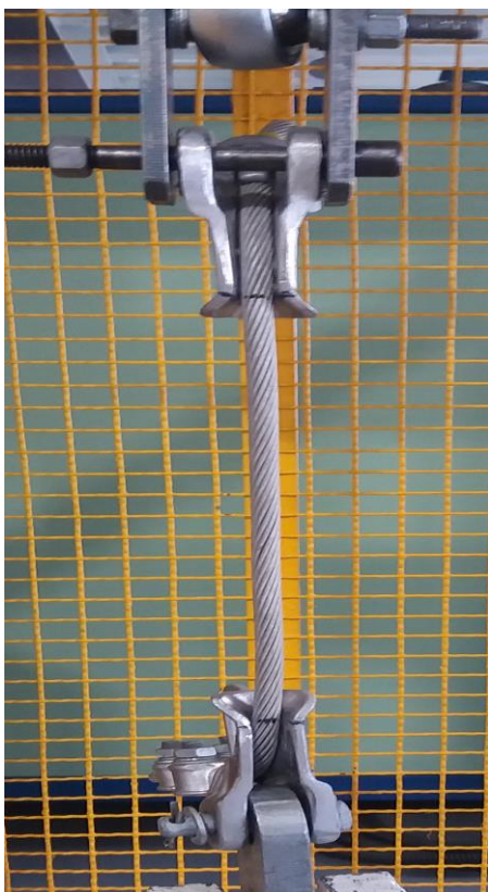
Slika 26. Ispitivanje na kidalici: a) uzorak prije ispitivanja, b) pucanje vodiča nakon ispitivanja
