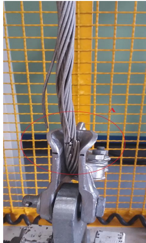
Slika 34. Ispitivanje na kidalici: a) uzorak prije ispitivanja, b) popuštanje vodiča na izlazu iz stezaljke
