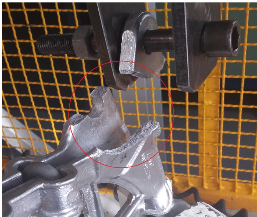
Slika 39. Lom stezaljke na mjestu svornjaka
