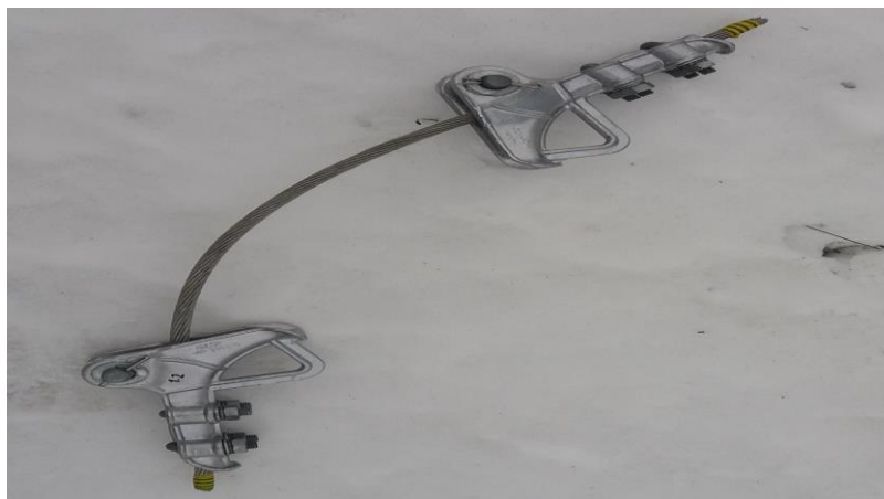
Slika 23. Uzorak za ispitivanje sile izvlačenja vodiča
