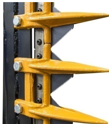
Slika 7. Način pričvršćivanja noževa
