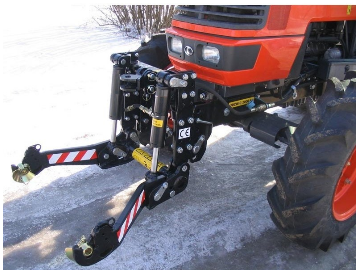
Slika 11. Prednji hidraulični podizač T200
