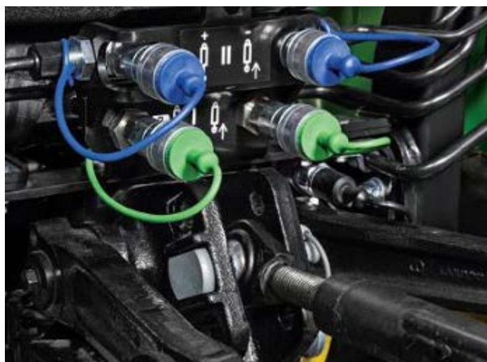
Slika 13. Hidraulični priključak (Dual rear SCVs)
