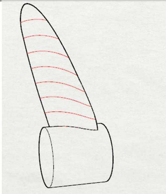
**Slika 21. Spojene točke ulaznog i izlaznog brida nagnutog profila koji je zalijepljen na cilindar**
