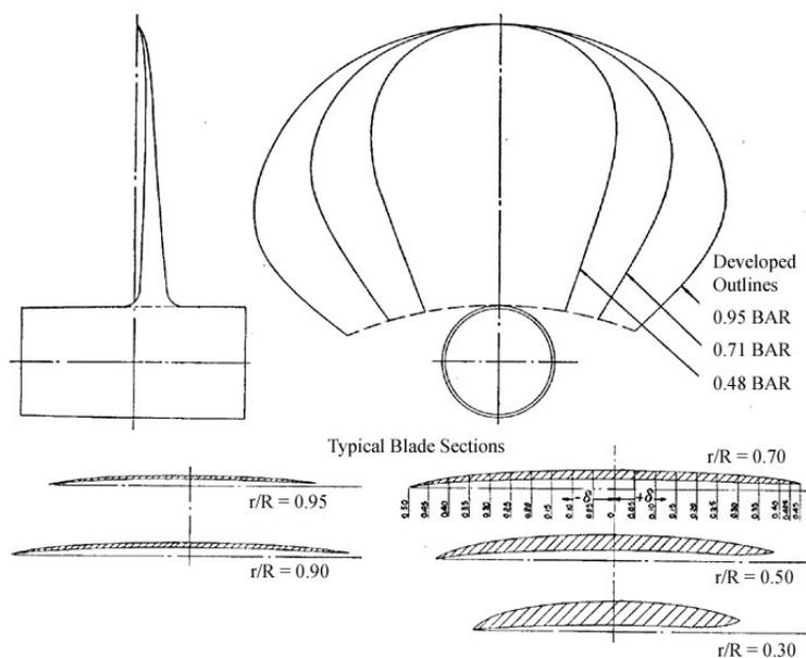
Slika 13. Oblik presjeka profila Newton-Rader serije vijaka
