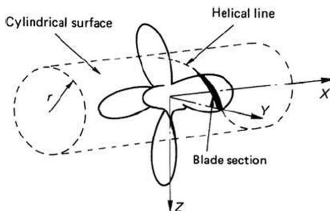
Slika 5. Presjek profila na radijusu  $r$  [3]
