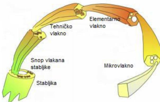
Slika 4.17. Shematski prikaz sastav vlakna industrijske konoplje od stabla pa sve do mikrovlakana [27]
