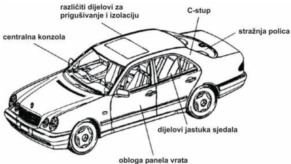
Slika 4.13. Upotreba lanenih vlakana u proizvodnji dijelova za automobil Mercedes-Benz E-Class [5]
