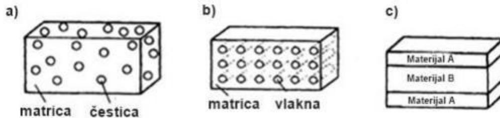
Slika 2.8. Podjela kompozita prema obliku ojačavala: a) kompozit ojačan česticama, b) kompozit ojačan vlaknima, c) strukturni kompoziti [9]
