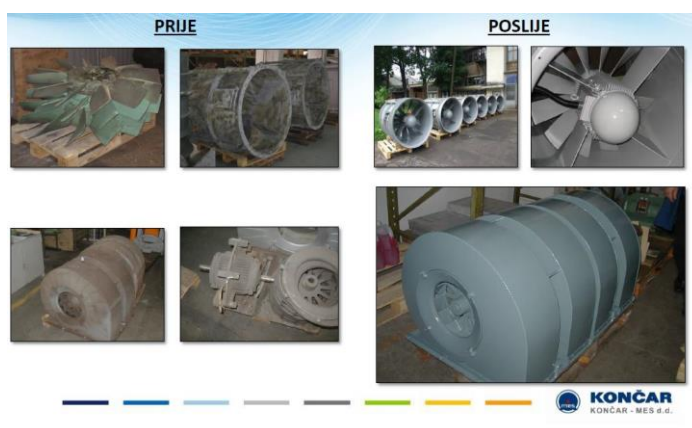
Slika 14. Stanje ventilatora prije i nakon servisa[20]
