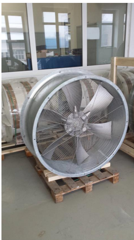
Slika 22. Montirani ventilator VAAZ C1000
