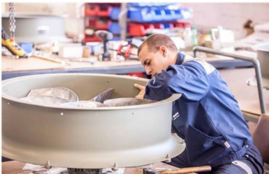
Slika 24. Ručna motaža ventilatora VAAZ C1000 WF [20]
