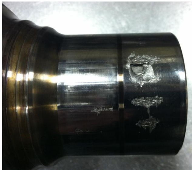
Slika 22. Oštećenje zbog prevelikog operativnog kuta među vratilima [17]
