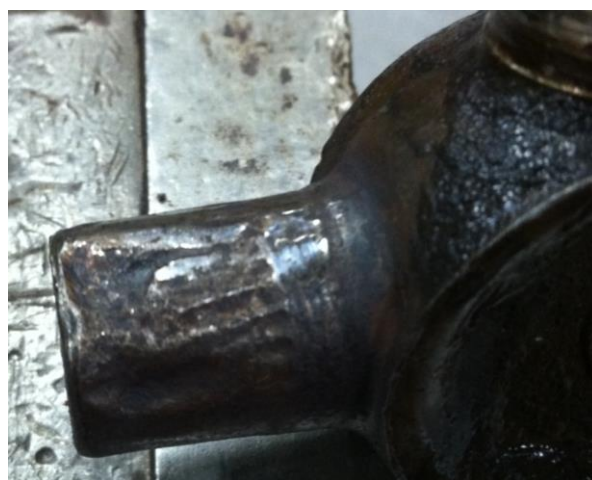
Slika 20. Oštećenje uslijed nedostatka maziva [17]
