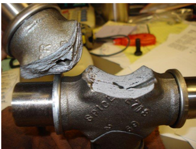
Slika 19. Lom uslijed preopterećenja [17]
