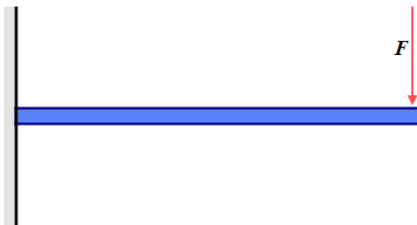
Slika 21. Konzola opterećena silom na kraju
