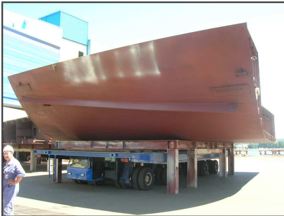
Slika 15. Cestovni parterni transporter "Cometto"
