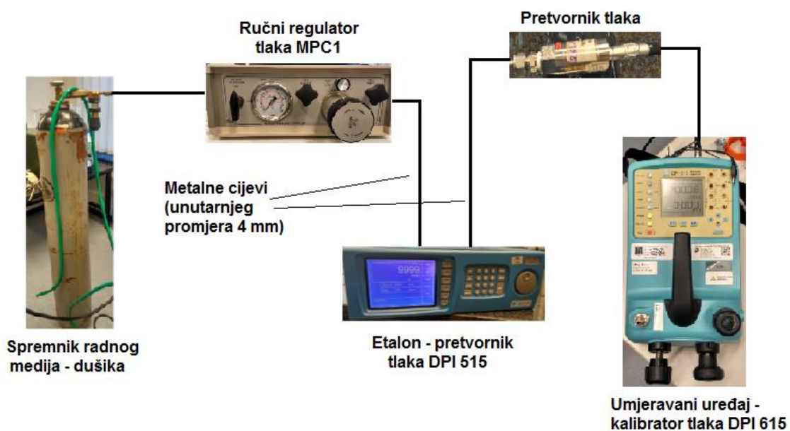
Slika 6.4 Shema linije za umjeravanje kalibratora tlaka DPI 615
