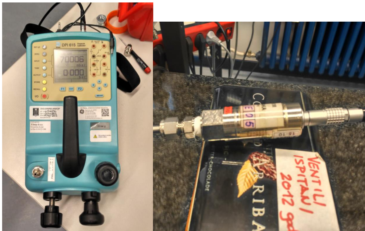
Slika 12. Pokazivač DPI 615 sa pretvornikom tlaka
