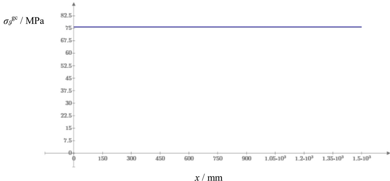
Slika 19 Raspodjela meridijalnog naprezanja za gornji dio cilindrične ljske
