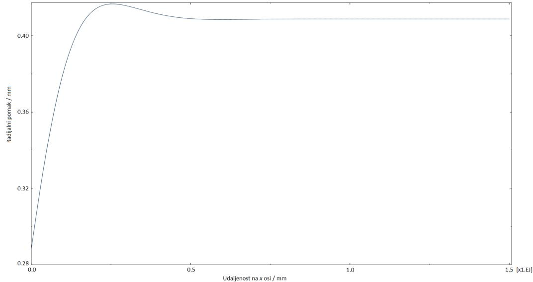
**Slika 58 Raspodjela radijalnog pomaka za donji dio cilindrične lјuske**
