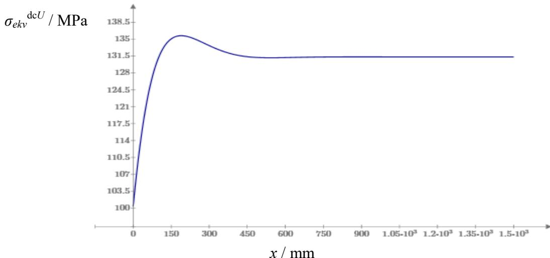
**Slika 30 Raspodjela ekvivalentnog naprezanja duž unutrašnjeg ruba donjeg dijela cilindrične lјuske**
