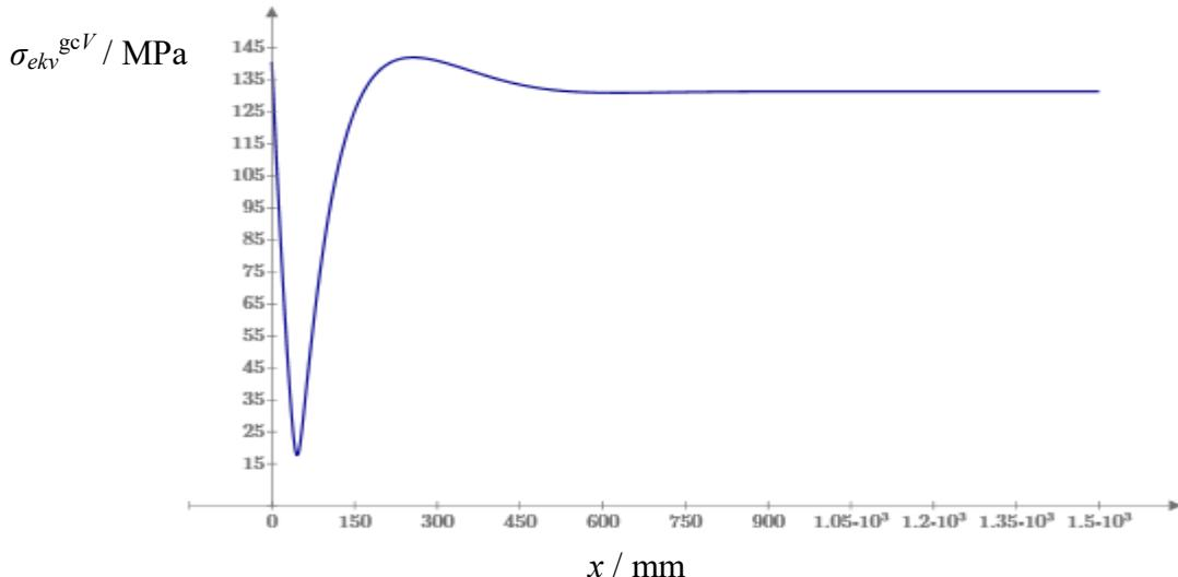
**Slika 31 Raspodjela ekvivalentnog naprezanja duž vanjskog ruba gornjeg dijela cilindrične lјuske**
