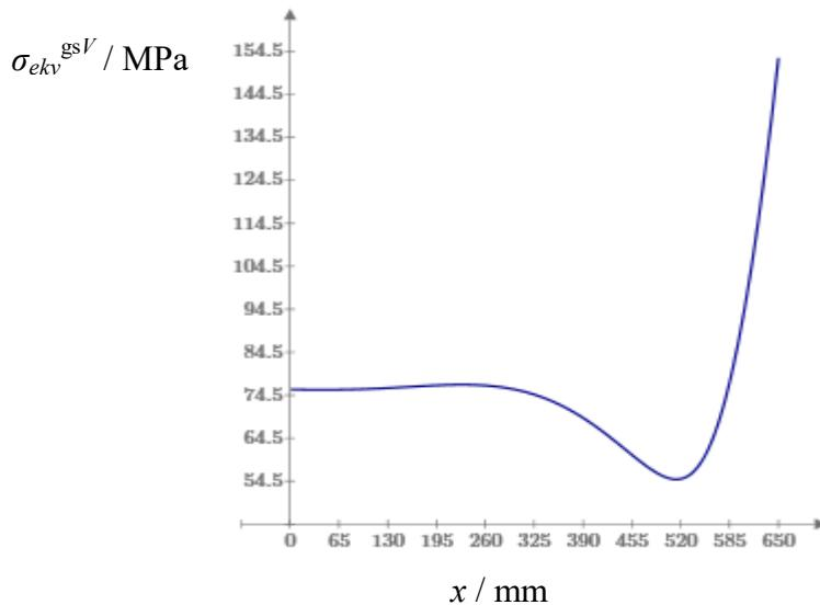
**Slika 33 Raspodjela ekvivalentnog naprezanja duž vanjskog ruba gornje sferne ljske**
