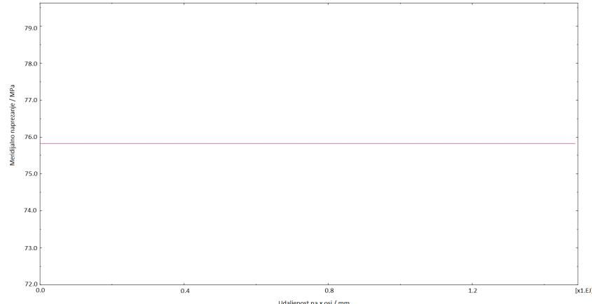
**Slika 60 Raspodjela meridijalnog naprezanja za donji dio cilindrične ljske**
