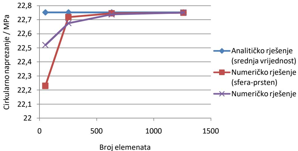
**Slika 68 Konvergencija cirkularnog naprezanja na spoju ljsaka sa prstenom**
