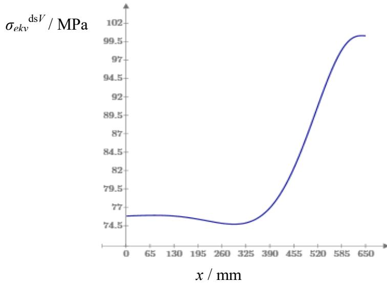
**Slika 27 Raspodjela ekvivalentnog naprezanja duž vanjskog ruba donje sferne ljsuske**
