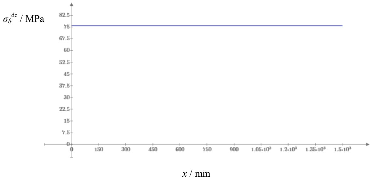
Slika 15 Raspodjela meridijalnog naprezanja za donji dio cilindrične lјuske
