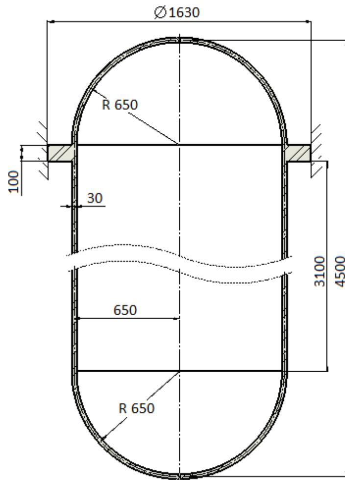
**Slika 2** Vertikalni spremnik
