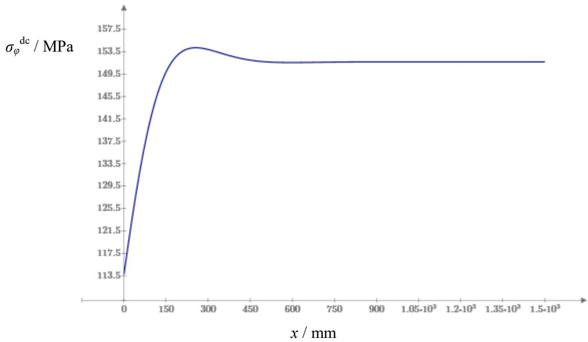
Slika 14 Raspodjela cirkularnog naprezanja za donji dio cilindrične lјuske
