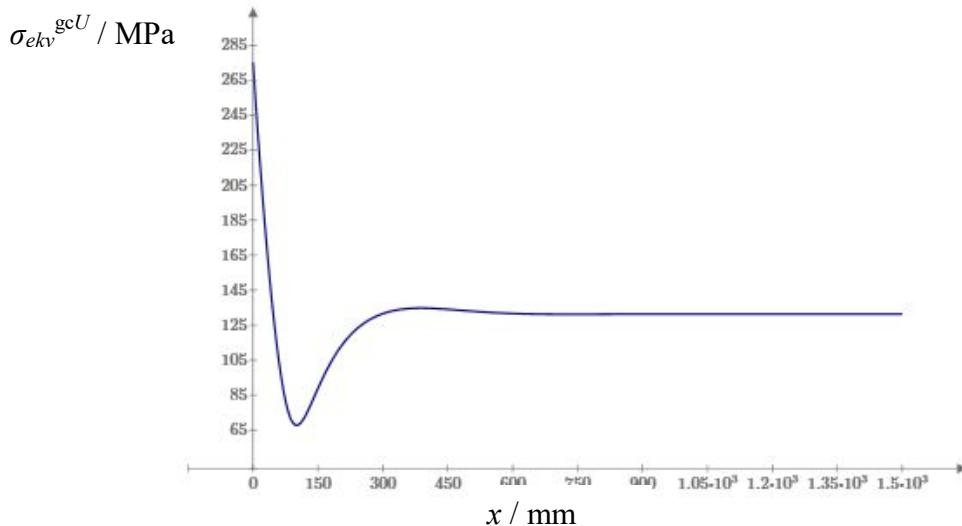
**Slika 32 Raspodjela ekvivalentnog naprezanja duž unutrašnjeg ruba gornjeg dijela cilindrične ljske**
