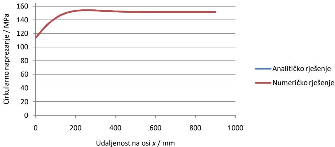
**Slika 62 Usporedba vrijednosti cirkularnih naprezanja na donjem dijelu cilindrične ljske**
