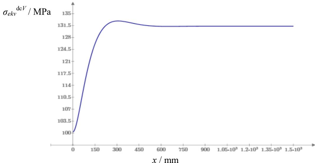
**Slika 29 Raspodjela ekvivalentnog naprezanja duž vanjskog ruba donjeg dijela cilindrične ljske**
