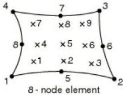
**Slika 36 Osnosimetrični pravokutni element drugog reda [5]**
