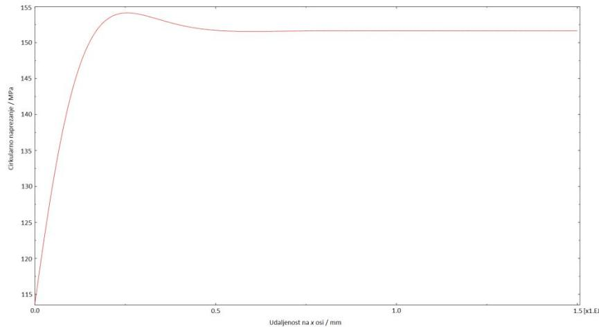
**Slika 59 Raspodjela cirkularnog naprezanja za donji dio cilindrične ljske**
