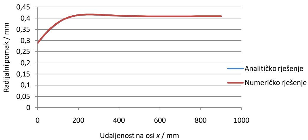
**Slika 63 Usporedba vrijednosti radijalnih pomaka na donjem dijelu cilindrične ljske**
