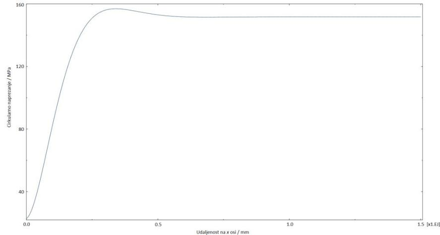
**Slika 71 Raspodjela cirkularnog naprezanja za gornji dio cilindrične ljske**
