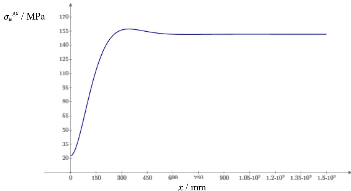
Slika 18 Raspodjela cirkularnog naprezanja za gornji dio cilindrične ljske
