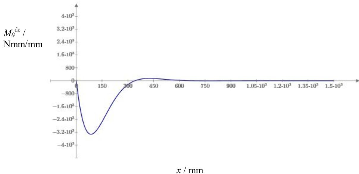
Slika 16 Raspodjela meridijalnog momenta za donji dio cilindrične lјuske
