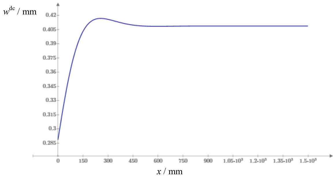
Slika 13 Raspodjela radijalnog pomaka za donji dio cilindrične lјuske
