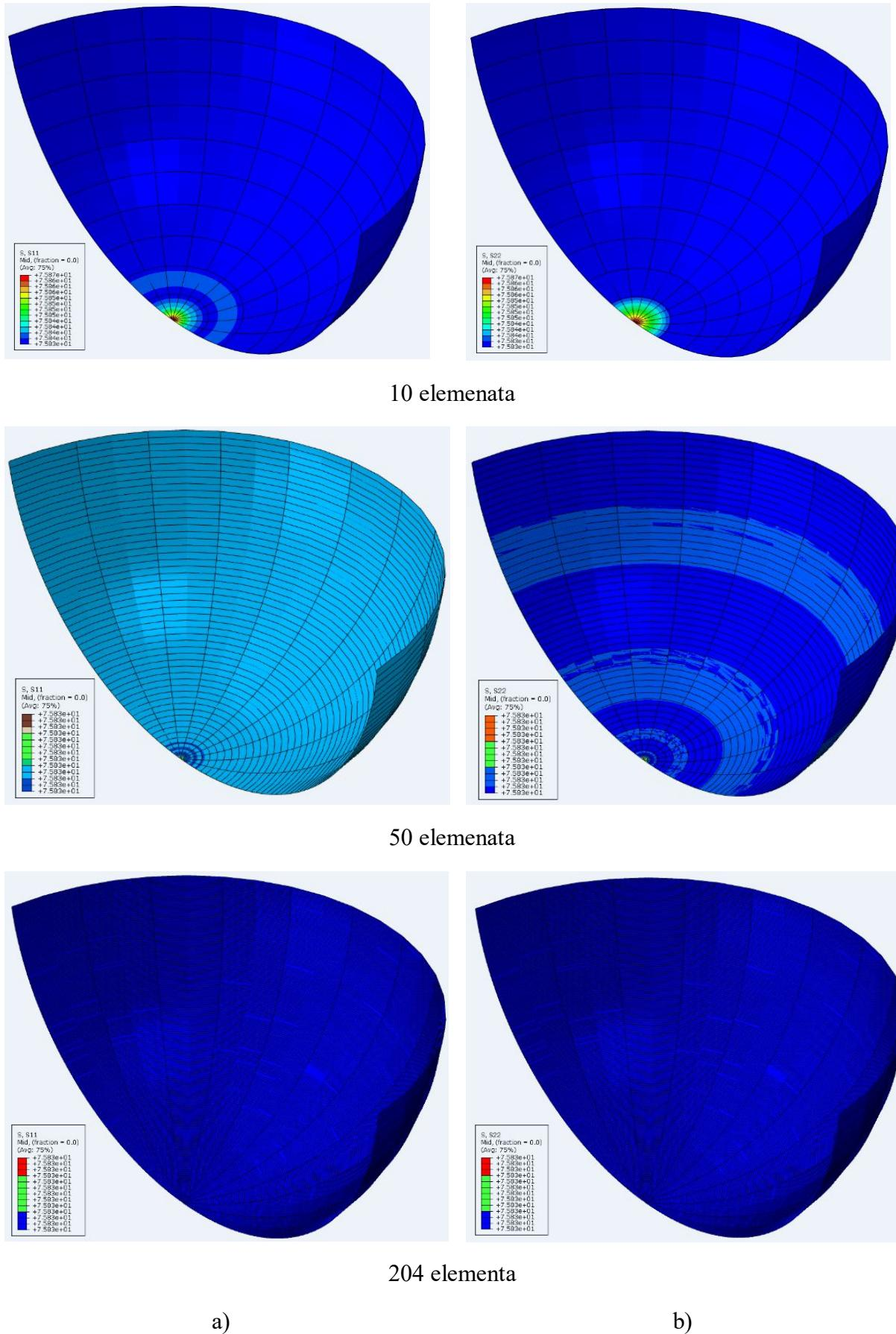
Slika 50 Raspodjela naprezanja: a) merdijalna, b) cirkularna
