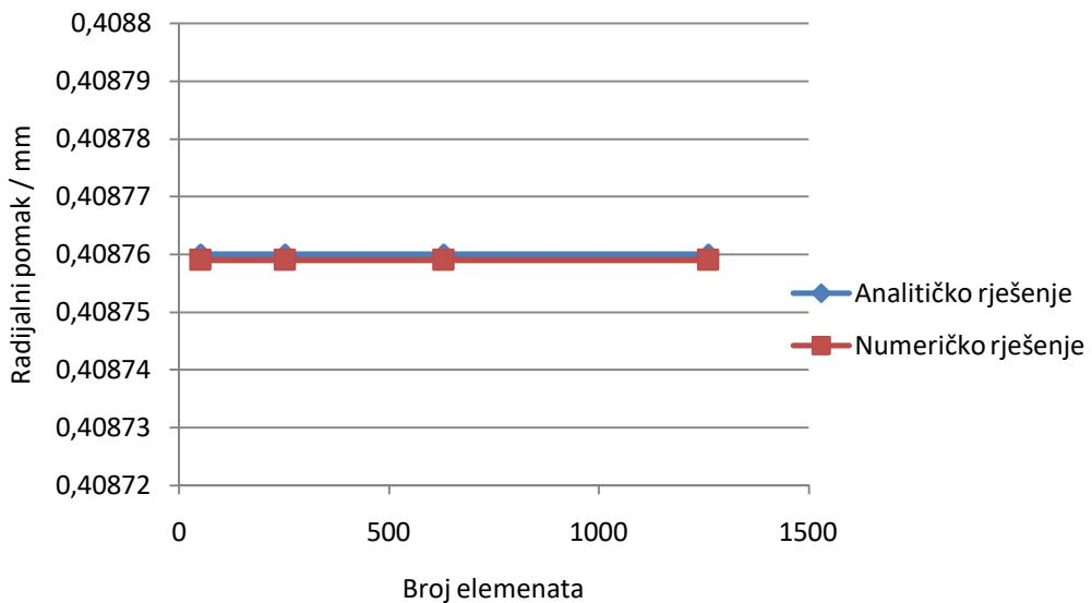
**Slika 69 Konvergencija radijalnog pomaka na spoju ljsaka sa prstenom**
