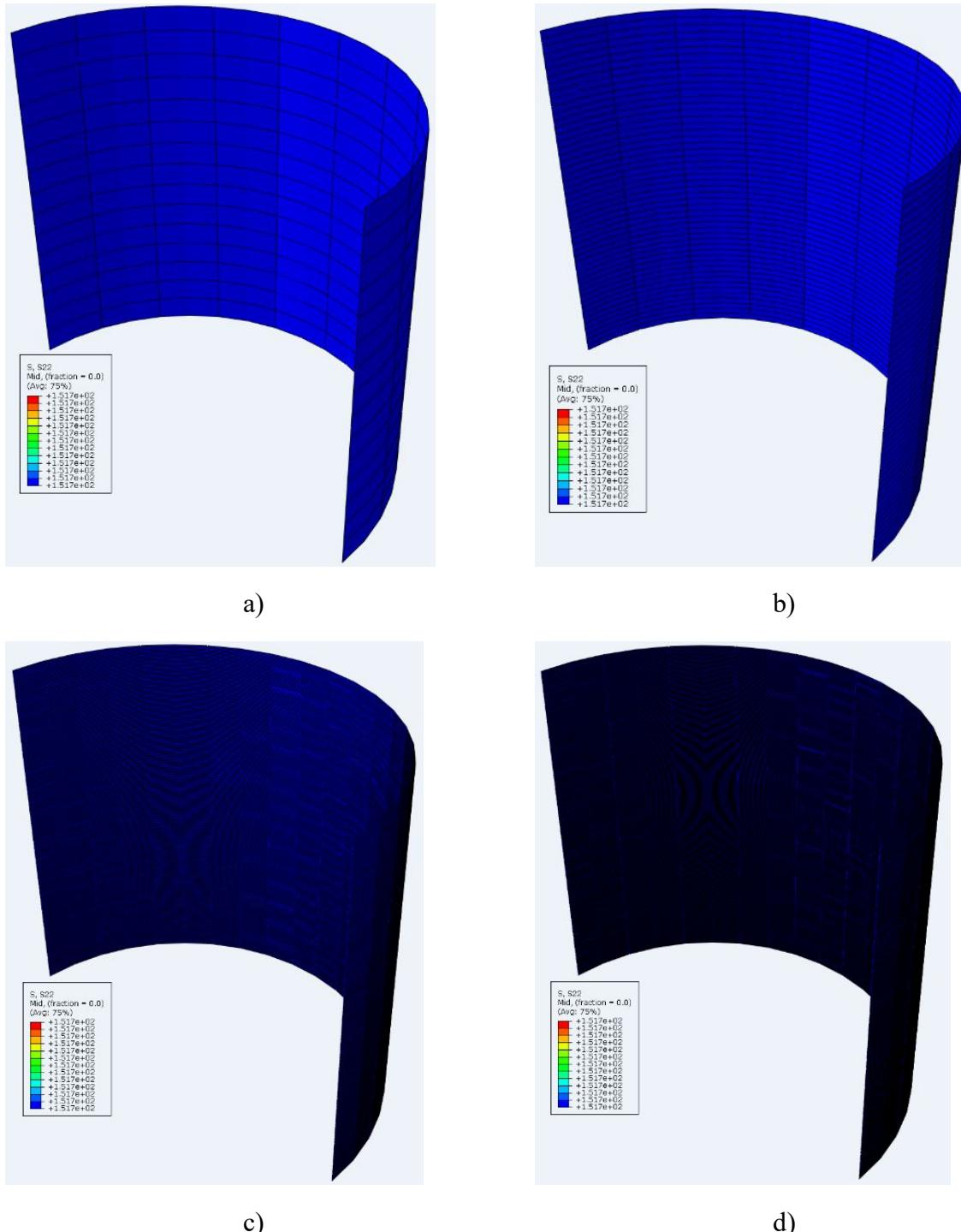
**Slika 46 Raspodjela cirkularnih naprezanja po SAX2 elementima u MPa: a) model s 15 elemenata, b) model s 50 elemenata, c) model s 300 elemenata, d) model s 500 elemenata**
