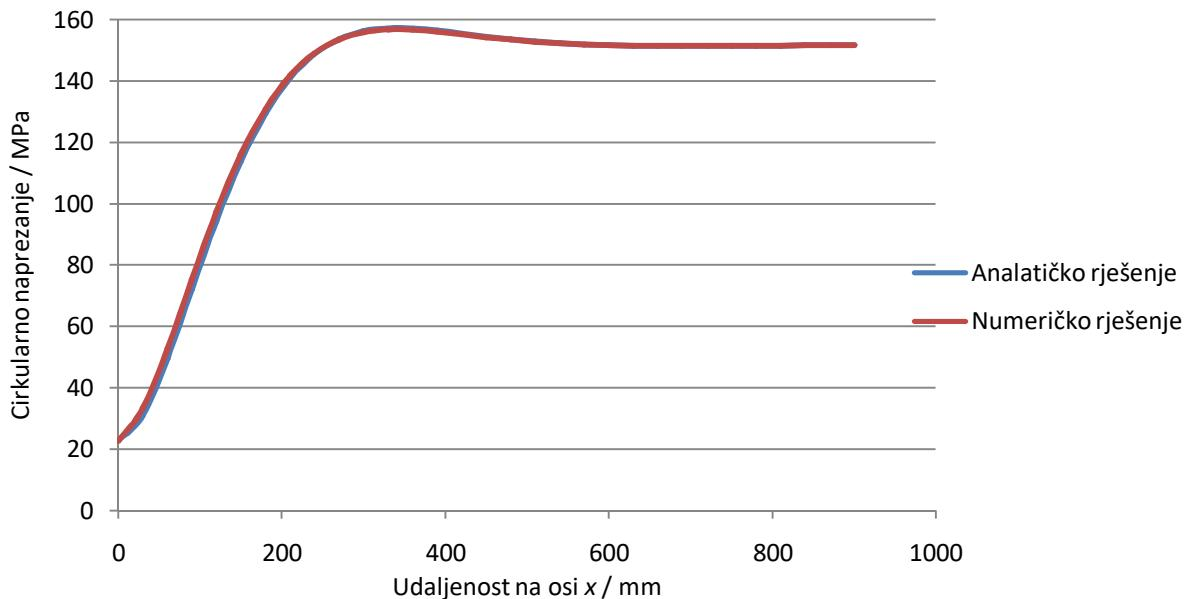
Slika 78 Usporedba vrijednosti cirkularnih naprezanja na gornjem dijelu cilindrične ljske
