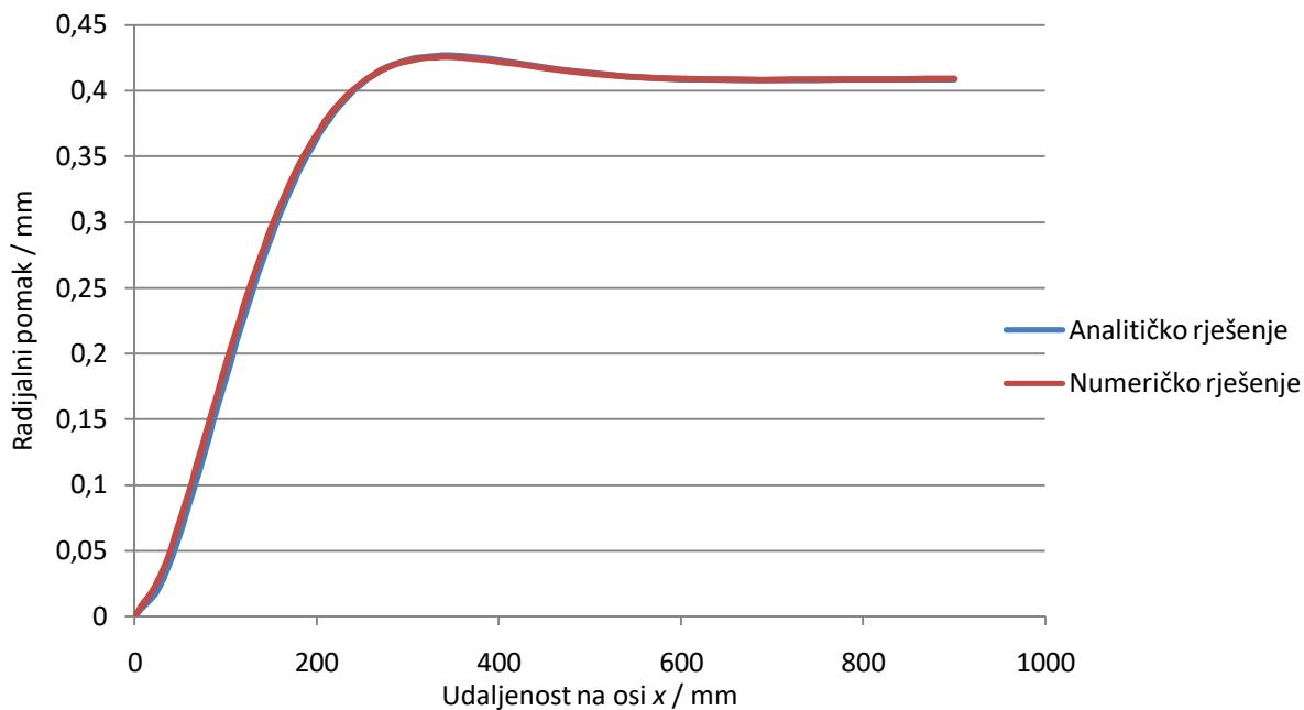
Slika 79 Usporedba vrijednosti radijalnih pomaka na gornjem dijelu cilindrične ljske
