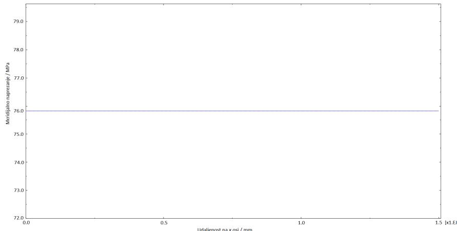
**Slika 72 Raspodjela meridijalnog naprezanja za gornji dio cilindrične ljske**
