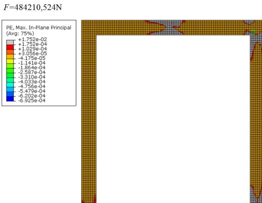
Slika 54. Raspodjela plastičnih deformacija u slučaju opterećenja F=484210,5247\text{ N}
