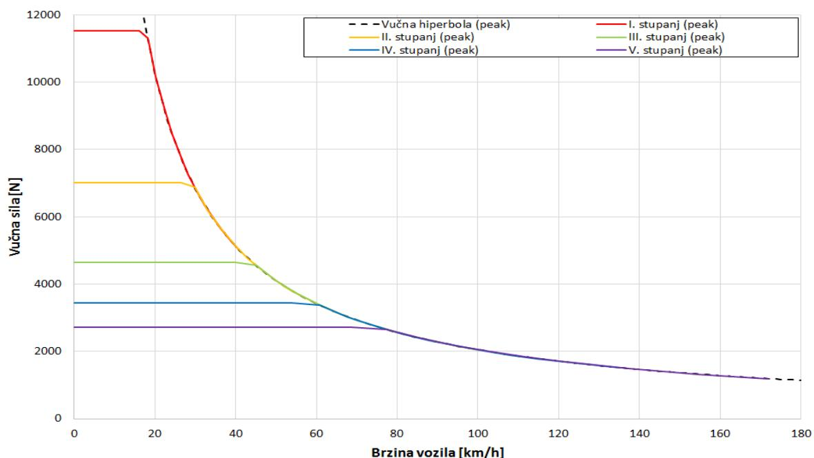
Slika 4.5. Dijagram vučnih sila elektromotora pri vršnoj snazi
