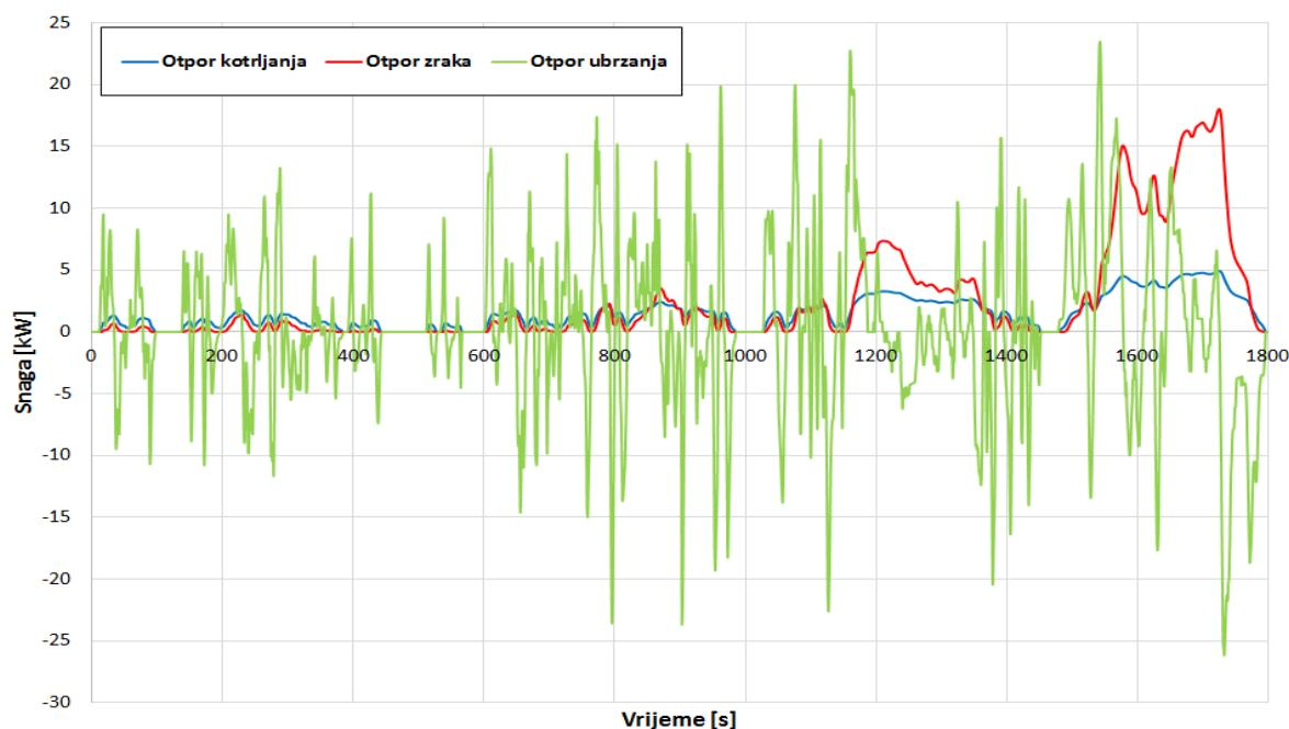
**Slika 2.4. Snage potrebne za savladavanje pojedinih otpora vožnje**
