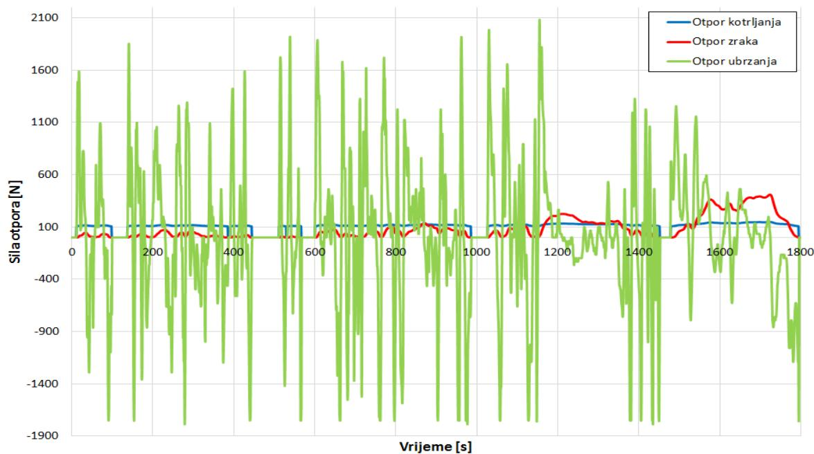
**Slika 4.1. Sile pojedinih otpora vožnje električnog vozila**
