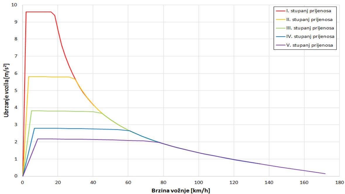
Slika 4.7. Dijagram ubrzanja u pojedinom stupnju prijenosa
