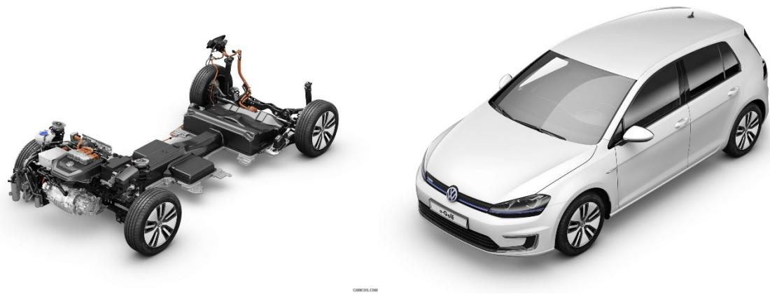
Slika 1.4. Prikaz komponenti električnog sustava (lijevo) i izgled karoserije (desno) [13]
