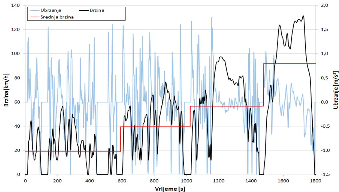
Slika 2.1. WLTC Class 3, brzina i ubrzanje
