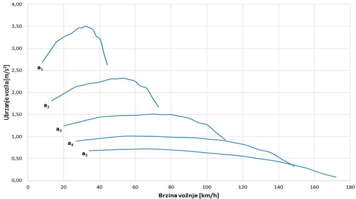
Slika 2.7. Dijagram ubrzanja u pojedinom stupnju prijenosa
