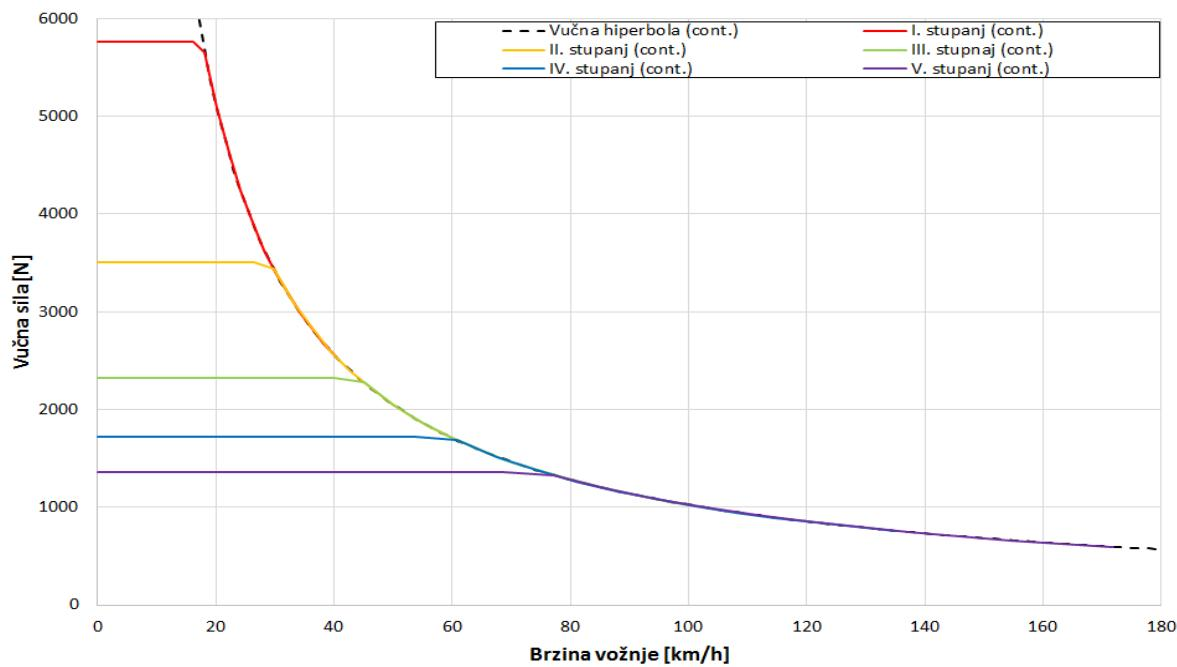
**Slika 4.4. Dijagram vučnih sila elektromotora pri nazivnoj snazi**
