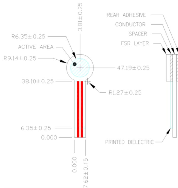
Slika 19. Dimenziije senzora FSR402
