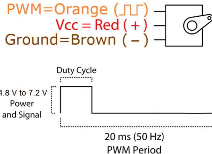
**Slika 13. Signal servo motora**
