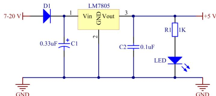
**Slika 14. Stabilizator napona**
