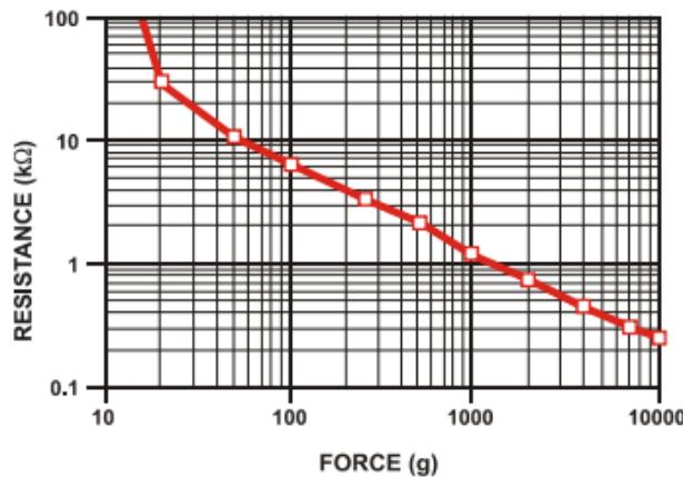
Slika 17. Ovisnost otpora o sili FSR senzora
