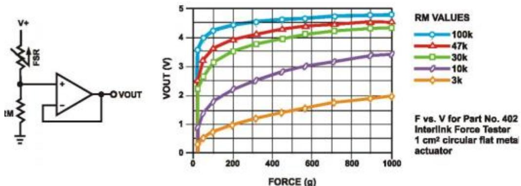
Slika 18. Ovisnost napona o sili FSR senzora
