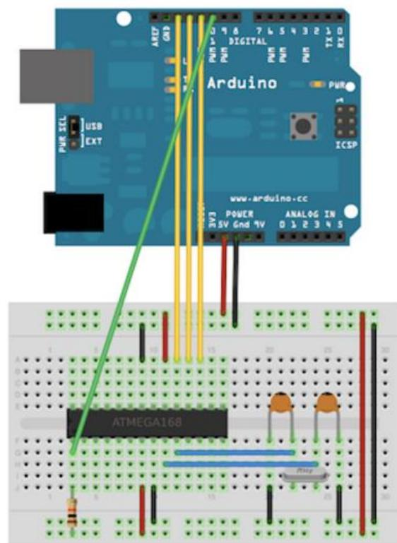
**Slika 9. Način spajanja mikrokontrolera za učitavanje osnovnog programa [4]**
