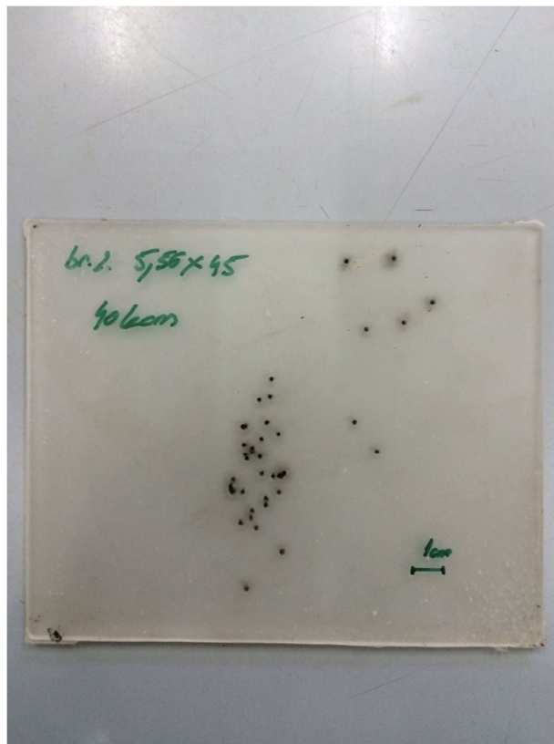
Slika 3.6.5 Ploča 5 prostrijeljena je s 40 hitaca iz puške, zrnom 5,56x45 mm.
