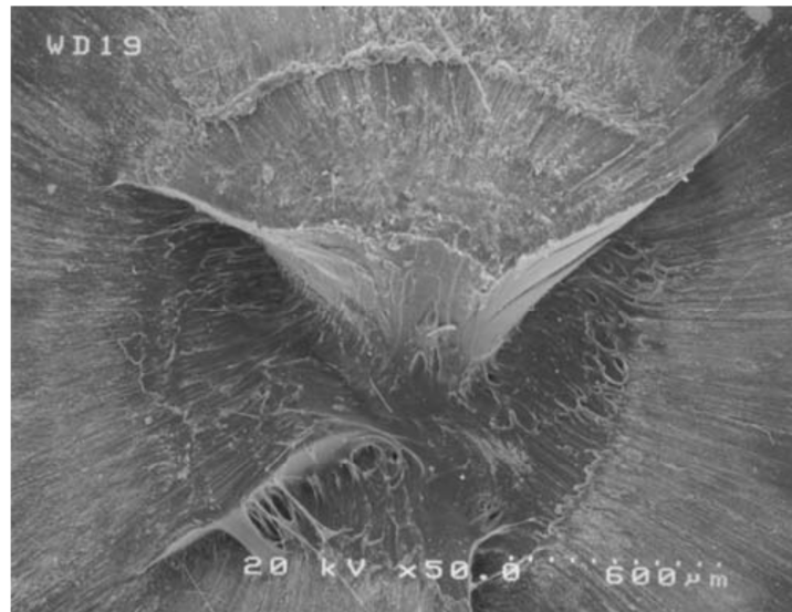
Slika 2.4.4.2 Izgled zatvorenog područja dobivena SEM-om nakon propucavanja kalibrom 4.5 mm [1]
