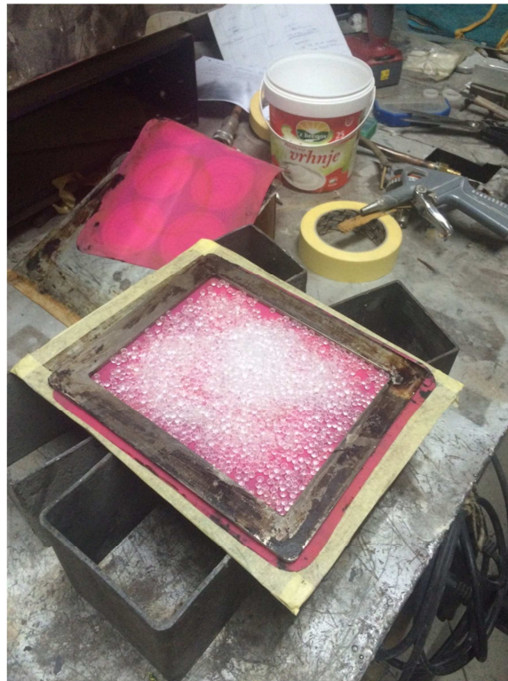
Slika 3.3.3 Postavljanje granulata u kalup
