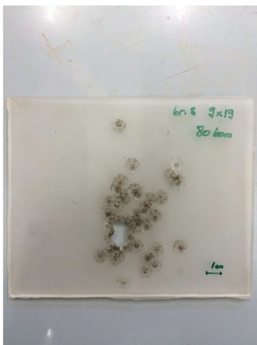
Slika 3.6.3 Ploča 3 prostrijeljena je s 80 hitaca pištoljem, zrnem 9x19 mm.
