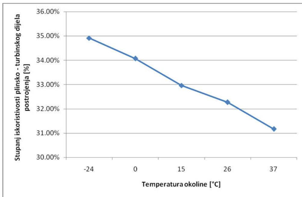
Slika 16. Ovisnost stupnja iskoristivosti plinsko - turbinskog dijela postrojenja o temperaturi okoline
