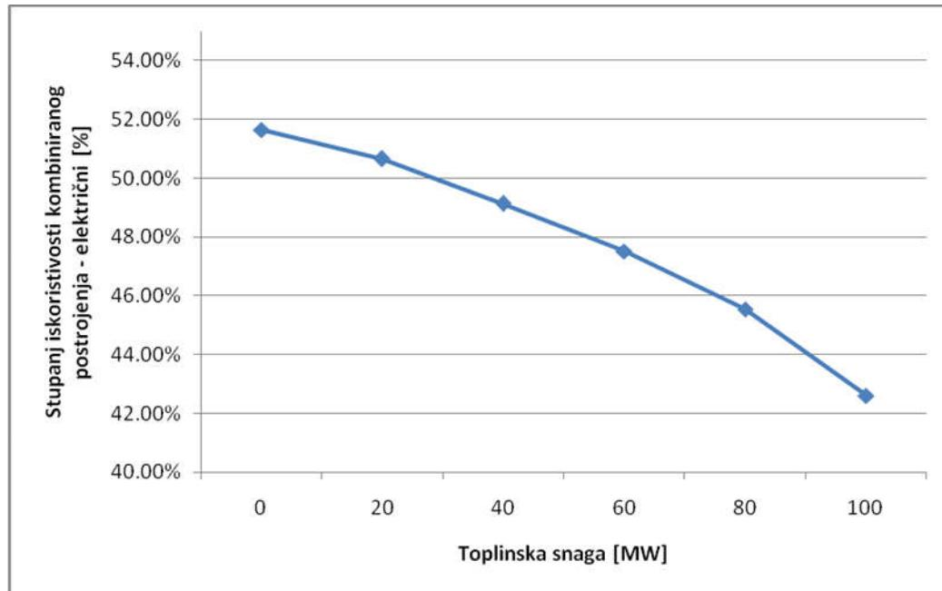
Slika 23. Ovisnost električnog stupnja iskoristivosti kombiniranog postrojenja o potrebojnoj toplinskoj snazi
