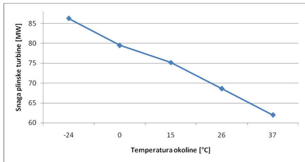
Slika 12. Ovisnost snage plinske turbine o temperaturi okoline
