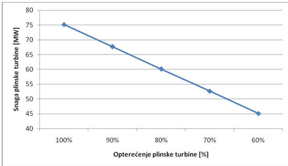
**Slika 25.** Prikaz snage plinske turbine za različita opterećenja
