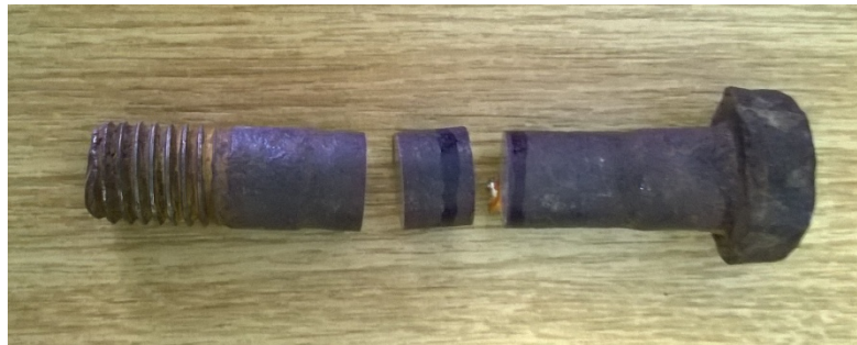
Slika 42. Odrezani uzorak vijka za metalografsku analizu
