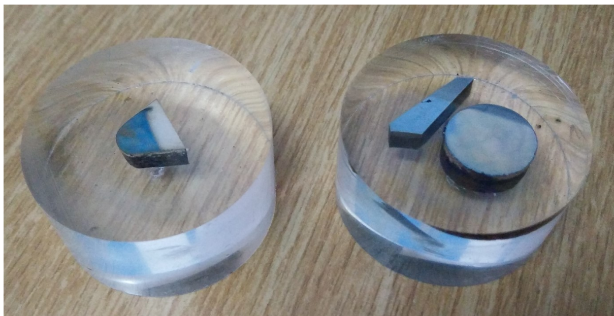
Slika 14. Polirani uzorci u polimernom kalupu
