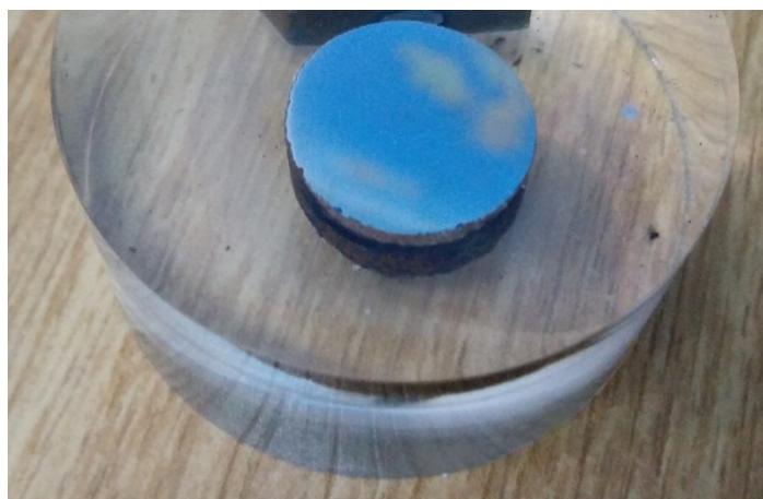
Slika 43. Uzorak vijka u polimernom kalupu
