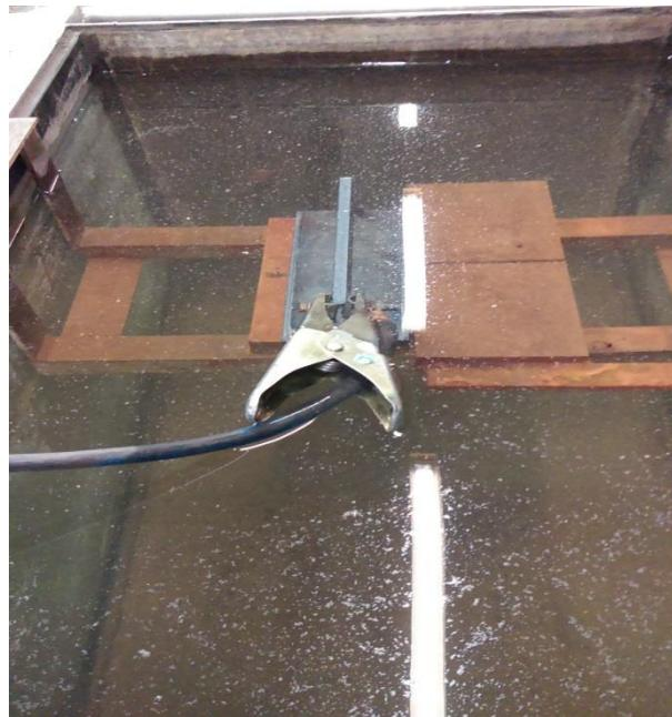
Slika 24. Kutni spoj pripremljen za zavarivanje
