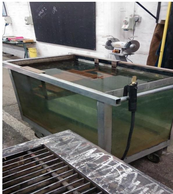
Slika 20. Bazen za podvodno zavarivanje
