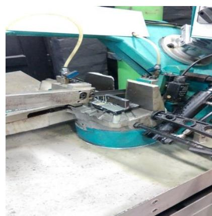
Slika 30. Rezanje makroizbruska tračnom pilom
