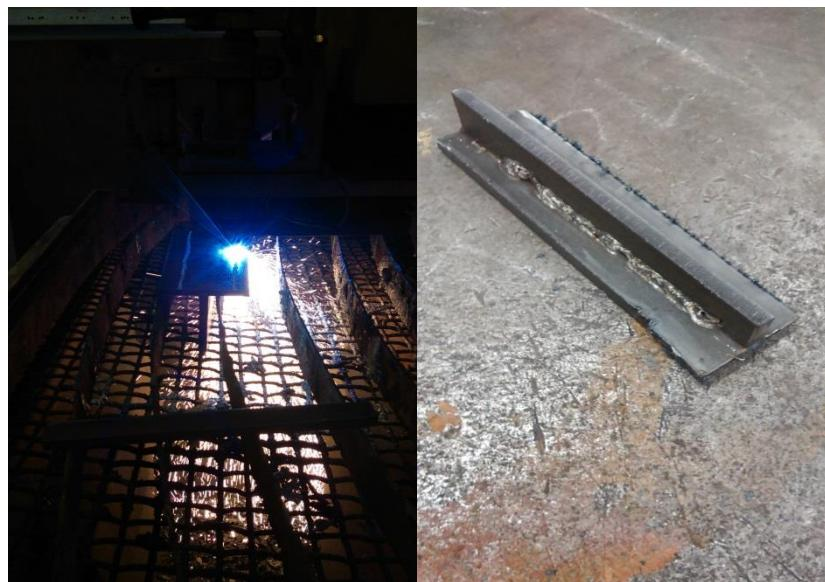
Slika 29. Rezanje viška dijelova ploča kutnog spoja
