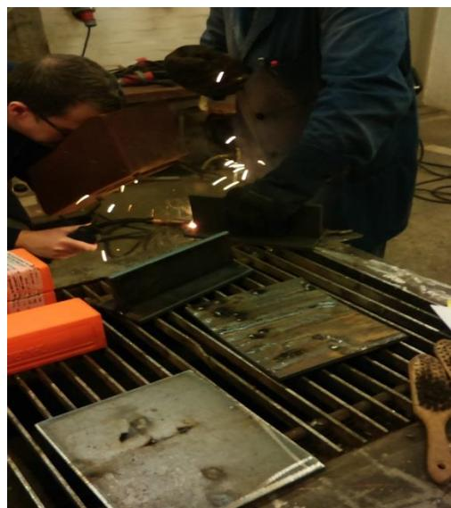
Slika 22. Zavarivanje pripoja MAG postupkom
