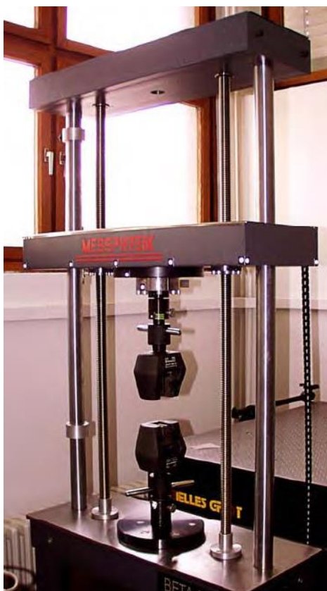
Slika 13. Statička kidalica Messphysik Beta 50-5
