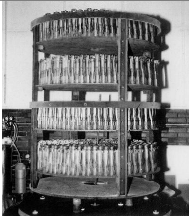
Slika 20 Šaržiranje pri velikoserijskoj proizvodnji [21]
